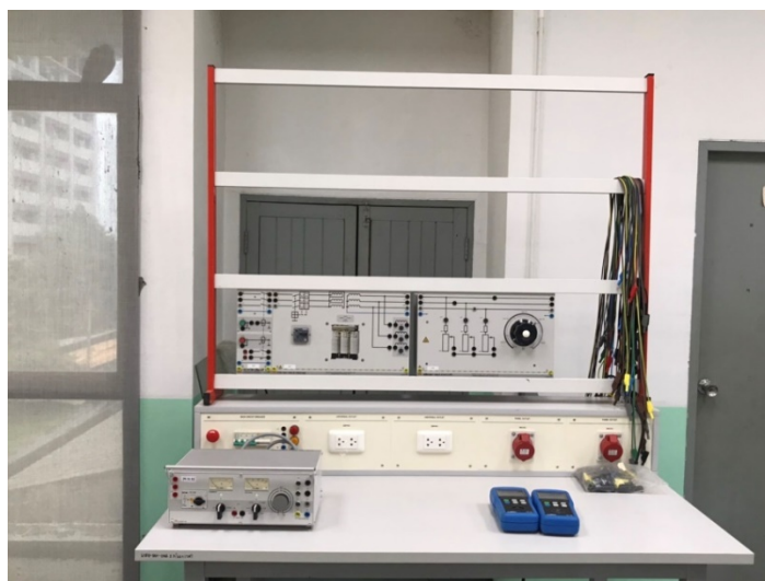
รูปที่ 23 ชุดการทดลองหม้อแปลงไฟฟ้า 3 เฟส
