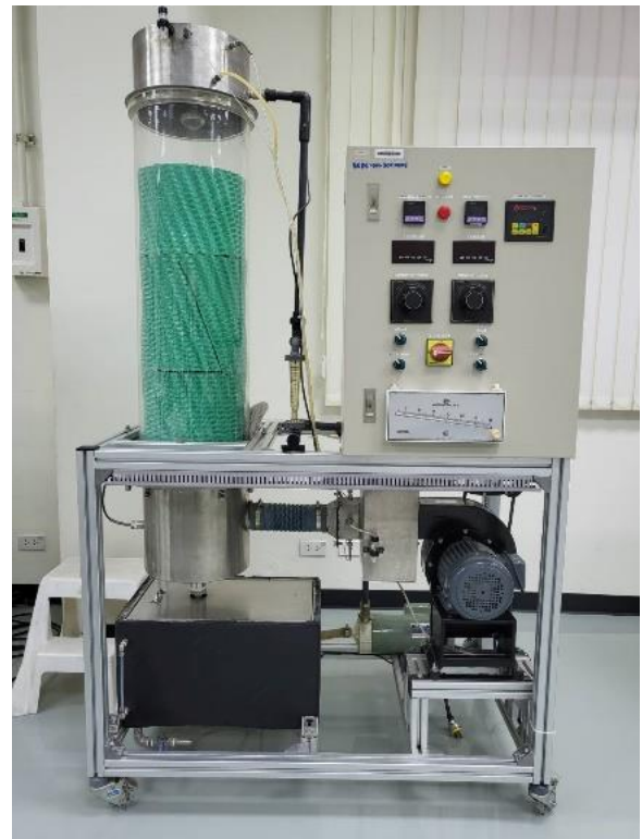
หอทำความเย็น (Cooling tower)
