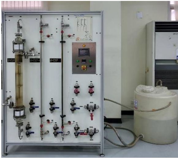
เครื่องแลกเปลี่ยนความร้อน (Heat exchanger) (Shell & Tube and Double pipe)
