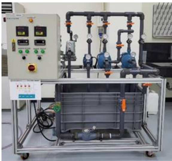
อุปกรณ์ศึกษาเกี่ยวกับเครื่องสูบน้ำ (Pump)
