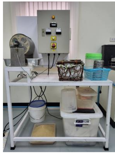
อุปกรณ์ศึกษาการลดขนาด (Size reduction) (Ball mill and molecular sieves)
