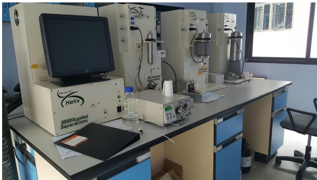
รูปที่ 5 Supercritical fluid extractor สำหรับรายวิชาโครงการงานวิศวกรรมเคมีและเคมีเภสัชกรรม
