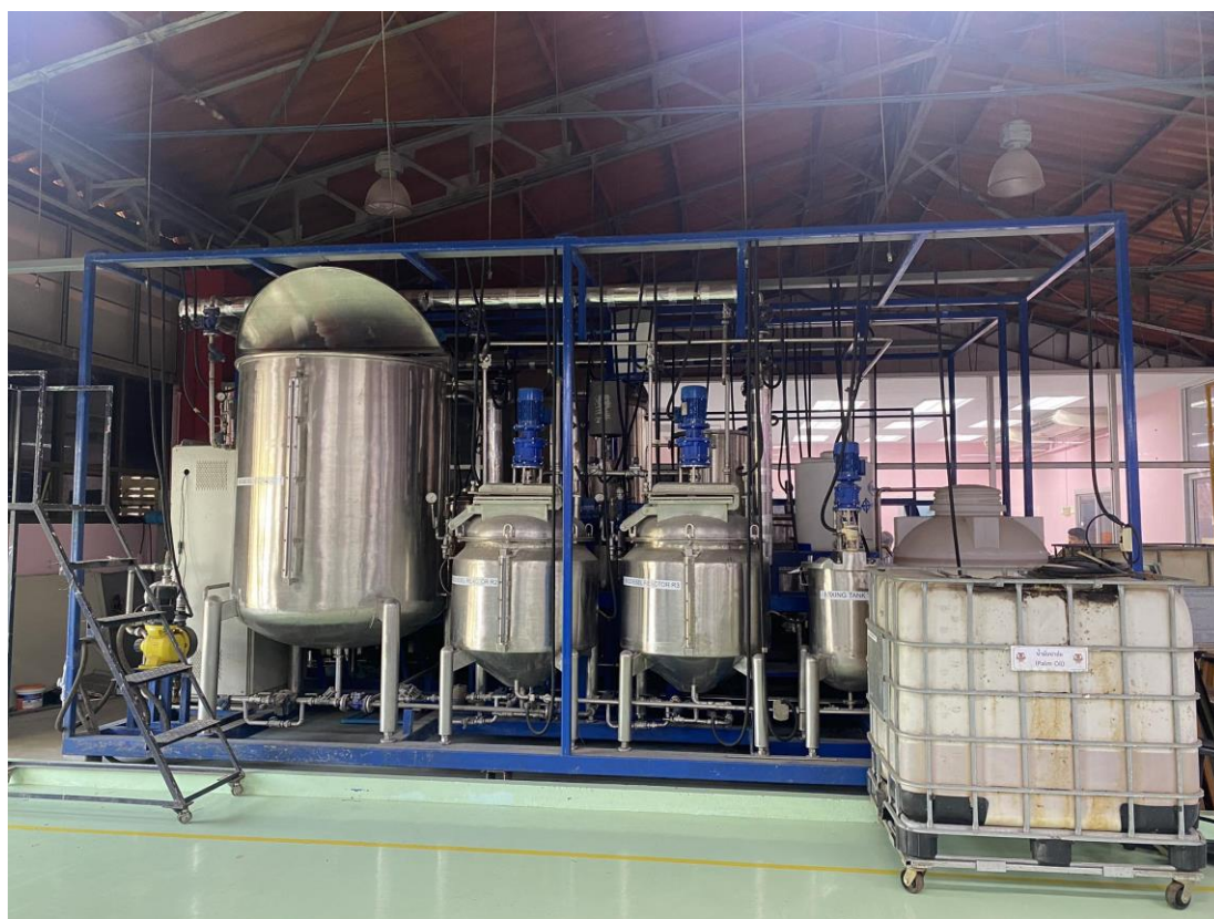
รูปที่ 6 โรงงานต้นแบบ (Pilot plant) สำหรับการผลิตไบโอดีเซลขนาด ลิตร 250 สำหรับรายวิชาโครงการงานวิศวกรรมเคมีและเคมีเภสัชกรรมและรายวิชาปฏิบัติการควบคุมกระบวนการอุตสาหกรรม
