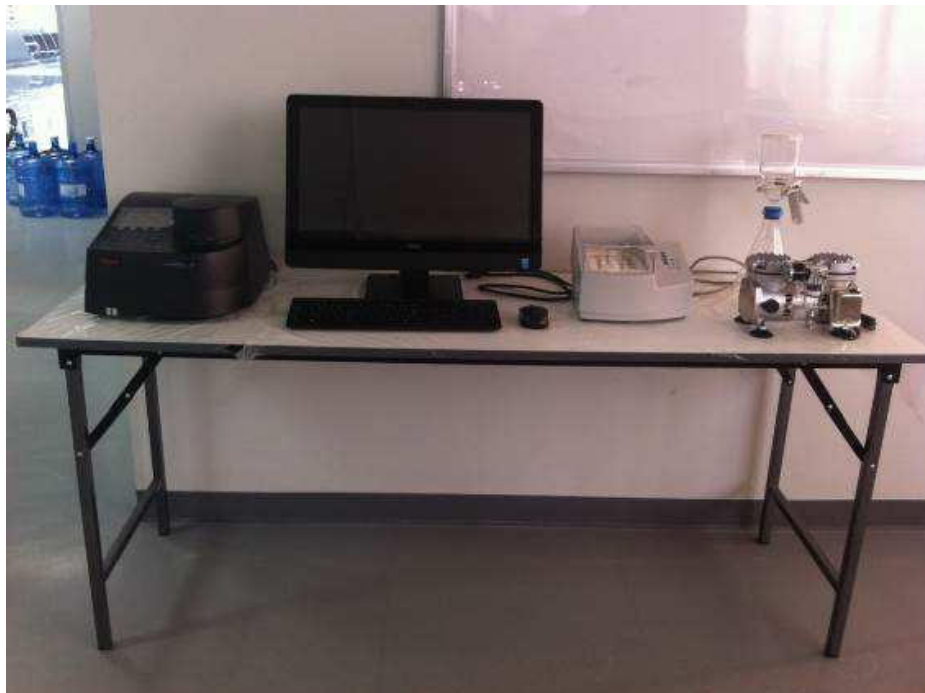
ชุดวิเคราะห์น้ำเสีย BOD, COD และของแข็งแขวนลอย
