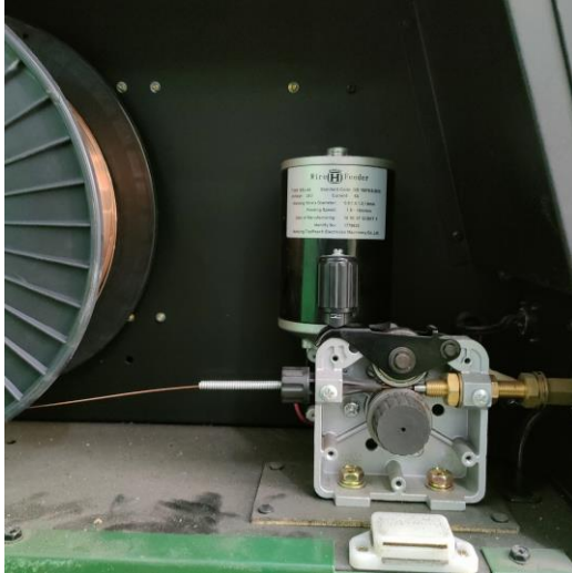
รูปที่ 5.24 เครื่องป้อนลวดและระบบควบคุม
