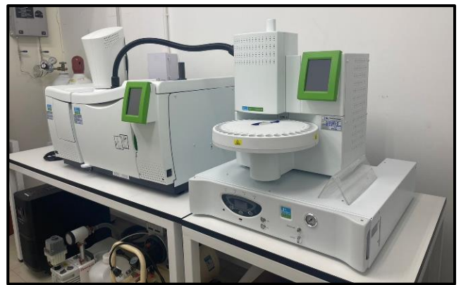
เครื่องแก๊สโครมาโทกราฟี-แมสสเปกโตรมิเตอร์ (GC-MS)
