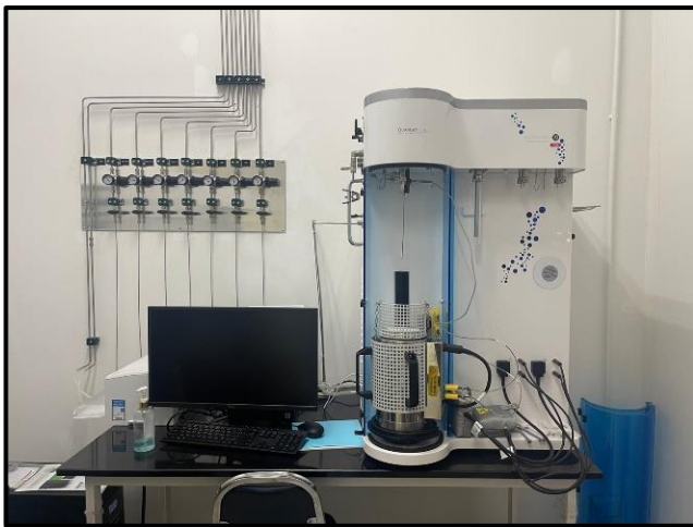
เครื่องวิเคราะห์ค่าการดูดซับทางเคมี (chemisorption)
