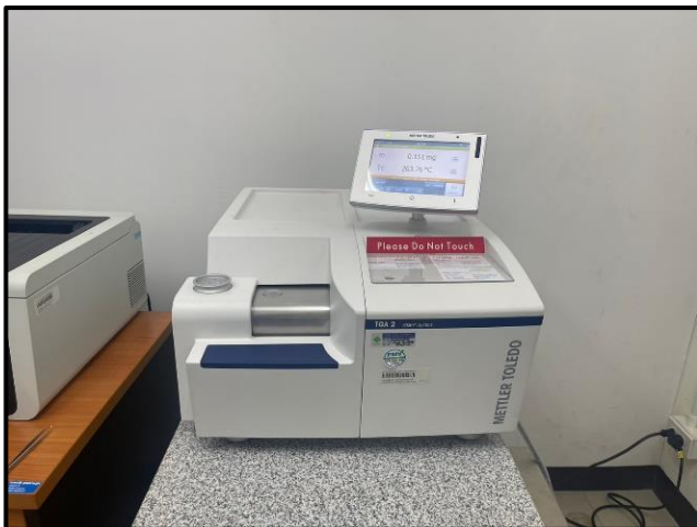
เครื่องศึกษาการเปลี่ยนแปลงน้ำหนักของสาร (TGA)
