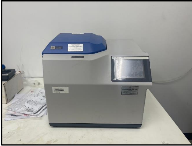
เครื่องวิเคราะห์หาค่าพลังงานความร้อน (Bomb)
