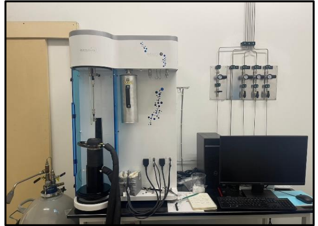
เครื่องวิเคราะห์พื้นที่ผิวและรูพรุน (BET/Surface Area and Pore Size Analyzer)
