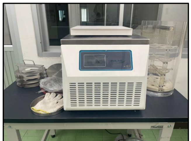
เครื่องอบแห้งแช่แข็งสุญญากาศ (Freeze Dryer)
