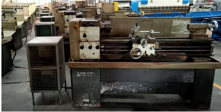
เครื่องกลึงโลหะ Swing Over Bed ขนาด 250 มม.
