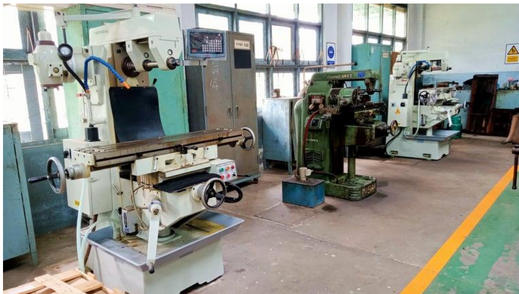
เครื่องกัดโลหะเพลานอน (Horizontal Milling)
