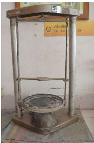
17. เครื่องเขย่าตะแกรงร่อน 2 (SIEVE SHAKER)
