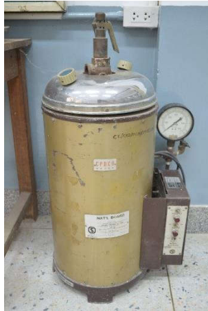
43. ชุดทดสอบการขยายตัวของซีเมนต์ โดยการบ่มด้วยไอน้ำแรงดันสูง (SOUNDNESS OF CEMENT BY AUTOCLAVE METHOD)
