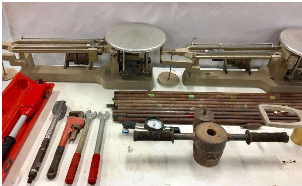
ชุดทดสอบกำลังแทรกทานของดินในสนามแบบหยั่งเบาและกำลังต้านทานแรงเฉือนด้วยใบพัด (KUNZELSTAB PENETRATION TEST AND VANE SHEAR TEST)
