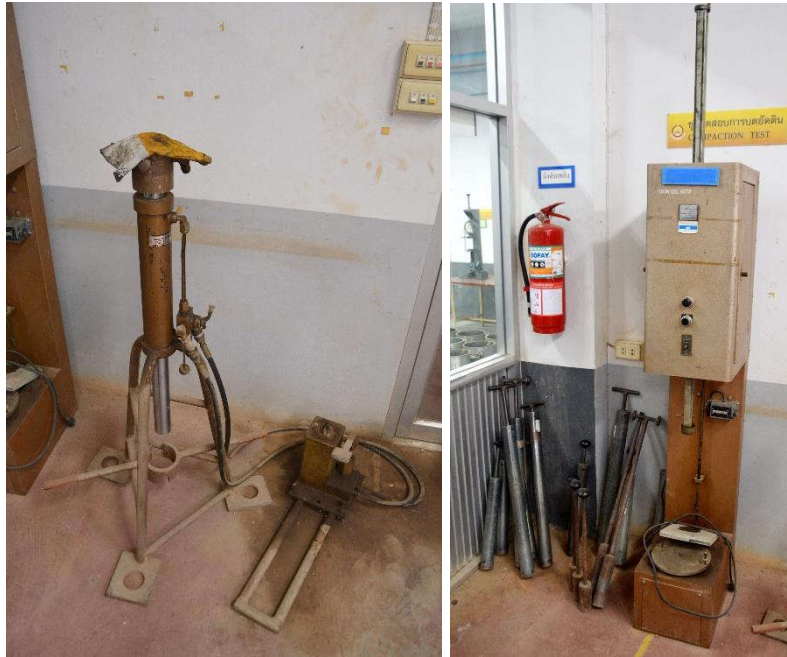
ข. ชุดดินตัวอย่างดินและเครื่องบดอัดระบบอัตโนมัติ
