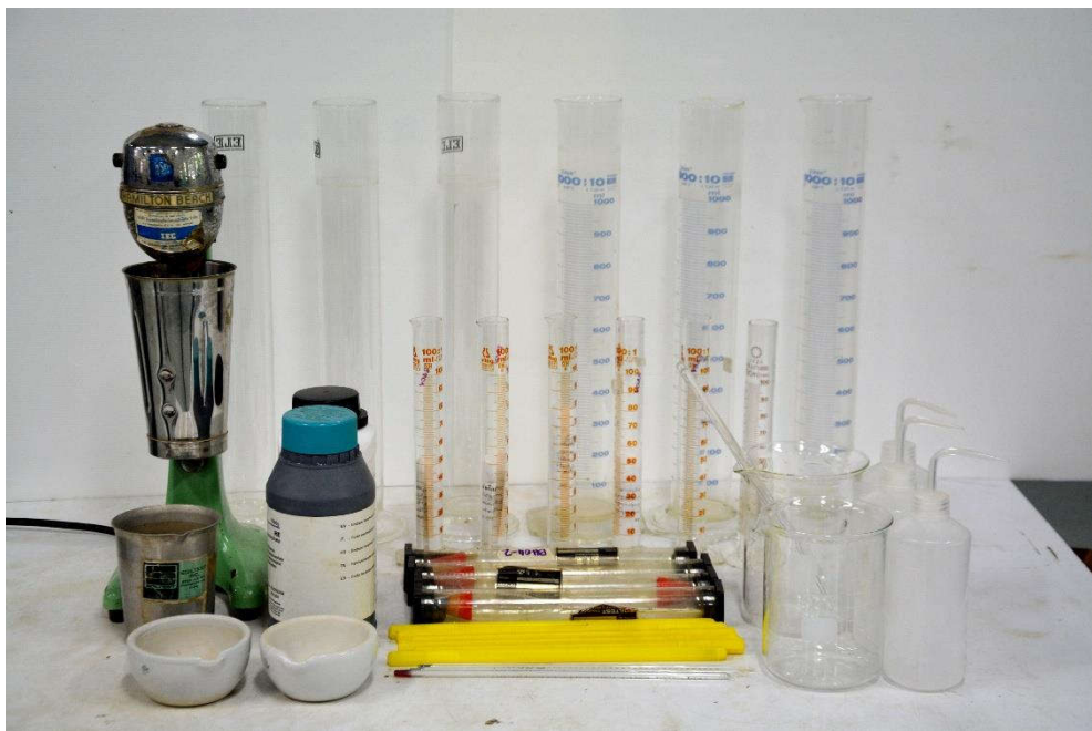
การทดสอบที่ 5 ชุดทดสอบการวิเคราะห์หาขนาดของเม็ดดินด้วยไฮโดรมิเตอร์ (GRAIN SIZE DETERMINATION OF HYDROMETER ANALYSIS)
