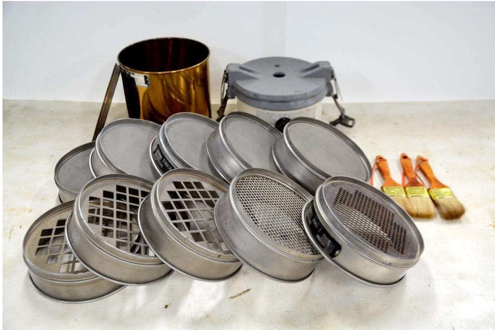
การทดสอบที่ 4 ชุดทดสอบการวิเคราะห์หาขนาดของเม็ดดินโดยใช้ตะแกรงมาตรฐาน (GRAIN SIZE DETERMINATION OF SIEVE ANALYSIS)
