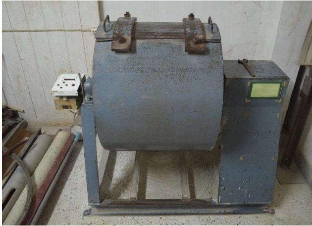
19. เครื่องทดสอบการสึกกร่อนของวัสดุมวลรวมหยาบ (LOS ANGELES ABRASION MACHINE)
