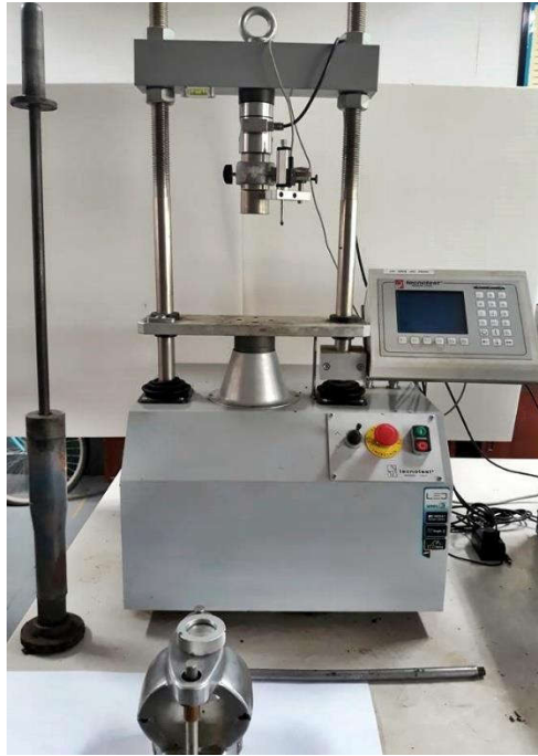
9. เครื่องมือทดสอบหาค่าความต้านทานการไหลของวัสดุผสมด้วยวิธีมาร์แชลล์
