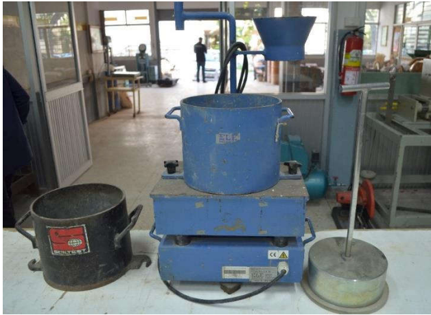
9. ชุดทดสอบเวลารีบี (VEBE CONSISTOMETER)
