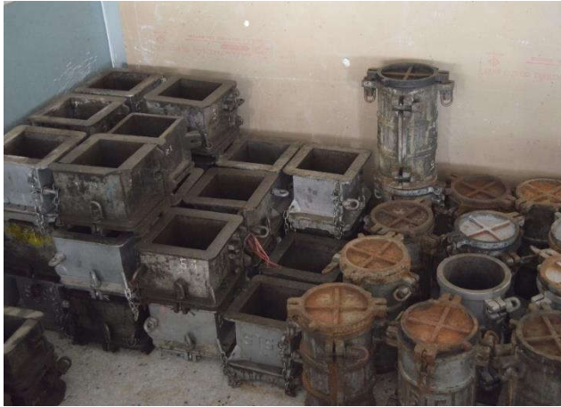
37. แบบหล่อคอนกรีต (CONCRETE MOULD)
