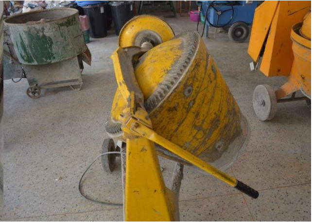
20. เครื่องผสมคอนกรีต 1 (TILTING DRUM CONCRETE MIXER)
