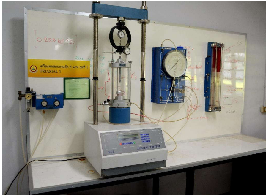
ก. ชุดทดสอบแรงอัดสามแกนกรณีไม่อัดตัวและไม่ระบายน้ำ (UNCONSOLIDATED UNDRAINED TRIAXIAL TEST, UU TEST)
