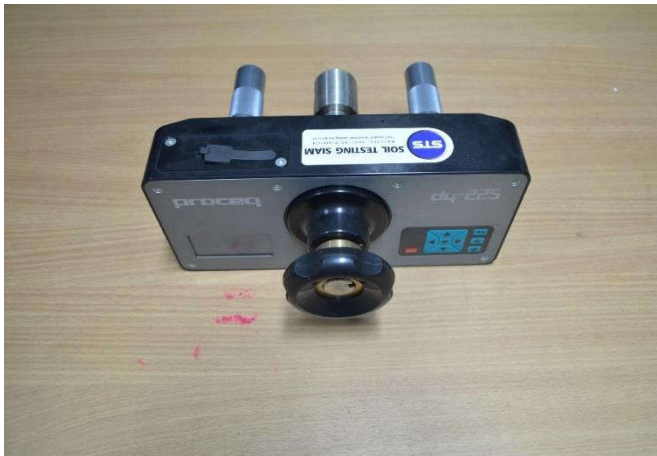
55. เครื่องทดสอบหาค่าการยึดเกาะของปูนซีเมนต์ (BOND STRENGTH OF CONCRETE BY DIRECT TENSION, PULL-OFF METHOD)
