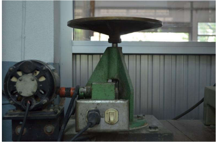
14. เครื่องทดสอบโต๊ะแห่งการไหล (FLOW TABLE)
