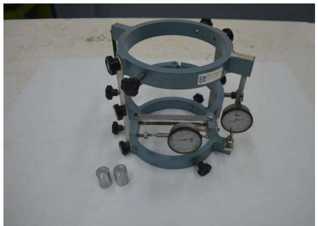
52. เครื่องมือทดสอบการยืดหดตัวของคอนกรีต (COMPRESSOMETER/EXTENSOMETER WITH DIAL GAUGE FOR CYLINDER)
