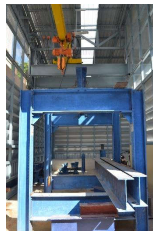
46. เครื่องทดสอบคานคอนกรีตเสริมเหล็กรับแรงบิด (TORSIONAL REINFORCED CONCRETE BEAM TESTING MACHINE)
