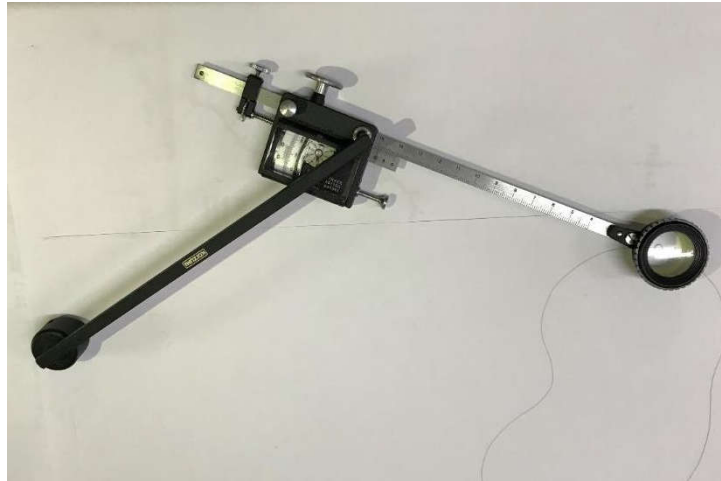
ภาพชุดเครื่องมือ 10. เครื่องวัดพื้นที่จากรูปพื้นที่ (PLANIMETER)
