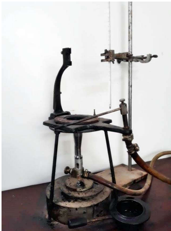
6. เครื่องมือทดสอบหาจุดวาบไฟและจุดติดไฟโดยถ้วยคิลีฟแลนดีโอเพ่น (FLASH AND FIRE POINTS BY CLEVEL AND OPEN CUP)
