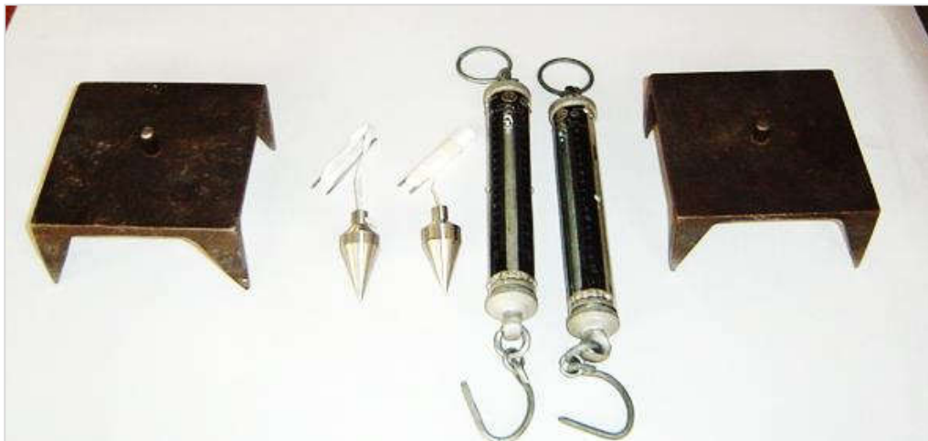
ภาพชุดเครื่องมือ 17 ฐานรองไม้ระดับ, ลูกดิ่ง, ปอนด์ดิ่งไซ้ (FOOT PLATE, PLUMB BOB, SPRING BALANCE)
