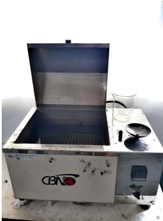
5. เครื่องมือทดสอบหาความชื้นเหลือของวัสดุปิโตรเม้นโดยจางลอย (FLOAT TEST FOR BITUMINOUS MATERIALS)
