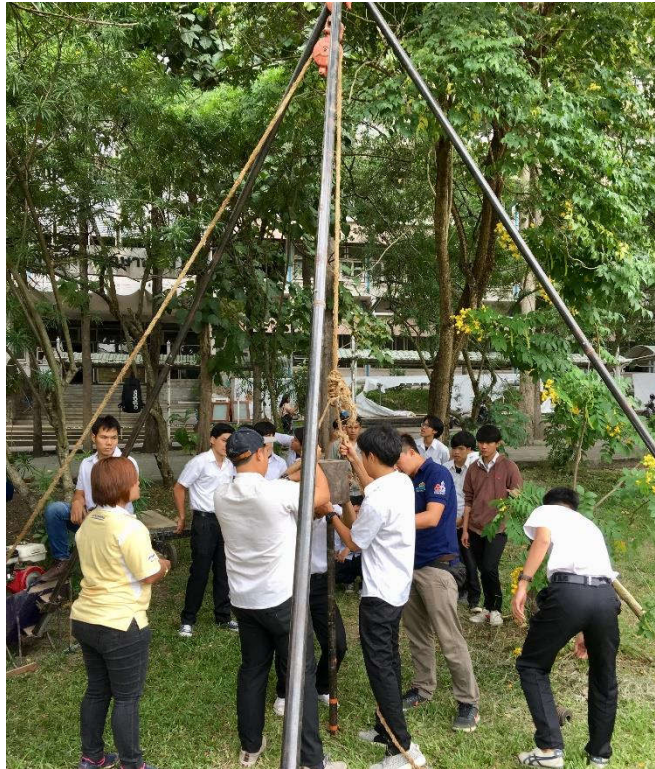
ชุดทดสอบตอกทดสอบแบบมาตรฐาน (STANDARD PENETRATION TEST, SPT)
