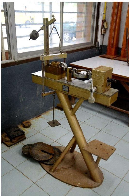
ข. ระบบควบคุมความเร็วโดยใช้มือหมุน การทดสอบที่ 6 ชุดทดสอบแรงเฉือนโดยตรง (DIRECT SHEAR TEST)
