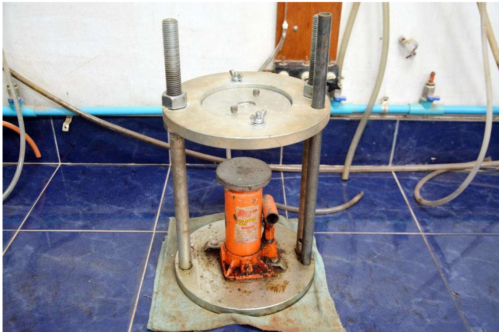
15. เครื่องดันตัวอย่างดินออกจากแบบอัด (HYDRAULIC JACK EXTRUDES)
