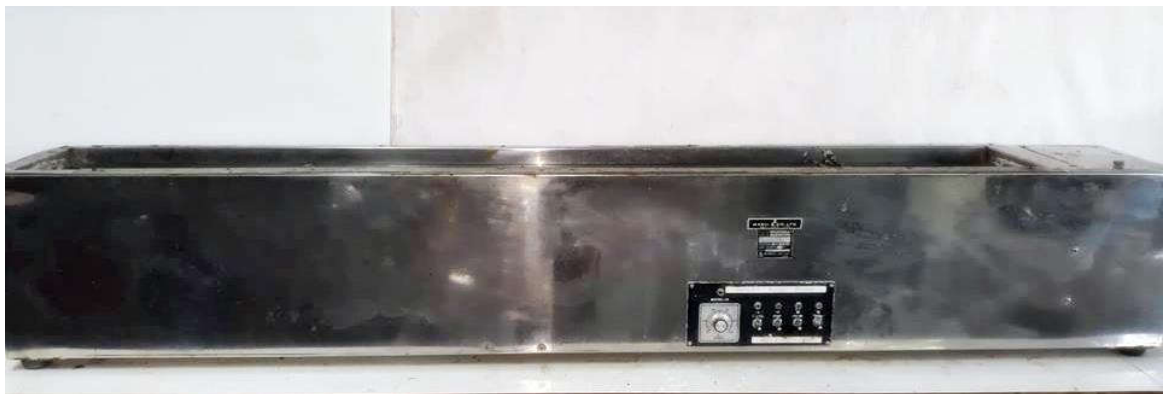
4. เครื่องทดสอบหาค่าการยืดตัวของวัสดุบิทูเมน (TEST FOR DUCTILITY OF BITUMINOUS MATERIALS)
