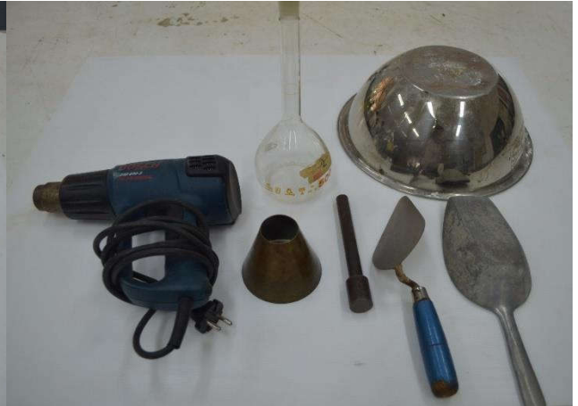
32. ชุดทดสอบหาค่าความถ่วงจำเพาะและการดูดซึมน้ำ ของมวลรวมละเอียด (SPECIFIC GRAVITY AND ABSORPTION OF FINE AGGREGATE)
