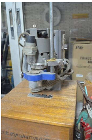
51. เครื่องมือทดสอบหาความร้อนเนื่องจากปฏิกิริยาไฮเดรชัน (MEASUREMENT OF HEAT OF HYDRATION)
