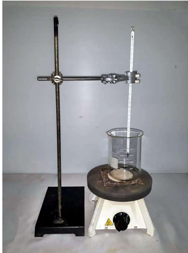
3. เครื่องมือทดสอบหาจุดอ่อนตัวของบิทูเมน (TEST FOR SOFTENING POINT OF BITUMINOUS MATERIALS)
