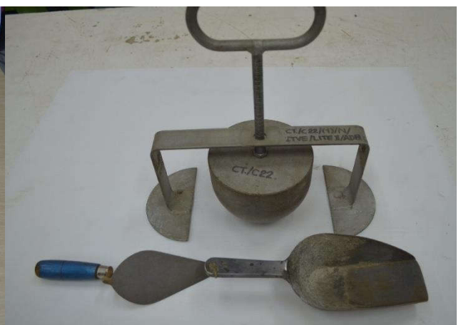
36. ชุดทดสอบการจมของลูกบอลเคลลี่ (KELLY BALL APPARATUS)
