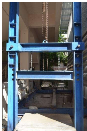
45. การทดสอบท่อคอนกรีตเสริมเหล็กสำหรับงานระบายน้ำ โดยวิธีกำลังรับแรงอัด (THREE-EDGE BEARING TEST OF REINFORCED CONCRETE SEWER PIPE)
