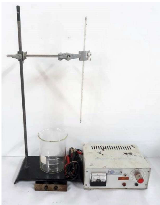
10. ชุดทดสอบหาประจุอนุภาคของ อิมัลซีไฟต์แอสฟัลต์
