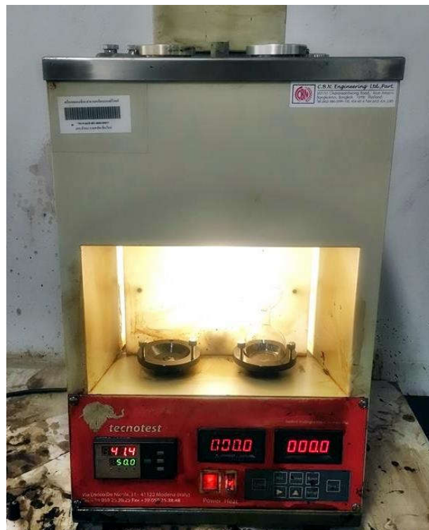
16. การทดสอบความหนืดเซย์โบลต์ (TEST FOR SAYBOLT VISCOSITY)
