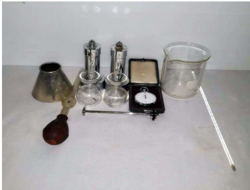
2. เครื่องมือทดสอบความข้นเหลว (SAYBOLT FUROL VISCOSITY TEST)
