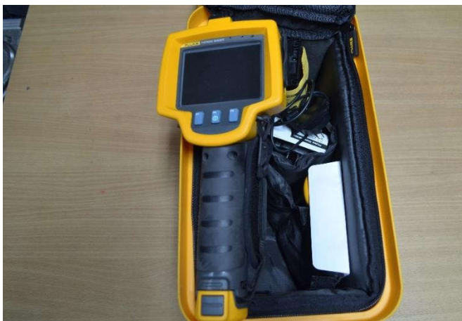
57. กล้องถ่ายภาพความร้อนสำหรับอาคาร (INFRARED CAMERA FOR THERMAL IMAGING)
