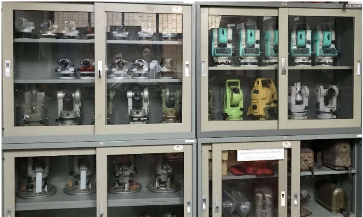
ภาพชุดเครื่องมือ 3 ชุดกล้องวัดมุมชนิดต่าง ๆ (THEODOLITES)
