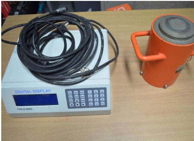
47. ชุดเครื่องมือสอบเทียบแรง 2,000 kN (LOAD CELL 2,000 kN)
