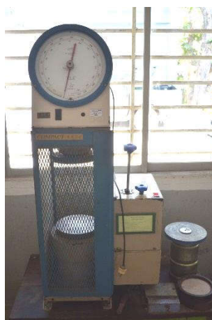
5. เครื่องทดสอบกำลังอัดคอนกรีต 1,500 kN (CONCRETE COMPRESSION TESTING MACHINE 1,500 kN)
