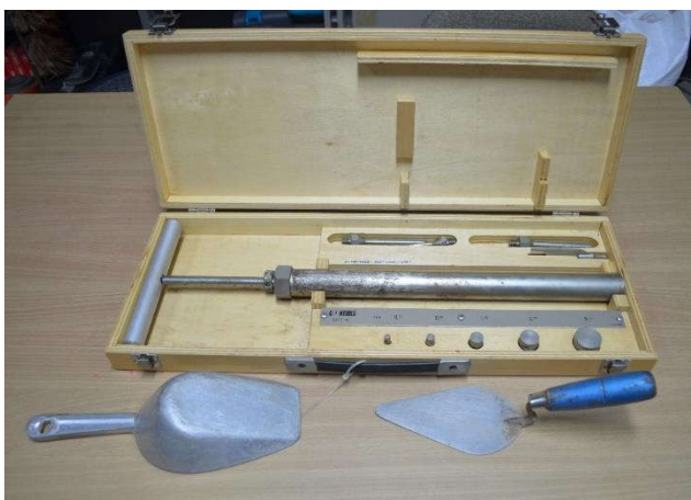
35. ชุดทดสอบการก่อตัวของซีเมนต์มอร์ตาร์โดยการเจาะหยั่ง (CONCRETE MORTAR PENETROMETER)
