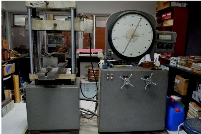
1. เครื่องทดสอบทั่วไป 1 (UNIVERSAL TESTING MACHINE 600 kN : UTM.1)
