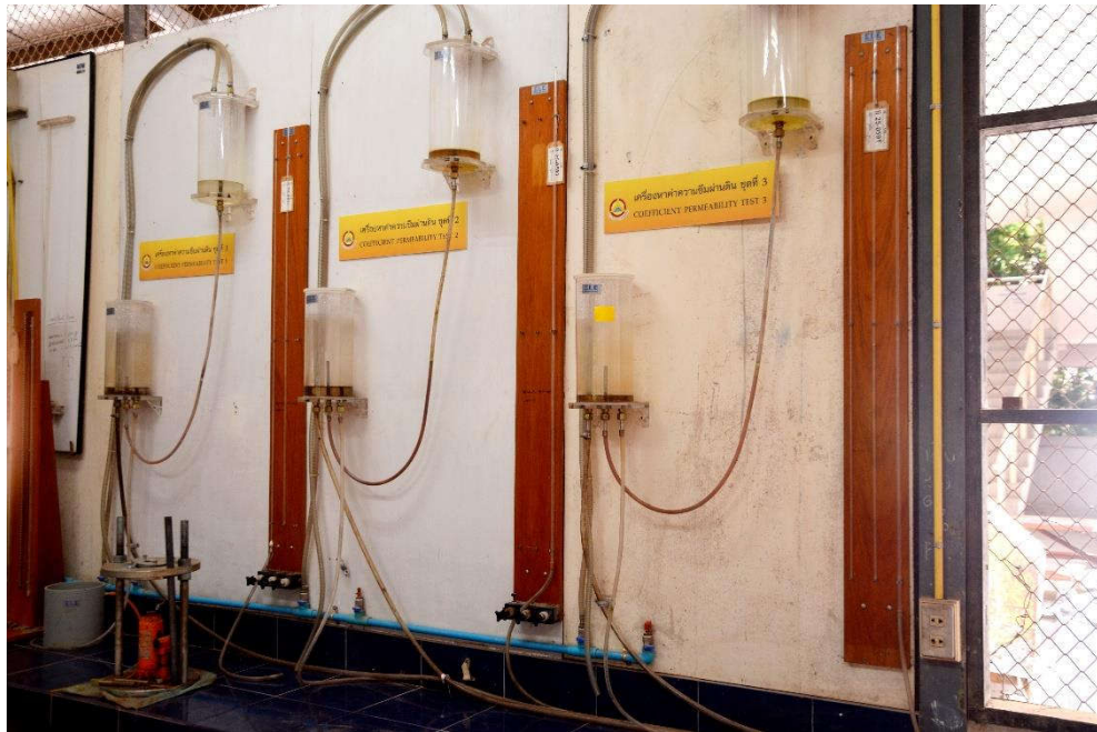
ก. ชุดทดสอบหาค่าสัมประสิทธิ์การซึมผ่านแบบความดันคงที่ และความดันเปลี่ยน (CONSTANT HEAD TEST AND FALLING HEAD TEST)
