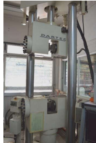
2. เครื่องทดสอบทั่วไป 2 (UNIVERSAL TESTING MACHINE 1,000 kN : UTM.2)
