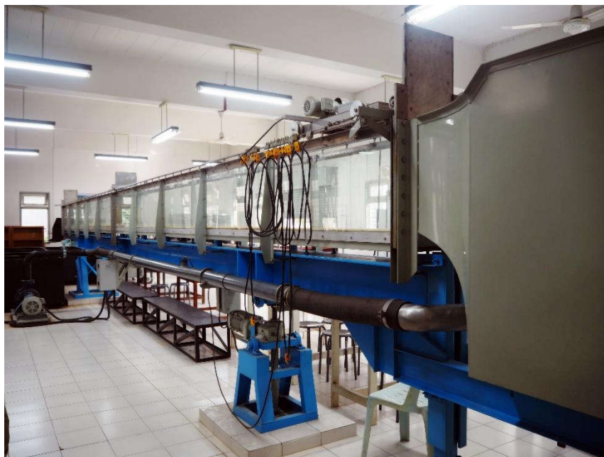
การทดสอบที่ 12 การไหลในทางน้ำเปิดซึ่งสามารถปรับความลาดชันได้
