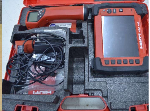
54. เครื่องตรวจสอบตำแหน่งเหล็กเสริมในคอนกรีต (NON-DESTRUCTIVE CONCRETE REINFORCEMENT LOCATOR)
