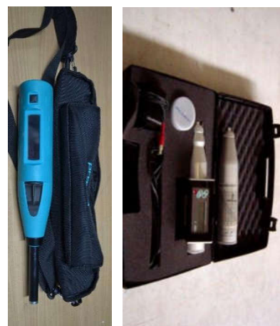
58. เครื่องตรวจสอบหาค่ากำลังอัดคอนกรีตแบบไม่ทำลายด้วยค้อนกระแทก (NON-DESTRUCTIVE TESTING OF CONCRETE BY ELECTRONIC REBOUND HAMMER)
