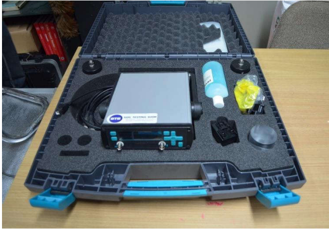
53. ชุดเครื่องตรวจสอบหารอยแตกจ้าวแบบไม่ทำลายด้วยคลื่นอุลตราโซนิค (DETECTION OF CONCRETE DAMAGE USING ULTRASONIC PULSE VELOCITY, UPV METHOD)
