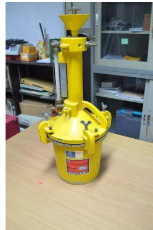
50. เครื่องมือทดสอบหาปริมาณอากาศในคอนกรีต (AIR CONTENT OF FRESHLY MIXED CONCRETE BY PRESSURE METHOD)
