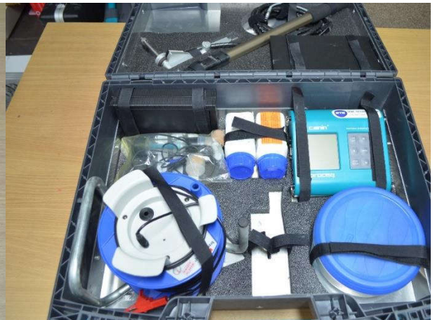
56. ชุดเครื่องทดสอบหาค่าการกัดกร่อนของเหล็กเสริม (CORROSION ANALYSING INSTRUMENT WITH THE HALF-CELL POTENTIAL METHOD)
