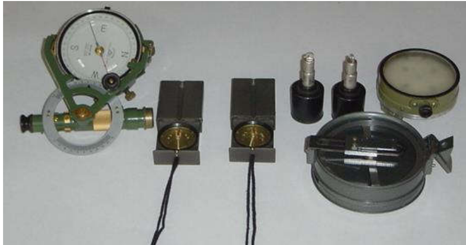
ภาพชุดเครื่องมือ 16. เข็มทิศ เครื่องส่องฉาก ระดับมือ (COMPASS, OPTICAL SQUARE, HAND LEVEL)
