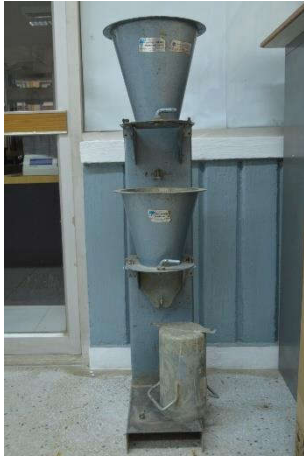
13. เครื่องทดสอบหาสัดส่วนอัดแน่นของคอนกรีตสด (COMPACTING FACTOR APPARATUS)
