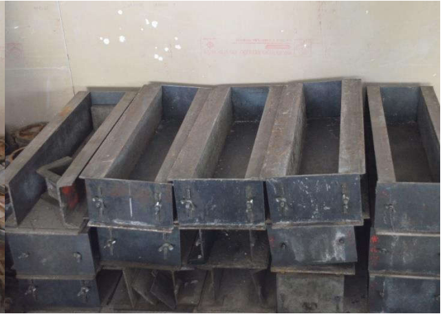
38. แบบหล่อคอนกรีต (CONCRETE MOULD)
