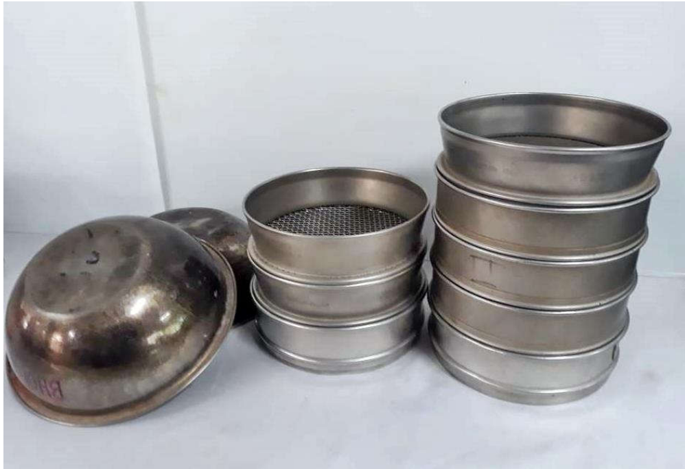
11. เครื่องมือทดสอบหาขนาดเม็ดโดยร่อนผ่านด้วยตะแกรง (SIEVE ANALYSIS)
