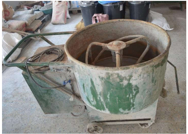
22. เครื่องผสมคอนกรีตแบบถาดกลม (CONCRETE PLANT MIXER)
