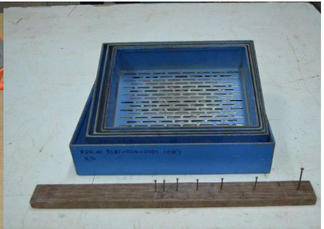
48. เครื่องมือวัดดัชนีความแบนและดัชนีความยาว ของมวลรวมหยาบ (THICKNESS AND LENGTH GAUGE OF COARSE AGGREGATE)
