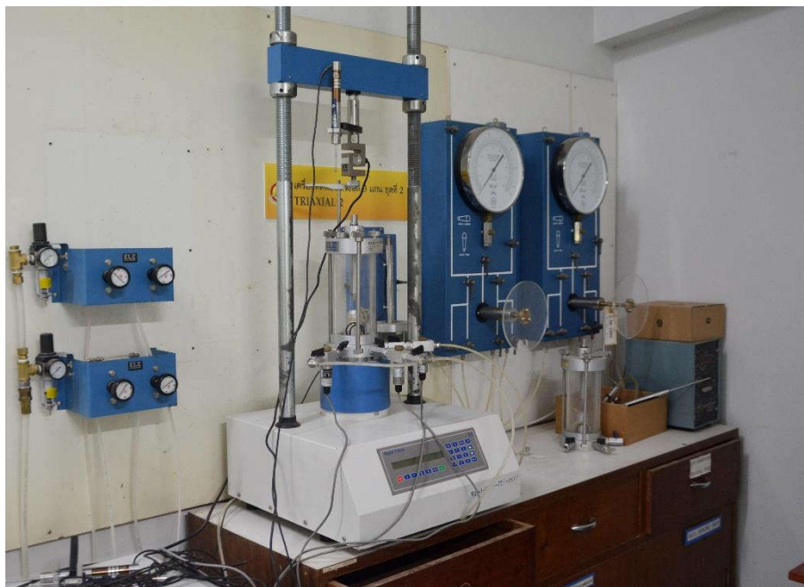
ข. ชุดทดสอบแรงอัดสามแกนกรณีอัดตัวและไม่ระบายน้ำ และกรณีอัดตัวและระบายน้ำ (CONSOLIDATED UNDRAINED TRIAXIAL TEST, CU TEST AND CONSOLIDATED DRAINED TRIAXIAL TEST, CD TEST )
