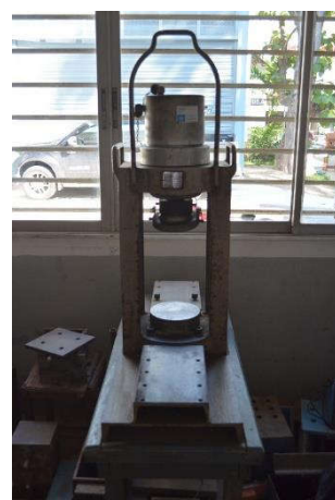
6. เครื่องทดสอบกำลังอัดคอนกรีต 900 kN (CONCRETE COMPRESSION TESTING MACHINE 900 kN)
