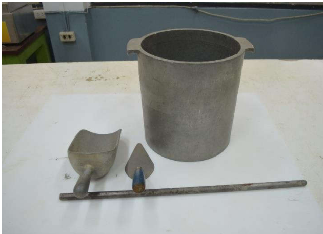
33. ชุดทดสอบหาหน่วยน้ำหนักของมวลรวม (UNIT WEIGHT OF AGGREGATE)
