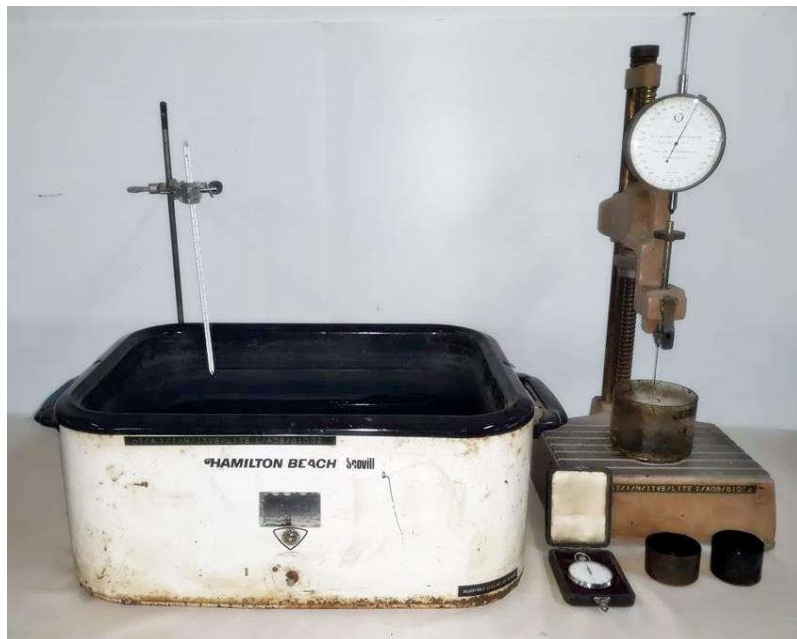
1. เครื่องมือทดสอบหาค่าการทะลวงของวัสดุปิโตรเม้น (PENETRETION OF BITUMINOUS MATERIALS)
