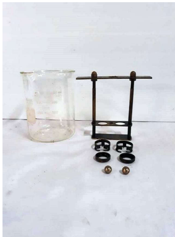
14. การทดสอบจุดอ่อนตัวของวัสดุ-bitumen โดยใช้เครื่องวงแหวนกับลูกปืน (TEST FOR SOFTENING POINT OF BITUMEN RING-AND-BALL)
