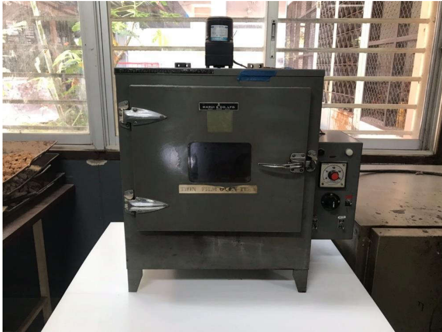
7. เครื่องมือทดสอบหาความร้อนและอากาศที่มีต่อแอสฟัลต์ (LOSS ON HEATING TEST FOR ASPHALTIC MATERIALS)
