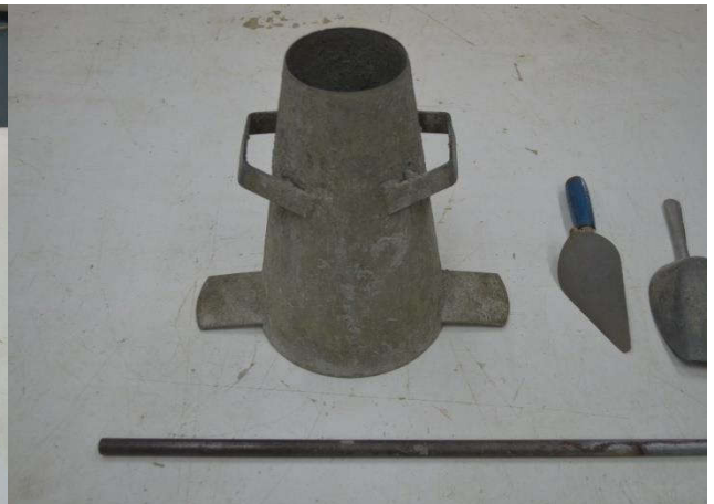
34. ชุดทดสอบค่าการยุบตัวของคอนกรีต (SLUMP TEST)
