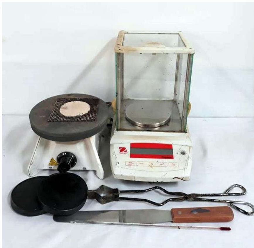
8. ชุดทดสอบการหลุดลอก (STREPPING WITH PLATE TEST)
