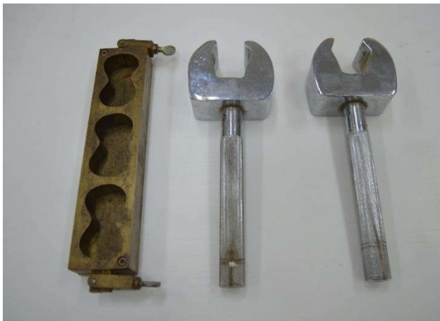
39. ชุดทดสอบแรงดึงของซีเมนต์มอร์ตาร์ (TENSILE STRENGTH TEST OF CEMENT MORTAR)
