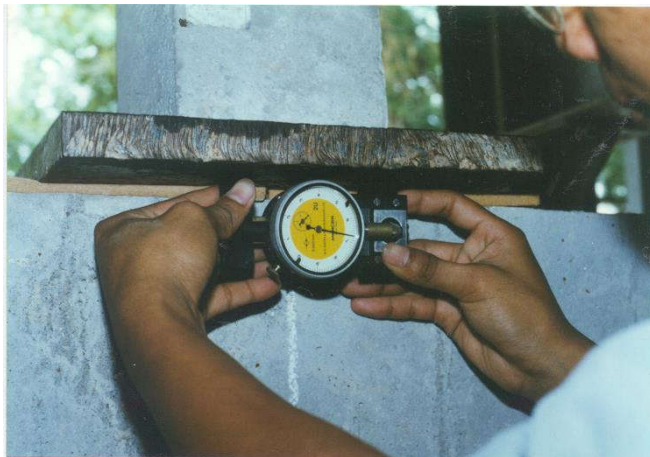
44.1 การวัดค่าการเปลี่ยนแปลงความยาว และความกว้างของรอยแตกริ้วของคานคอนกรีตเสริมเหล็ก เมื่อรับแรงดัด (FLEXURAL STRAIN AND CRACK WIDTH MEASUREMENT OF REINFORCED CONCRETE BEAM)
