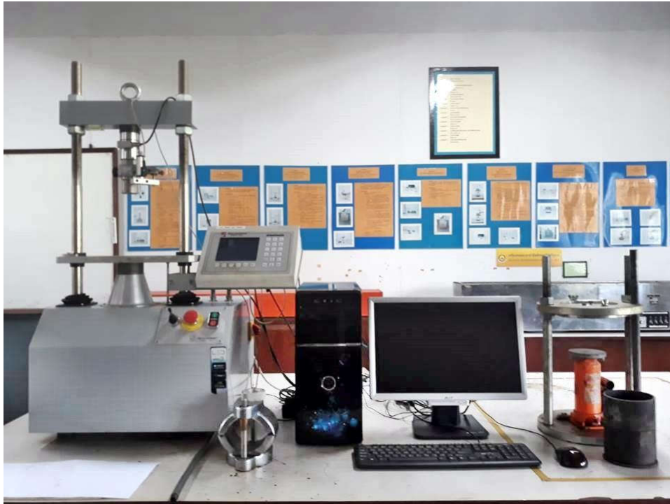
17. การทดสอบความต้านทานการไหลของ แอสฟัลต์คอนกรีตโดยวิธีมาร์แชลล์
