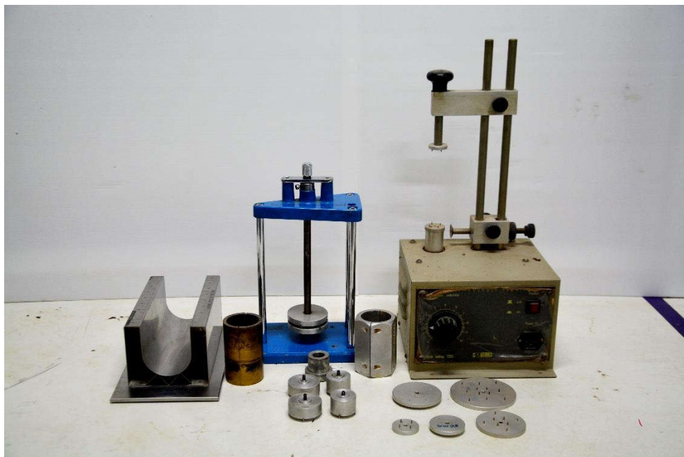
ข.แท่นตัด แต่งตัวอย่างเพื่อทดสอบ การทดสอบที่ 7 ชุดทดสอบแรงเฉือนแบบไม่ถูกจำกัด (UNCONFINED COMPRESSION TEST)
