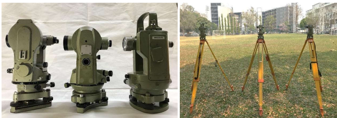
ภาพชุดเครื่องมือ 6 กล้องวัดมุมชนิดต่าง ๆ (THEODOLITES)
