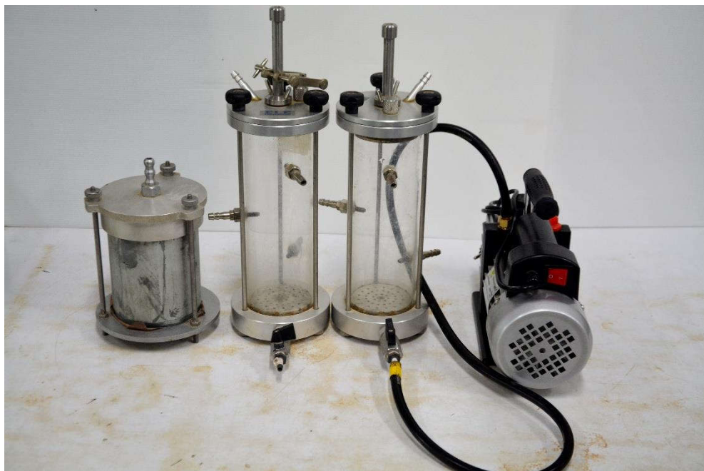
ข. โมลและเครื่องไล่ฟองอากาศ การทดสอบที่ 13 ชุดทดสอบหาค่าสัมประสิทธิ์การซึมผ่าน (PERMEABILITY TEST)
