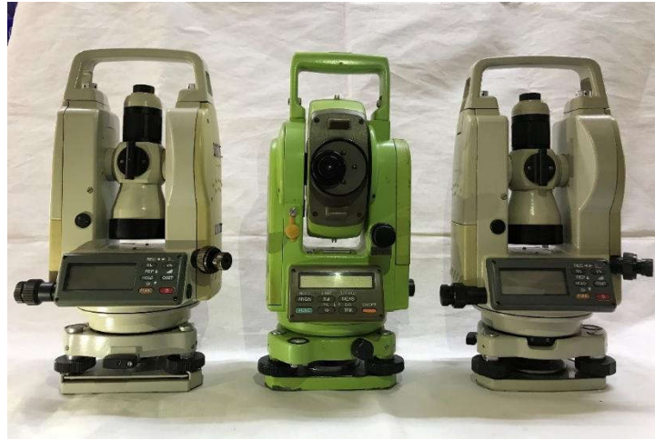
ภาพชุดเครื่องมือ 4 กล้องวัดมุม อิเล็กทรอนิกส์ (ELECTRONIC THEODOLITE)
