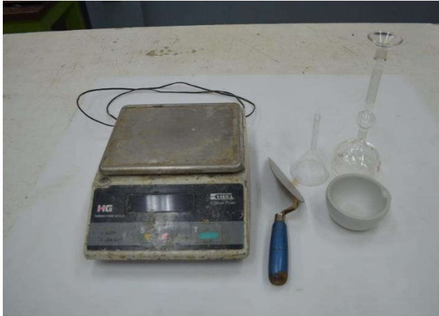
31. ชุดทดสอบการหาค่าความถ่วงจำเพาะของซีเมนต์ (SPECIFIC GRAVITY OF CEMENT)
