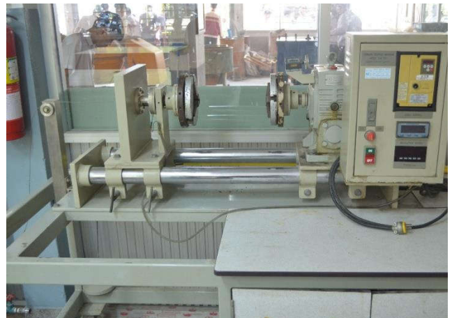
12. เครื่องทดสอบการรับแรงบิดของเหล็กเส้น (TORSIONAL BAR TESTING MACHINE)
