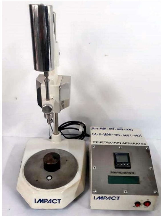
13. การทดสอบเพนิเทรชันของวัสดุ-bitumen (TEST FOR PENETRATION OF BITUMINOUS MATERIALS)
