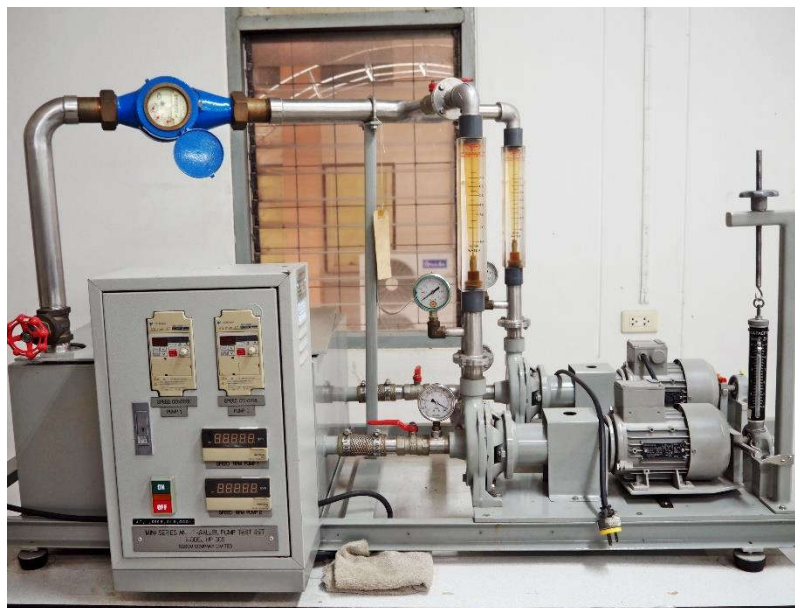
การทดสอบที่ 10 การทดสอบคุณลักษณะของการต่อปั๊มแบบอนุกรมและแบบขนาน
