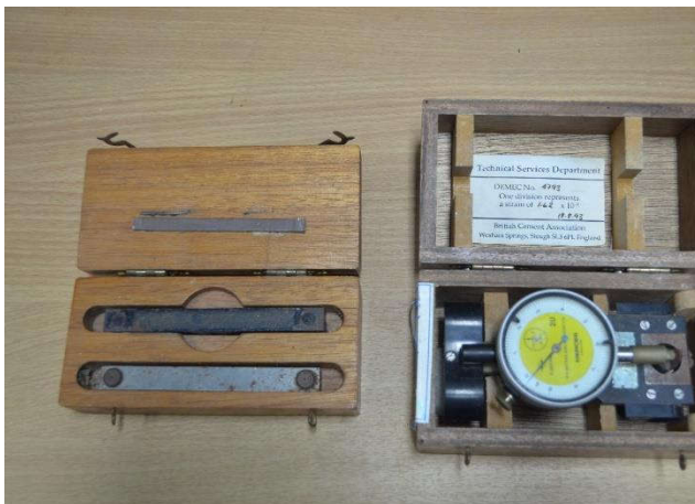
41. เครื่องวัดการยืดหดตัวแบบสปริง (MECHANICAL STRAIN GAUGE)
