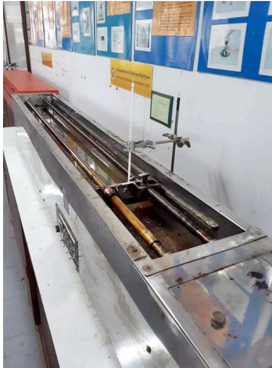
15. การทดสอบความยืดดึงของวัสดุ-bitูเมน (TEST FOR DUCTILITY OF BITUMINOUS MATERIALS)
