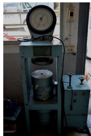
4. เครื่องทดสอบกำลังอัดคอนกรีต 2,000 kN (CONCRETE COMPRESSION TESTING MACHINE 2,000 kN)
