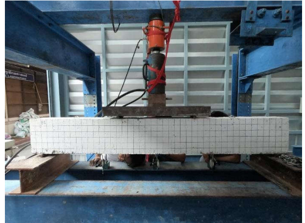
44. การทดสอบคานคอนกรีตเสริมเหล็ก เพื่อศึกษาพฤติกรรมการรับแรงดัด (EXPERIMENTAL INVESTIGATION ON THE FLEXURAL BEHAVIOUR OF FULL-SIZE REINFORCED CONCRETE BEAM)
