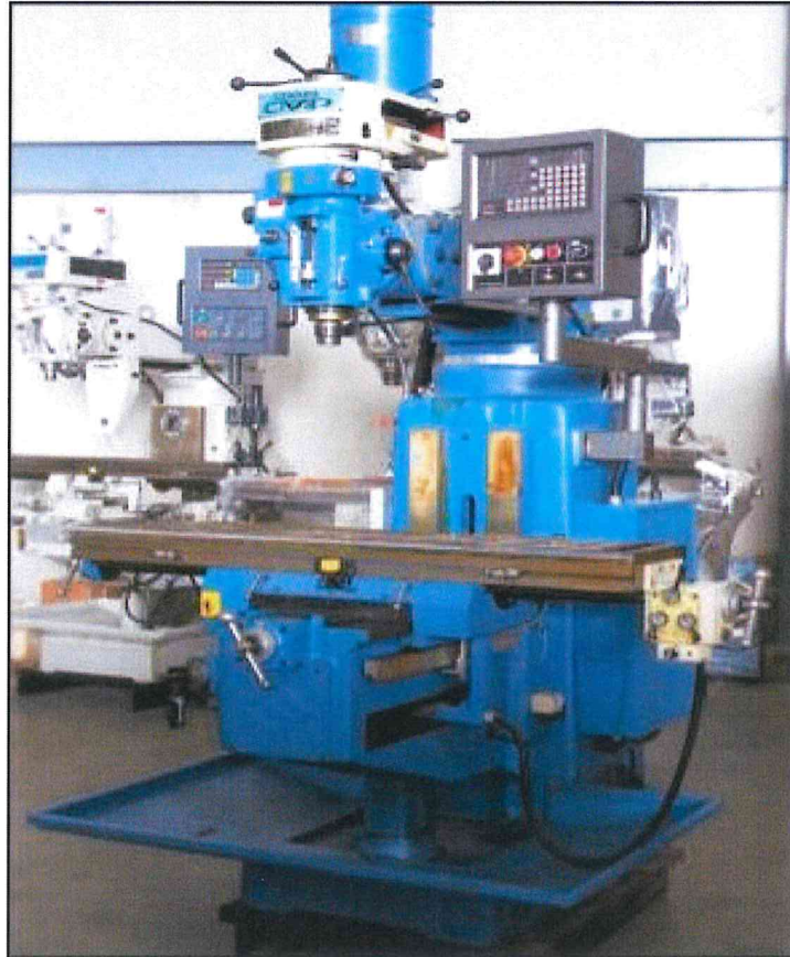
ภาพที่ 58 เครื่องมิลลิ่งแบบแมนนวล (CMP_6H)
