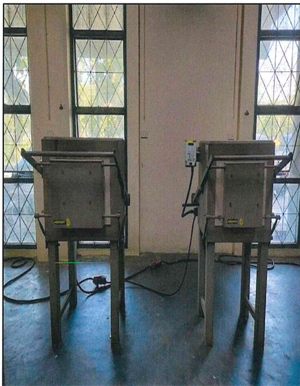
ภาพที่ 76 Heat Treatment Furnace
