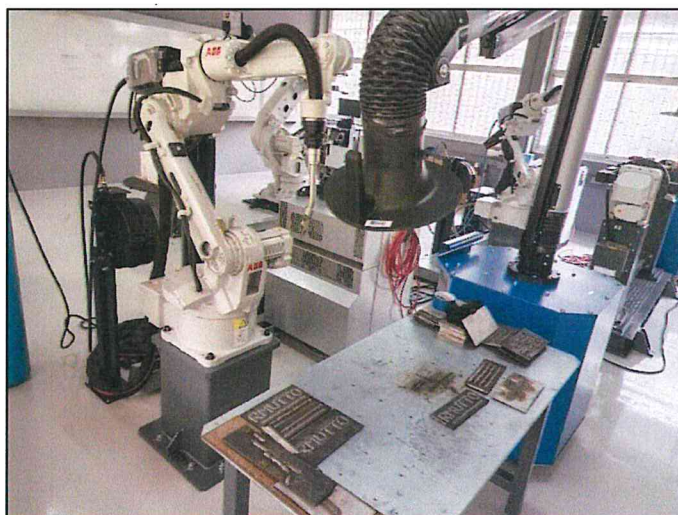
ภาพที่ 27 หุ่นยนต์อุตสาหกรรมสำหรับงานงานเชื่อม, ABB
