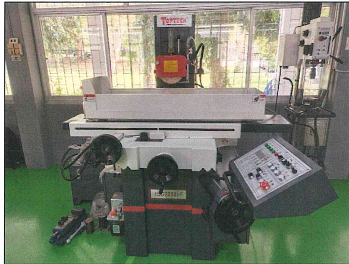
ภาพที่ 21 เครื่องเจียรในแนวราบ, TOPTECH HSG2050VF
