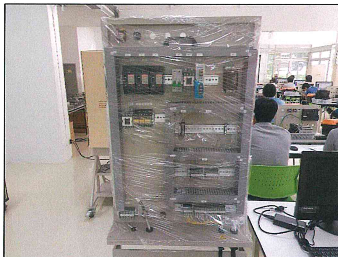
ภาพที่ 15 ชุดจำลองการทำงานระบบอัตโนมัติ PLC
