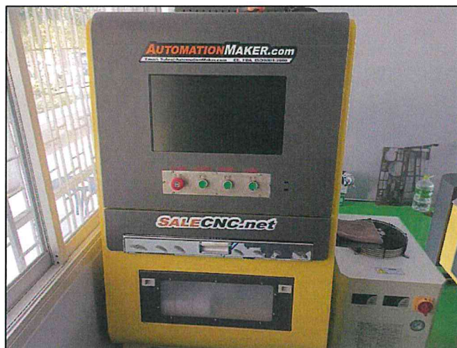
ภาพที่ 25 ตู้ควบคุมเครื่องตัด, CNC Fiber Laser FB16-1530 2000W
