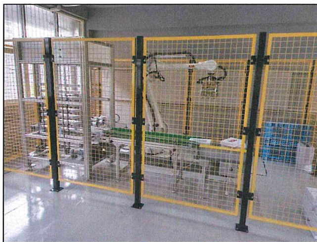
ภาพที่ 26 หุ่นยนต์อุตสาหกรรมสำหรับงาน palletizing, ABB
