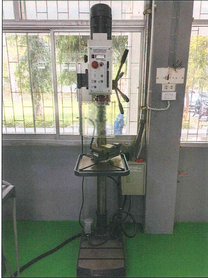
ภาพที่ 22 เครื่องเจาะตั้งพื้น
