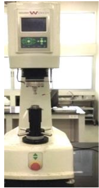
H เครื่องวัดความแข็งแบบรีอคเวล (Superficial Hardness Tester)
