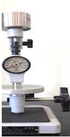
G เครื่องวัดความแข็งพอลิเมอร์ (Durometer)
