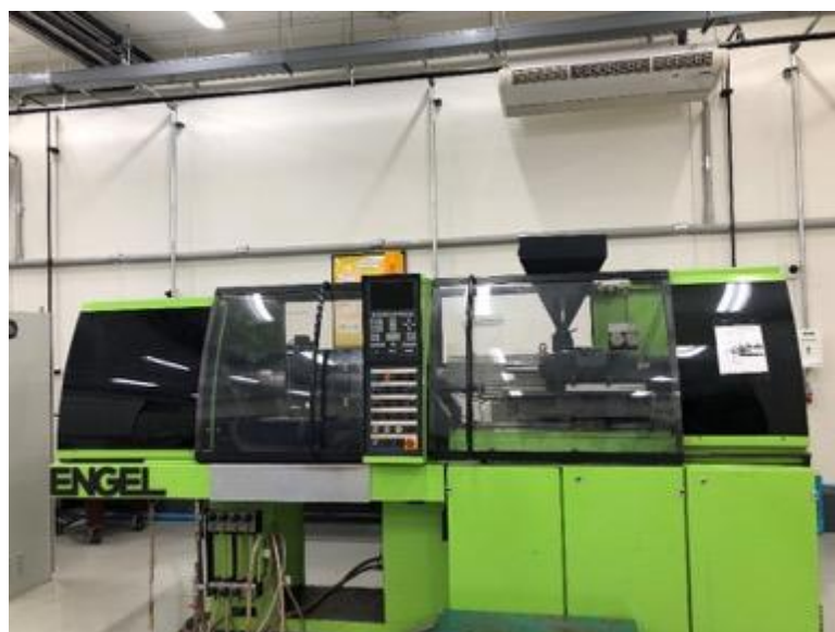
U เครื่องฉีดพลาสติก (Injection Moulding Machine)
