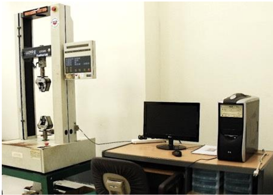
K เครื่องทดสอบอเนกประสงค์ (Universal Testing Machine)
