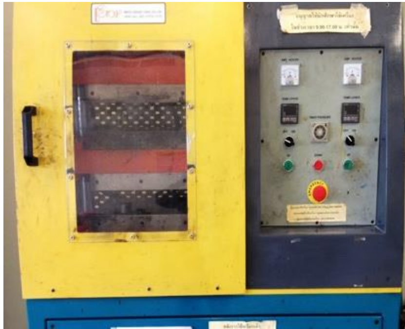
L เครื่องขึ้นรูปร้อนพอลิเมอร์และยาง (Hydraulic Hot Press)
