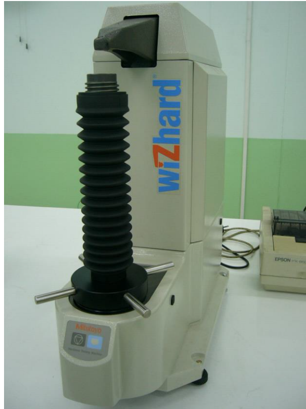
ภาพที่ 4.23 ชุดทดสอบความแข็ง (Hardness Testing Machine)
