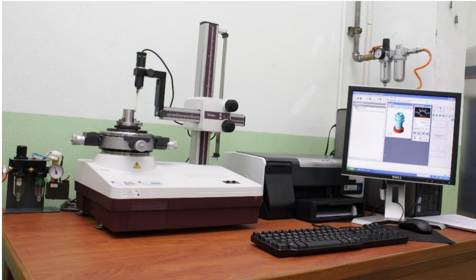
ภาพที่ 3.13 เครื่องวัดความกลม (Roundness Measuring Machine)
