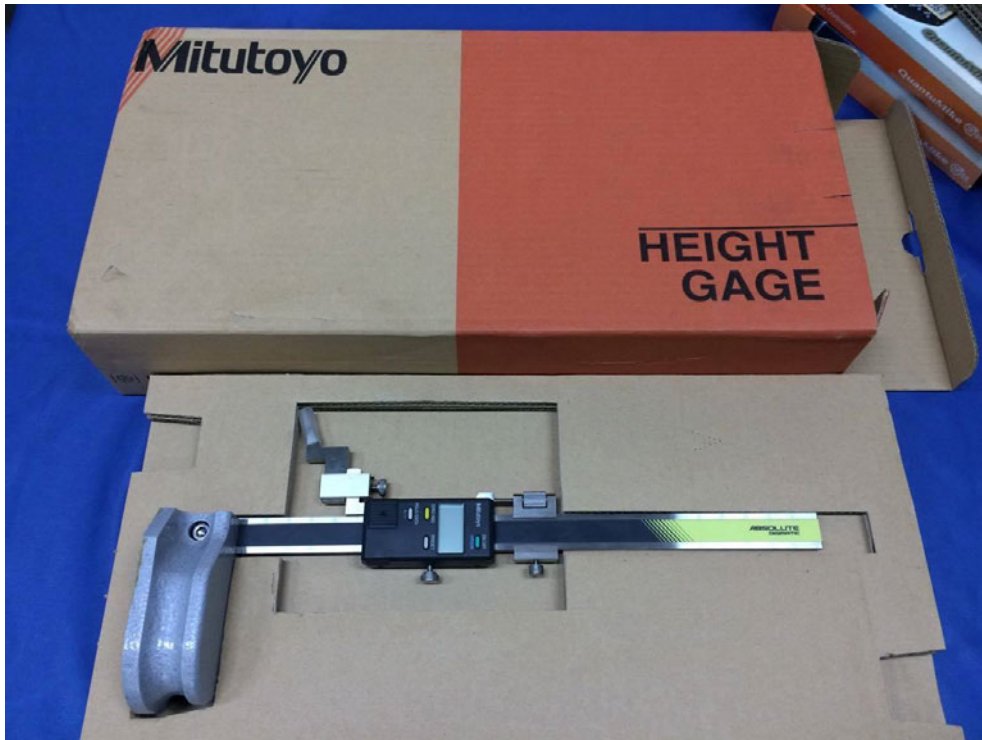
ภาพที่ 3.17 เวอร์เนียไฮเกจ (Vernier Height Gauge)
