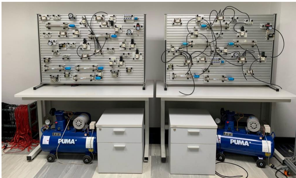
ภาพที่ 2.8 ชุดปฏิบัติการนิวเมติกส์ (Pneumatic Control Trainer)
