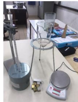
ชุดการเรียนรู้หาค่าความจุความร้อน จำเพาะ
