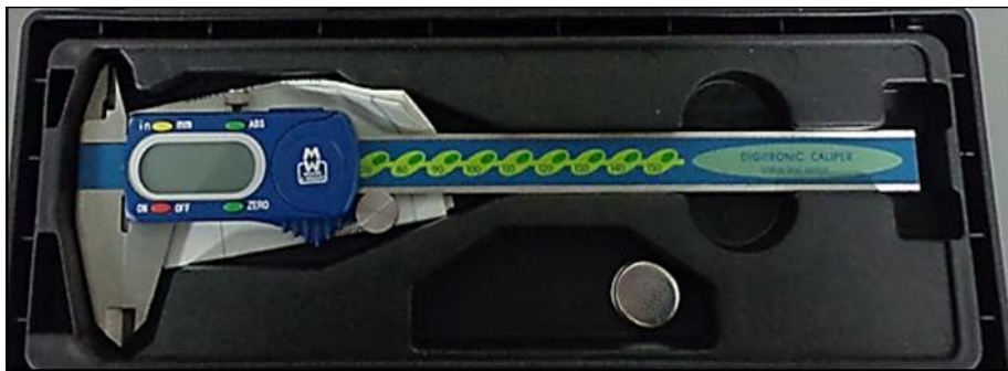
รูปที่ 5.11 เวอร์เนียคาลิปเปอร์ แบบดิจิทัล
