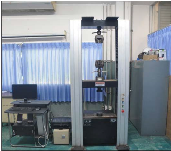
รูปที่ 5.1 เครื่องทดสอบ Universal Testing Machine
