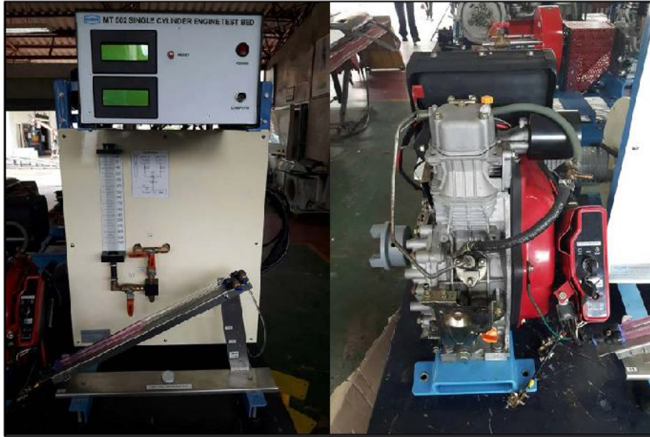
รูปที่ 5.72 การทดสอบสมรรถนะของเครื่องยนต์ดีเซล
