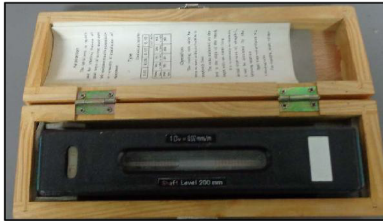
รูปที่ 5.19 ระดับน้ำเครื่องกล (Spirit Level)
