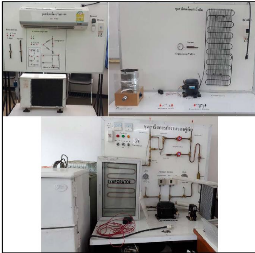
รูปที่ 5.67 การทดลองสมรรถนะของเครื่องทำความเย็นและปรับอากาศ
