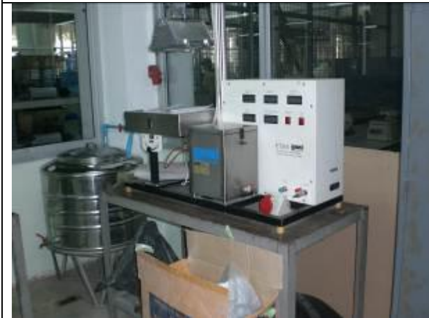
ชุดปฏิบัติการทำน้ำร้อนด้วยพลังงานแสงอาทิตย์
