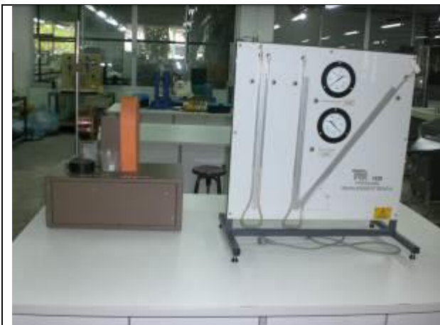
ชุดปฏิบัติการวัดค่าความดันและเทียบมาตรฐาน
