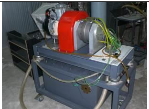
ชุดปฏิบัติการทดสอบเครื่องยนต์แก๊สโซลีน
