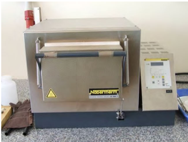
33. เตาอบ จำนวน 1 เครื่อง ยี่ห้อ NABERTHERM รุ่น N11/HR
