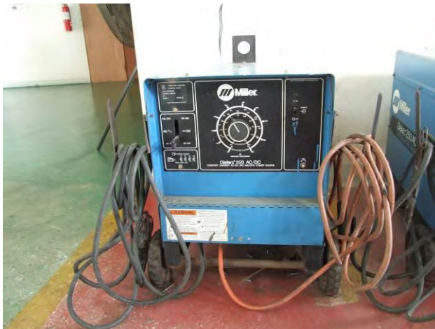
27. เครื่องเชื่อมไฟฟ้า จำนวน 5 เครื่อง ยี่ห้อ MILLER
