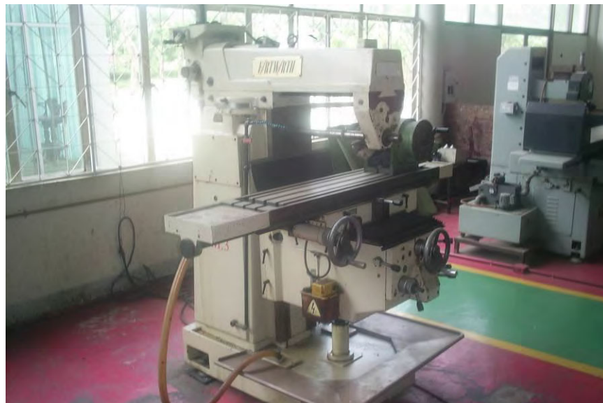
17. เครื่องกัดแนวอน ยี่ห้อ FORTHWORTH รุ่น CS-G450A
