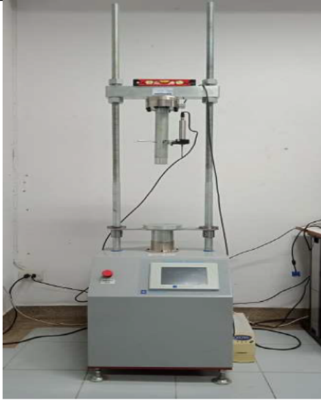
ภาพที่ 11 เครื่องทดสอบหาความแข็งแรงของดินหลังการบดอัด
