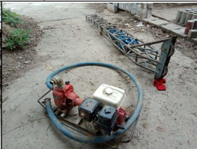
ภาพที่ 13 เครื่องมือเจาะสำรวจดิน
