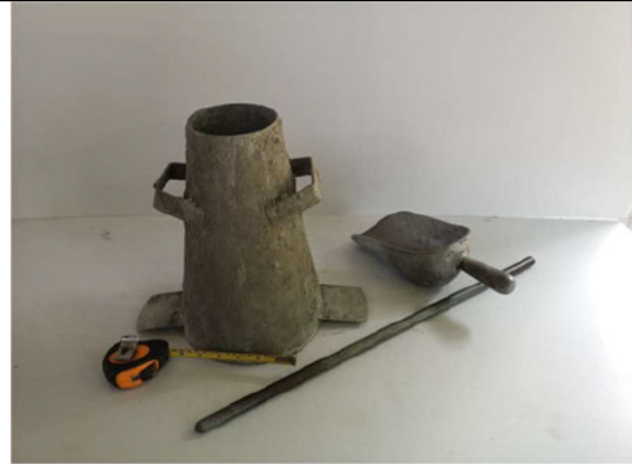
ภาพที่ 28 ชุดทดสอบค่าการยุบตัวของคอนกรีต (Slump Test)
