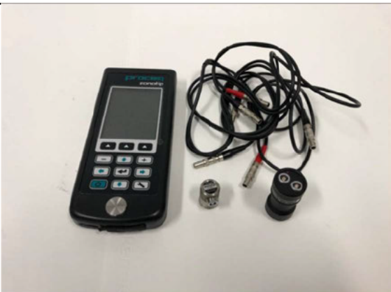
ภาพที่ 19 เครื่องทดสอบความหนาของเหล็ก (Thickness gauge)
