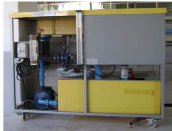
ภาพที่ 14 ชุดทดลองโต๊ะชลศาสตร์ (Hydraulics Bench)
