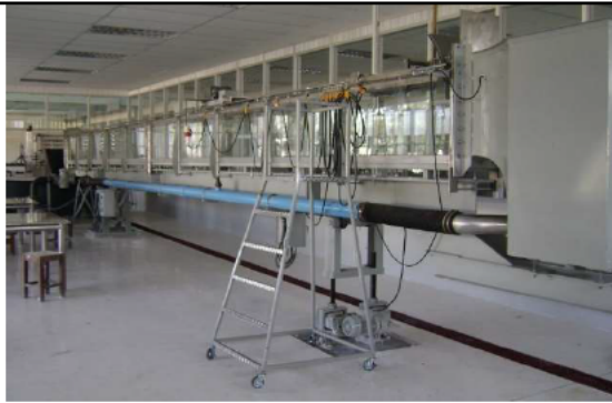
ภาพที่ 11 ชุดทดสอบการไหลแบบรางเปิดขนาดใหญ่ (Open Channel Flume)
