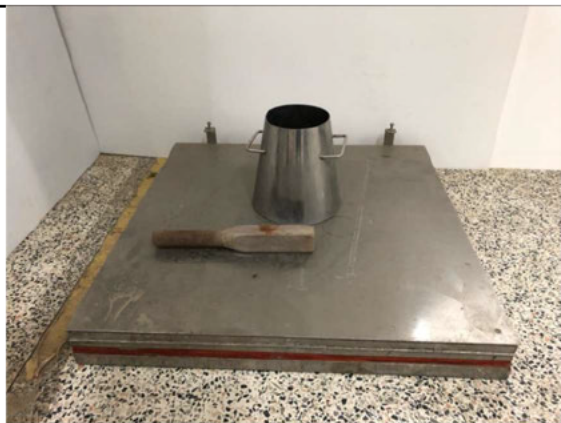
ภาพที่ 31 ชุดทดสอบการไหลตัวของคอนกรีต (Flow Table)
