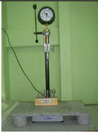
ภาพที่ 29 ชุดทดสอบการก่อตัวของคอนกรีต (Setting Time of Concrete Apparatus)
