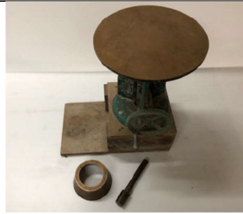
ภาพที่ 30 ชุดทดสอบโต๊ะการไหล (Flow Table Test Set)
