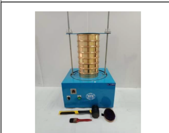
ภาพที่ 3 ชุดทดสอบการจำแนกขนาดของเม็ดดินโดยวิธีใช้ ตะแกรงร่อน
