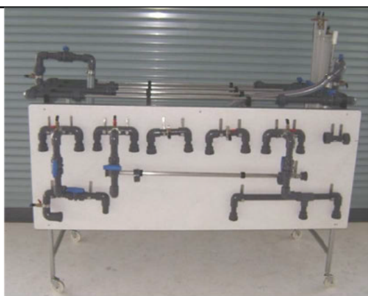
ภาพที่ 9 ชุดทดลองการไหลในระบบท่อ (Pipe Network Apparatus)
