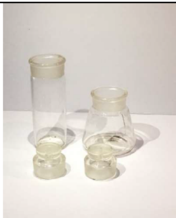
ภาพที่ 5 ชุดทดสอบความถ่วงจำเพาะของวัสดุพิวเม่น โดยใช้ขวด ถ.พ.
