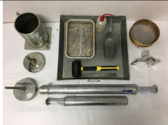
ภาพที่ 6 ชุดทดสอบแคลิฟอร์เนียแบร์ริงเรโซ (C.B.R.)
