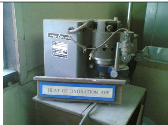
ภาพที่ 40 เครื่องมือทดสอบหาความร้อนเนื่องจาก ปฏิกิริยาไฮเดรชัน (Heat of Hydration)
