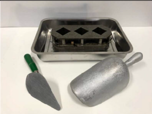
ภาพที่ 23 ชุดทดสอบกำลังอัดของมอร์ต้าซีเมนต์ (Compressive Strength of Mortar Cement)
