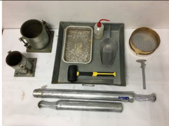
ภาพที่ 5 ชุดทดสอบการบดอัดดินแบบมาตรฐานและแบบ สูงกว่ามาตรฐาน
