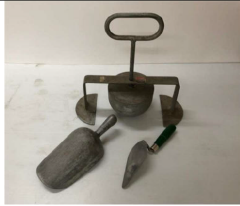
ภาพที่ 34 ชุดทดสอบการจมของลูกบอลเคลลี่ (KELLY Ball Test)
