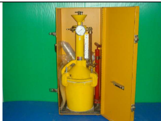
ภาพที่ 39 เครื่องมือทดสอบหาปริมาณอากาศ (Air Content of Freshly Mixed Concrete by Pressure Method)
