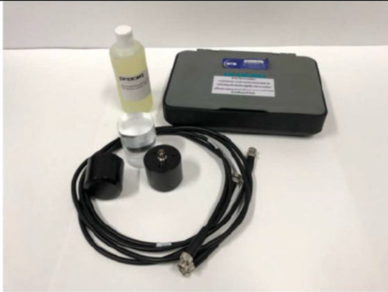
ภาพที่ 15 เครื่องตรวจสอบหาความแข็งแรงและความ สม่ำเสมอด้วยคลื่นอัลตราโซนิค (Ultrasonic Pulse Velocity Test)
