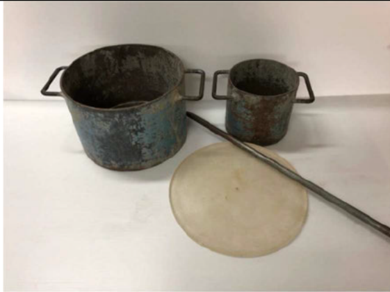
ภาพที่ 27 ชุดทดสอบหาหน่วยน้ำหนักของวัสดุ คอนกรีต (Unit Weight of Aggregate)
