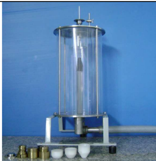
ภาพที่ 5 ชุดทดลองวัดแรงกระแทกของลำน้ำ (Impact of Jet)
