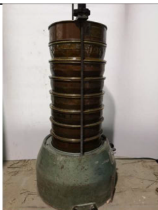
ภาพที่ 41 เครื่องร่อนมวลรวมละเอียด (Sieve Shaker)
