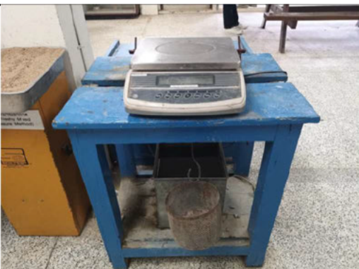
ภาพที่ 25 ชุดทดสอบหาความถ่วงจำเพาะของมวลรวมหยาบ (Specific Gravity Test Set)
