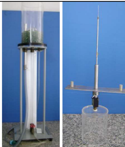
ภาพที่ 6 ชุดทดลองอุปกรณ์ของ Osborne Reynolds Apparatus)
