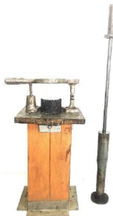
ภาพที่ 10 ชุดทดสอบแอสฟัลท์คอนกรีตมิกซ์โดยวิธี มาร์แชลล์
