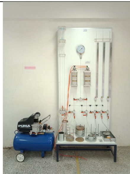
ภาพที่ 8 ชุดทดสอบการหาค่าความซึมได้ของน้ำผ่านดิน
