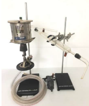
ภาพที่ 9 ชุดทดสอบหาปริมาณน้ำในยางมะตอยน้ำ
