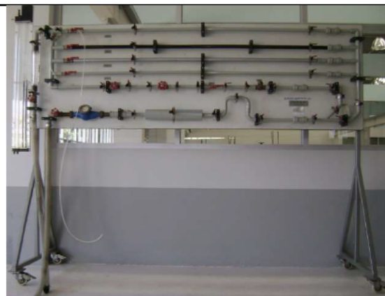
ภาพที่ 8 ชุดทดลองหาความเสียดทานในข้องอและข้อต่อท่อ (Bends and Fitting Friction)
