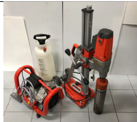
ภาพที่ 20 เครื่องเจาะเก็บตัวอย่างคอนกรีตคอนกรีตรูป ทรงกระบอก (concrete drilling machine)
