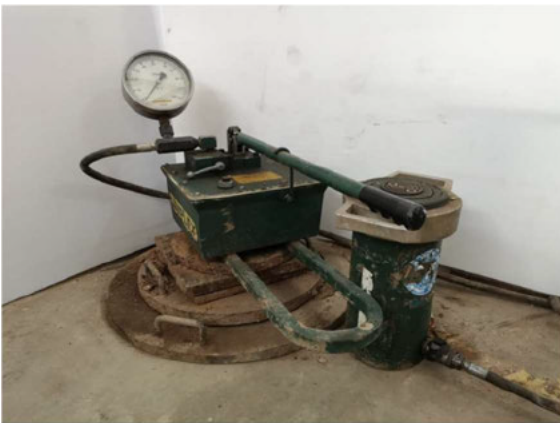
ภาพที่ 37 แม่แรงไฮดรอลิก 100 ตัน (Hydraulic Jack 100 Tons)
