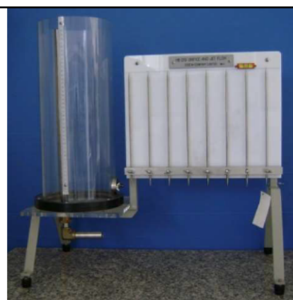
ภาพที่ 10 ชุดทดลองการไหลผ่านรูคอดและลำน้ำอิสระ (Orifice and Jet Flow)
