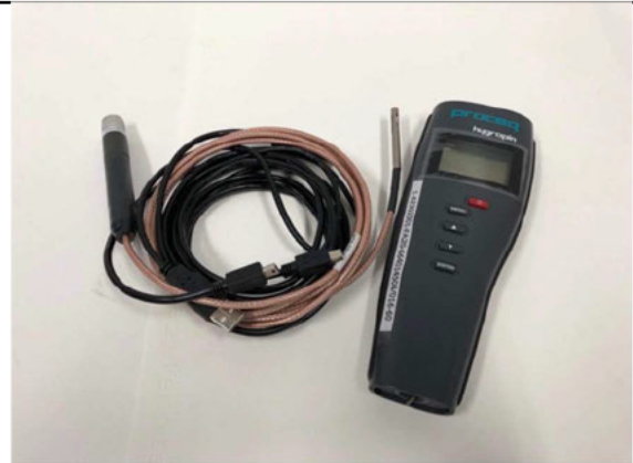
ภาพที่ 18 เครื่องตรวจสอบความชื้นในคอนกรีต (Relative humidity tester)
