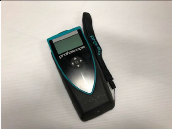
ภาพที่ 17 เครื่องตรวจสอบหาเหล็กในคอนกรีต (Profiler and Profoscope Rebar locator and concrete cover meters )
