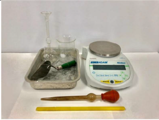
ภาพที่ 21 ชุดทดสอบการหาค่าความถ่วงจำเพาะของซีเมนต์ (Specific Gravity of Cement)
