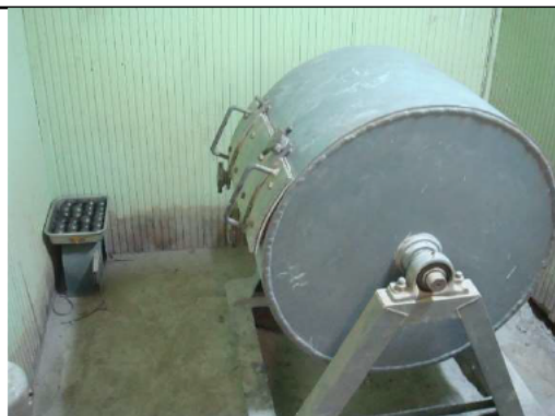
ภาพที่ 26 ชุดทดสอบการสึกหรอของวัสดุมวลรวมหยาบ (Los Angeles Abrasion Machine)
