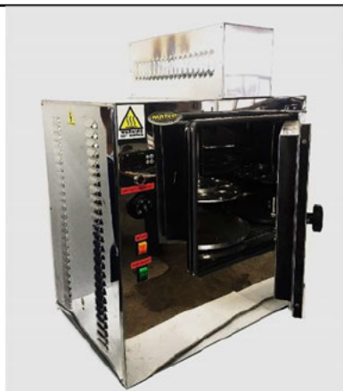
ภาพที่ 7 ชุดทดสอบหาความสูญเสียเมื่อได้รับความร้อน
