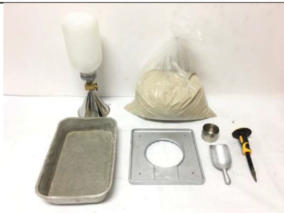
ภาพที่ 7 ชุดทดสอบการหาค่าความหนาแน่นของดินใน สนาม
