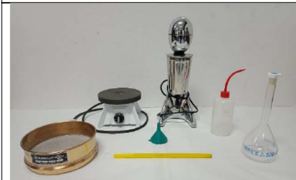
ภาพที่ 1 ชุดทดสอบการหาค่าความถ่วงจำเพาะของเม็ดดิน
