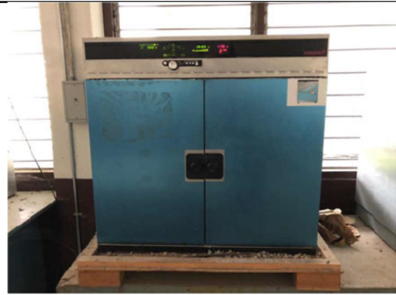
ภาพที่ 46 เตาอบควบคุมอุณหภูมิอัตโนมัติ (Dryer Oven)
