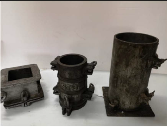
ภาพที่ 35 แบบหล่อคอนกรีตรับแรงอัด
