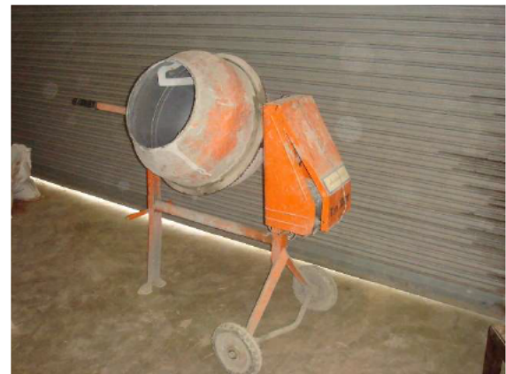
ภาพที่ 38 เครื่องผสมคอนกรีตขนาดเล็ก : ขนาด 0.1 m 3
