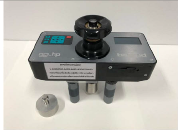
ภาพที่ 16 เครื่องทดสอบหาค่าการยึดเกาะและกำลัง ด้วยวิธีการดึง (Fully automated pull-off adhesion testers for concrete strength testing)
