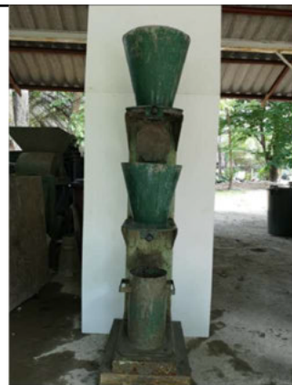
ภาพที่ 32 เครื่องทดสอบหาสัดส่วนอัดแน่นของ คอนกรีตสด (Compacting Factor Apparatus)
