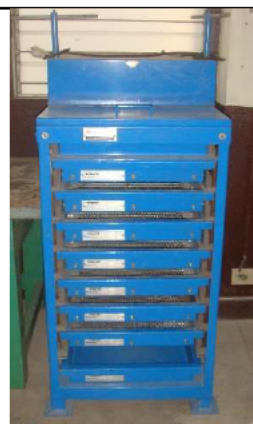
ภาพที่ 42 เครื่องร่อนมวลรวมหยาบ (Sieve shaker)
