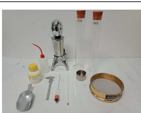
ภาพที่ 4 ชุดทดสอบการจำแนกขนาดของเม็ดดินโดยวิธีใช้ Hydrometer
