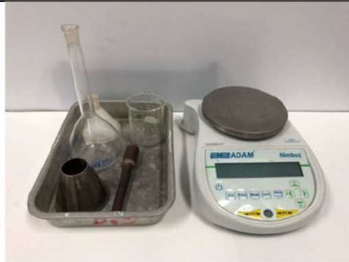
ภาพที่ 24 ชุดทดสอบหาค่าความถ่วงจำเพาะและการดูดซึมน้ำของมวลรวมละเอียด (Specific Gravity and Absorption of Fine Aggregate)
