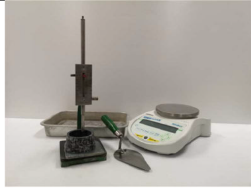
ภาพที่ 22 ชุดทดสอบการหาค่าขีดจำกัดความข้นเหลวปกติของซีเมนต์เพส (Normal Consistency and Setting Time of Cement Paste)
