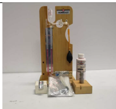
ภาพที่ 44 ชุดทดสอบความละเอียดของปูนซีเมนต์ (Blain air-permeability apparatus)
