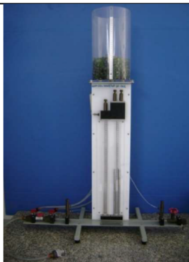
ภาพที่ 7 ชุดทดลองหาความเสียดทานในท่อ (Pipe Friction Apparatus)
