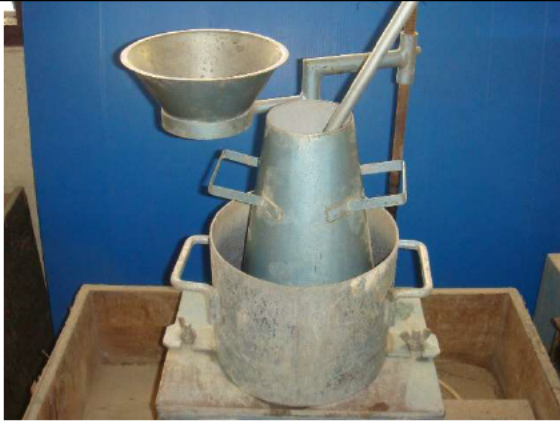
ภาพที่ 33 เครื่องทดสอบหาเวลาวีบี (V-B Consistometer)
