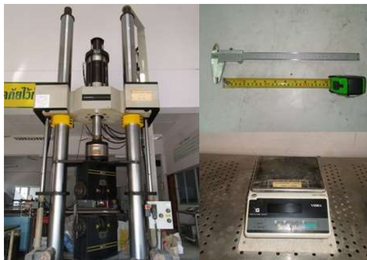
อุปกรณ์สำหรับการทดสอบการรับแรงดึงของเหล็กเสริมคอนกรีต
