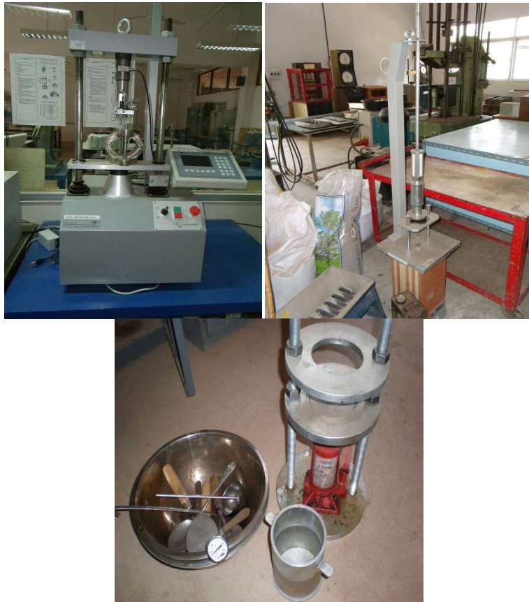
อุปกรณ์การทดสอบความต้านทานการไหลโดยวิธีมาแชลล์
