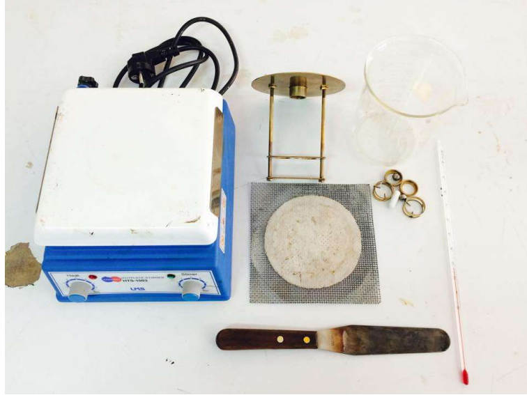
การทดสอบจุดอ่อนตัวของวัสดุปิทูเมนโดยใช้เครื่องวงแหวนกับลูกปืน
