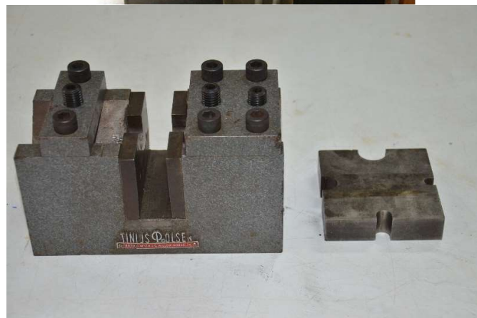
อุปกรณ์สำหรับการทดสอบแรงเฉือนของสลักเกลียว
