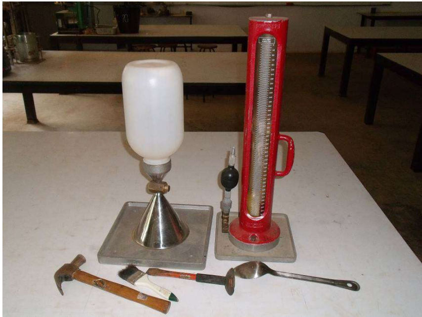
อุปกรณ์การทดสอบหาความหนาแน่นของดินในสนาม
