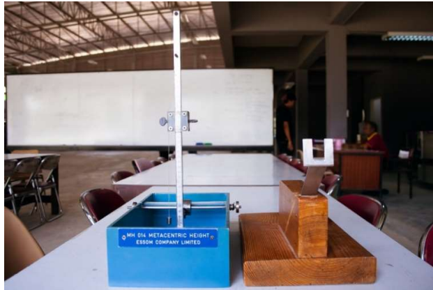
การหาความสูงเมตราเซนตริกและเสถียรภาพของการลอยตัว
