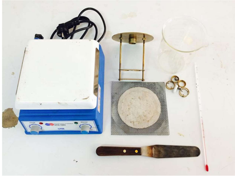
อุปกรณ์สำหรับการทดสอบจุดอ่อนตัวของวัสดุพิวเมนโดยใช้เครื่องวงแหวนกับลูกปืน
