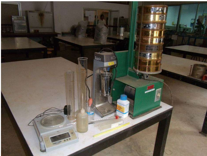
อุปกรณ์การทดสอบหาการกระจายขนาดคละของเม็ดดิน
