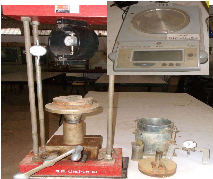
อุปกรณ์การทดสอบหาค่าแคลิฟอร์เนียแบริงเรโซ
