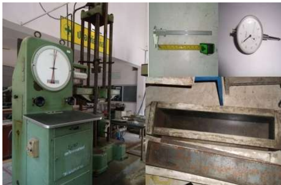
อุปกรณ์สำหรับการแรงดัดของคานคอนกรีต
