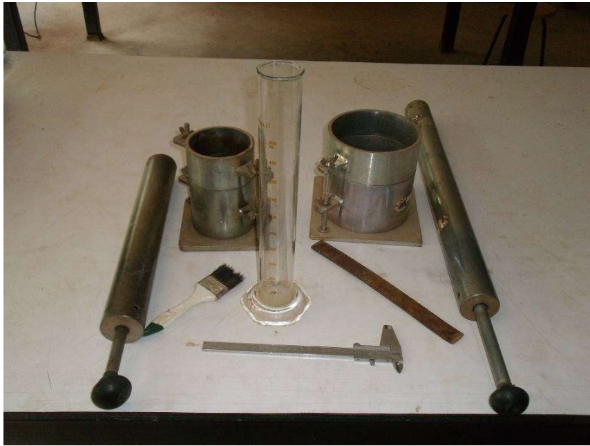
อุปกรณ์การทดสอบหาการบดอัดในห้องปฏิบัติการ
