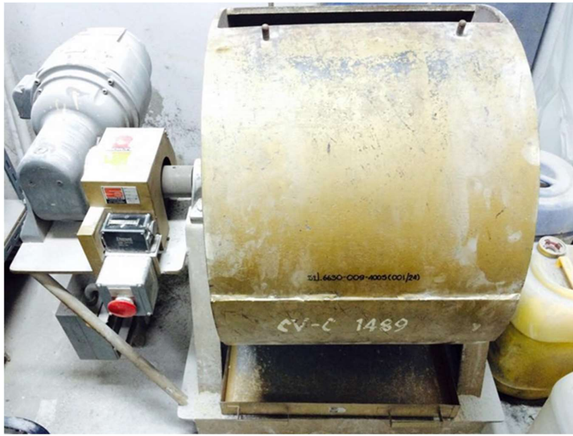
การทดสอบหาค่าการสึกหรอของวัสดุผสมรวมหยาบโดยเครื่อง Los Angeles
