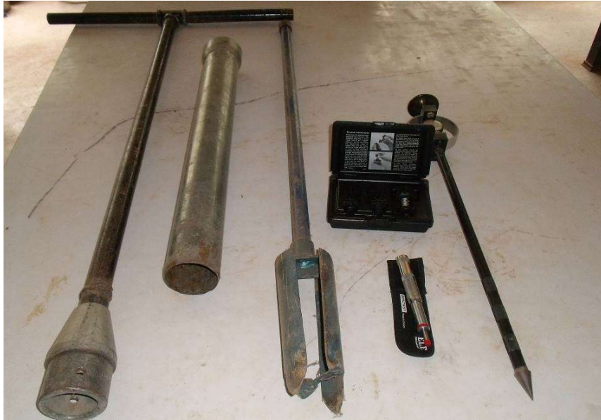
อุปกรณ์การสำรวจชั้นดิน
