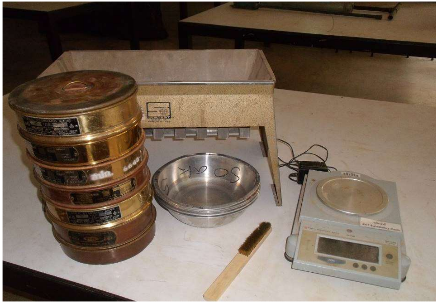
อุปกรณ์การทดสอบหาขนาดเม็ดของวัสดุโดยผ่านตะแกรงแบบไม่ล้าง
