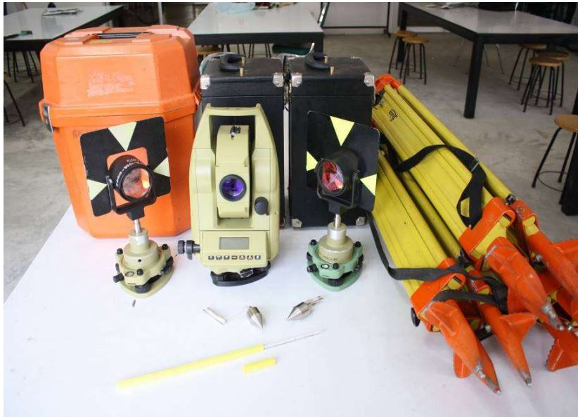
อุปกรณ์สำหรับการวัดระยะทางด้วยเครื่องมืออิเล็กทรอนิกส์
