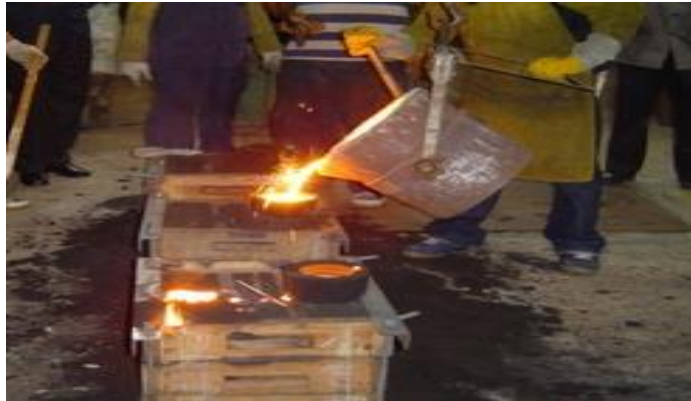
ภาพที่ 41 โรงฝึกปฏิบัติงานหล่อโลหะ (การปฏิบัติการเทน้ำโลหะเข้าในแบบหล่อขึ้นงาน)
