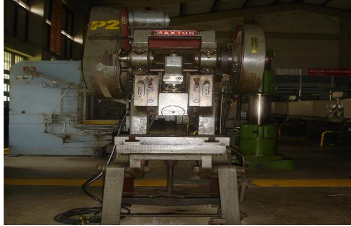
ภาพที่ 93 ห้องปฏิบัติงาน Punch and Die (เครื่องปั๊มโลหะ)
