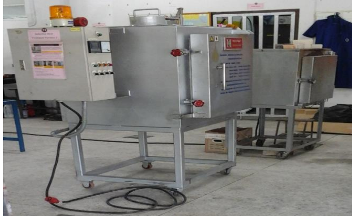
ภาพที่ 33 ห้องปฏิบัติการงานอบชุบโลหะ (เตาอบให้ความร้อน)
