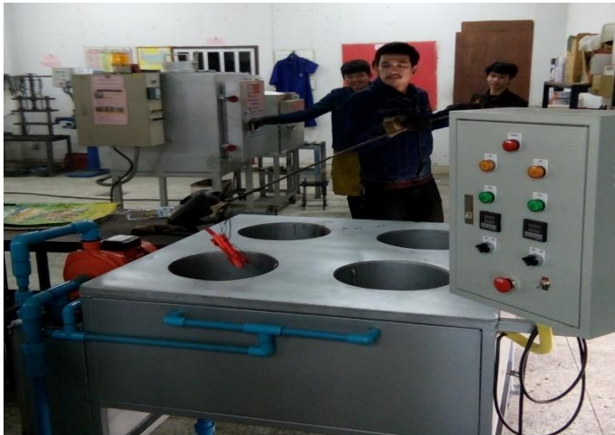
ภาพที่ 35 ห้องปฏิบัติการงานอบชุบโลหะ (การปฏิบัติการงานอบชุบทางความร้อนชิ้นงานทดสอบ)
