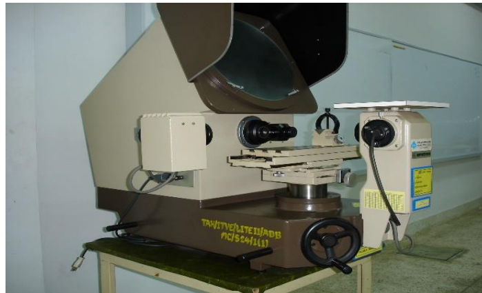
ภาพที่ 45 ห้องปฏิบัติการงานวัดละเอียด (Profile Projector)
