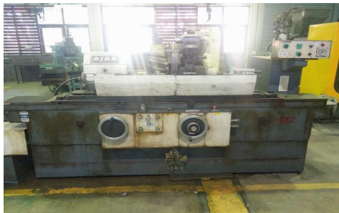
ภาพที่ 11 โรงฝึกปฏิบัติงานเครื่องมือกล 2 (งานเจียรระโนกลม)
