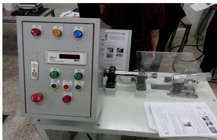
ภาพที่ 56 ห้องปฏิบัติการทดสอบสมบัติทางกลของวัสดุ (Fatigue Testing Machine 2)
