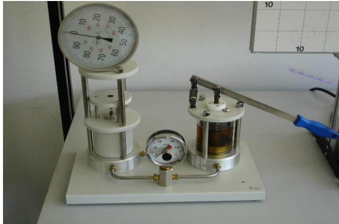
ภาพที่ 107 ห้องปฏิบัติงานทางฟิสิกส์ (ชุดทดสอบแรงดันของเหลว)
