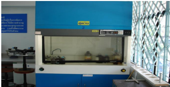
ภาพที่ 96 ห้องปฏิบัติการทางเคมี (ตู้ผสมกรดและสารเคมี)
