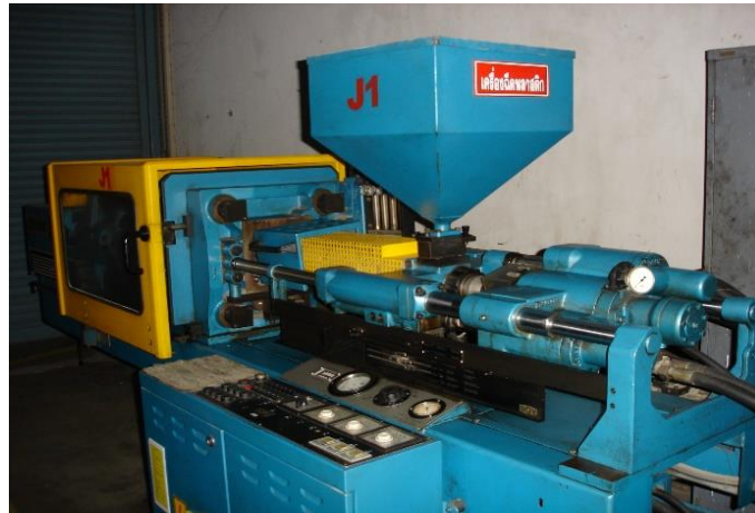
ภาพที่ 84 ห้องปฏิบัติการงานพลาสติก (เครื่องฉีดพลาสติก)
