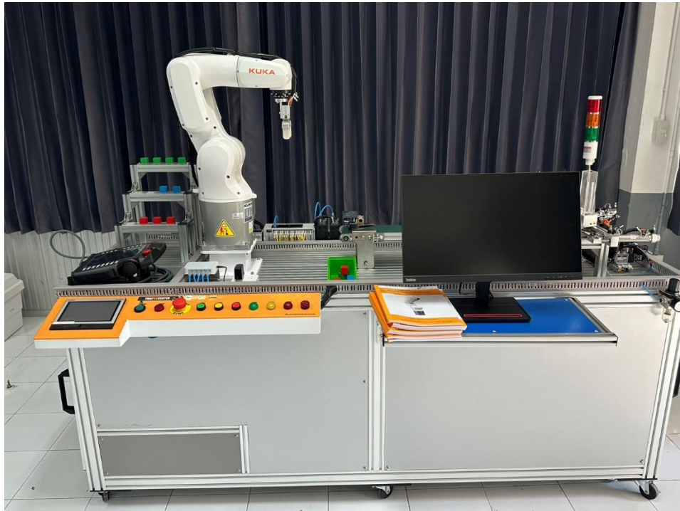
ภาพที่ 118 ชุดฝึกนวัตกรรมหุ่นยนต์และระบบโรงงานอัจฉริยะแบบอุตสาหกรรม 4.0
