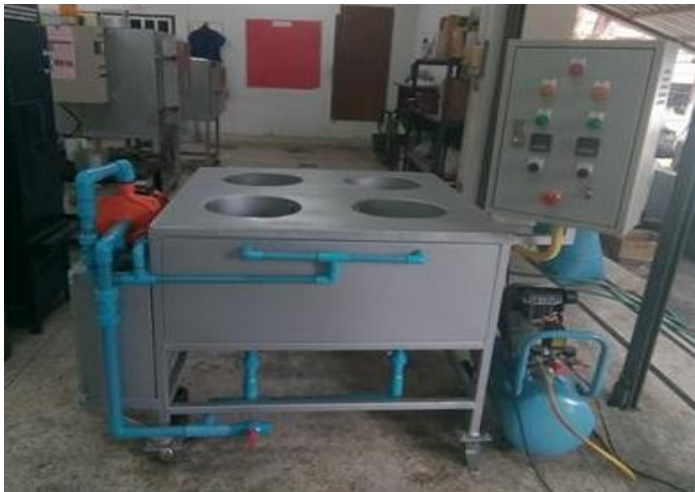
ภาพที่ 34 ห้องปฏิบัติการงานอบชุบโลหะ (ถังจุ่มชุบแข็งแบบควบคุมอุณหภูมิ)
