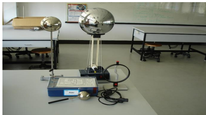
ภาพที่ 106 ห้องปฏิบัติงานทางฟิสิกส์ (อุปกรณ์จำลองการกำเนิดไฟฟ้าสถิต)
