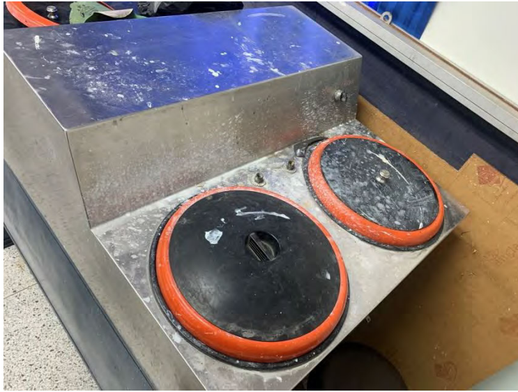
รูปที่ 50 เครื่องขัดชิ้นงานหยาบและละเอียด (Metallographic Polishing)
