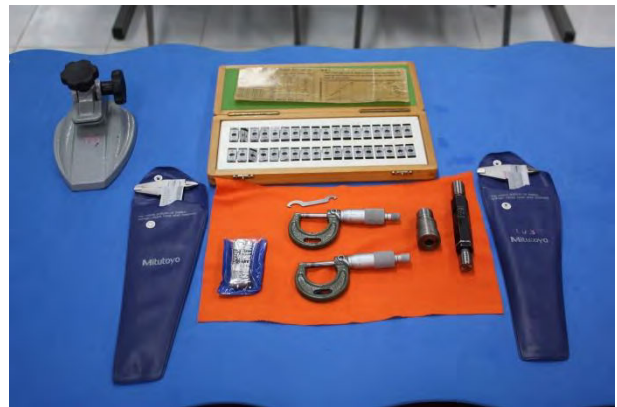
รูปที่ 96 อุปกรณ์วัดขนาดเกลียวนอก และไมโครมิเตอร์
