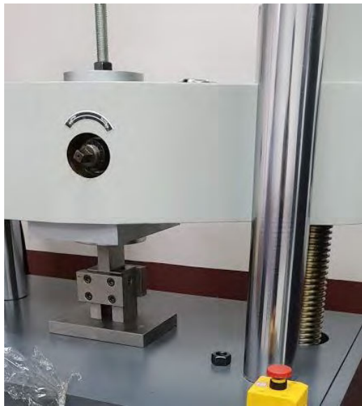
รูปที่ 34 เครื่องทดสอบแรงกดขนาด 100 ตัน ติดตั้งการทดสอบแรงเฉือน
