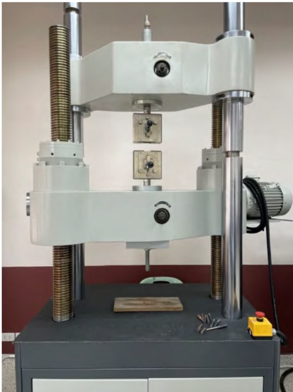
รูปที่ 32 เครื่องทดสอบอเนกประสงค์ ขนาด 100 ตัน ติดตั้งการทดสอบแรงดึง พร้อมคอมพิวเตอร์ควบคุม
