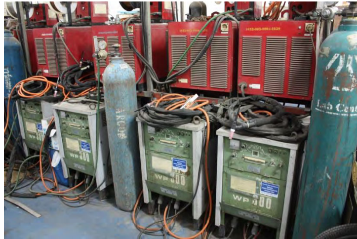
รูปที่ 26 เครื่องเชื่อมไฟฟ้าและเชื่อมแก๊ส
