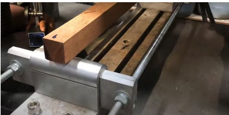
รูปที่ 35 แม่พิมพ์ใช้ติดตั้งสำหรับการทดสอบการบิด (Bending Test)
