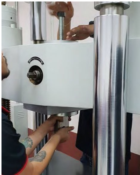
รูปที่ 34 เครื่องทดสอบแรงกดขนาด 100 ตัน ติดตั้งการทดสอบแรงเฉือน
