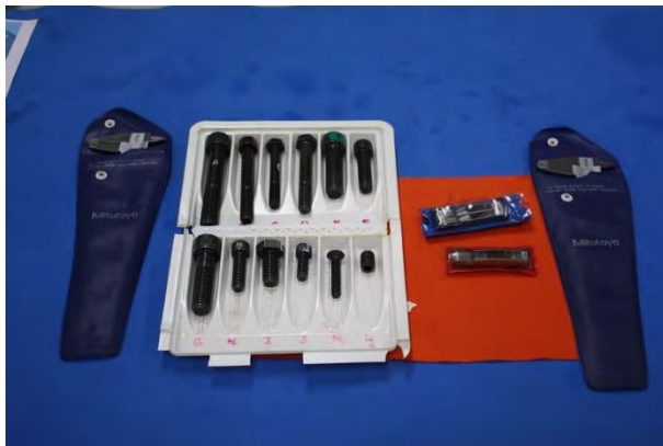
รูปที่ 96 อุปกรณ์วัดขนาดเกลียวนอก และไมโครมิเตอร์
