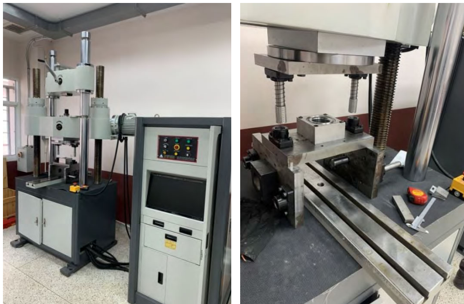
รูปที่ 12 เครื่องทดสอบแรงกดขนาด 100 ตัน ติดตั้งแม่พิมพ์
