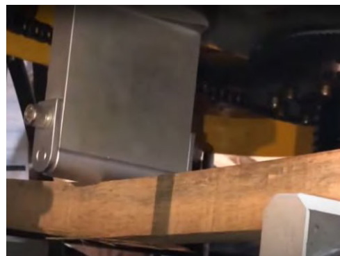
รูปที่ 35 แม่พิมพ์ใช้ติดตั้งสำหรับการทดสอบการบิด (Bending Test)
