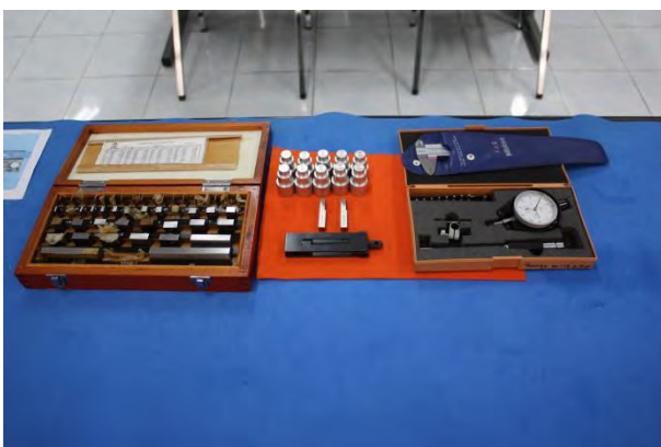
รูปที่ 94 เครื่องวัดอัลเกจ (Dial Gauge) วัดงานทรงกลม และไมโครมิเตอร์วัดลึก (Depth Micrometer)
