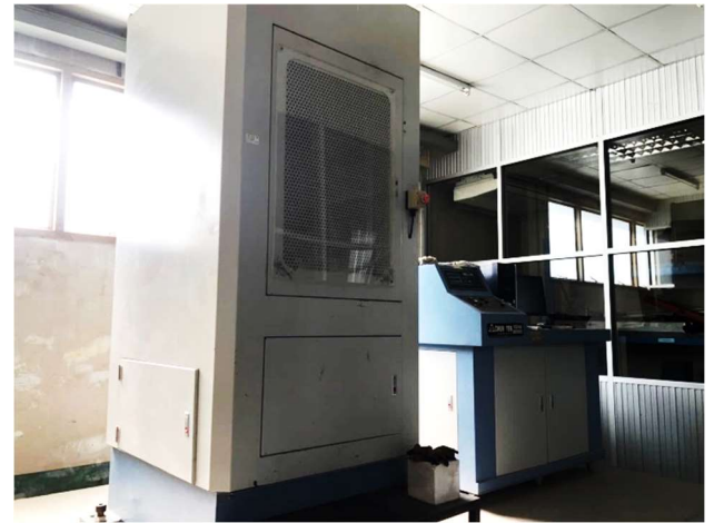
ชุดเครื่องวัดกำลังอัดของคอนกรีต (Compression Machine 5000 kN)
