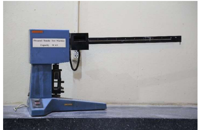
เครื่องทดสอบคุณสมบัติการดึงและการดัดของซีเมนต์มอร์ตาร์ (Flexural/Tensile Test Machine 10 kN)
