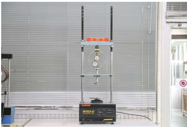
ชุดทดสอบแรงเฉือนแบบไม่ถูกจำกัด (Unconfined Compression Machine, Load Frame 10 kN)
