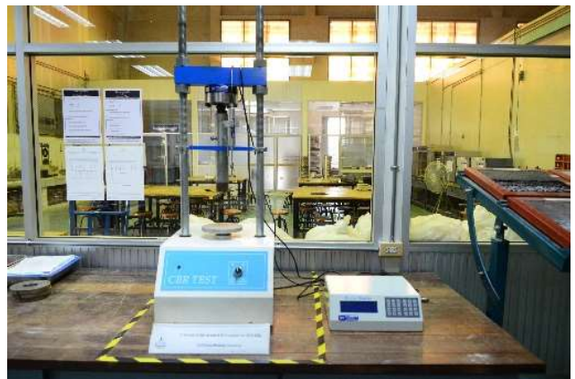
ชุดทดสอบหาค่าแคลิฟอร์เนียแบร์ริงเรโซ (C.B.R.)
