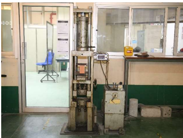
เครื่องทดสอบวัสดุยูนิเวอร์แซล (Universal Material Testing Machine 100 kN)
