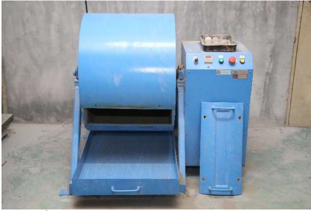
เครื่องทดสอบการสึกกร่อนจากการขัดสีของหิน
