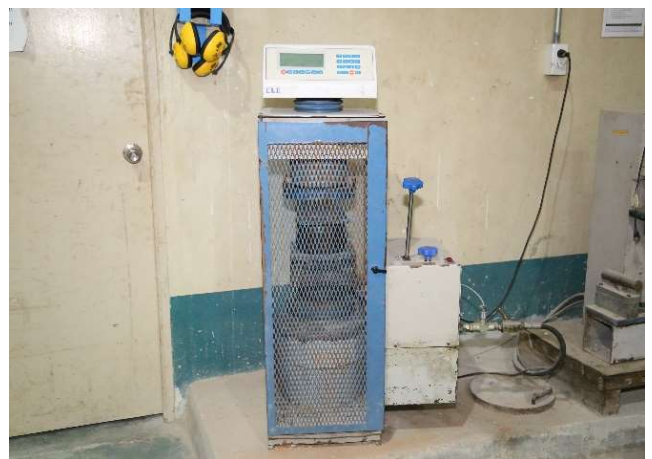
ชุดเครื่องวัดกำลังอัดของคอนกรีต (Compression Machine 2000 kN)
