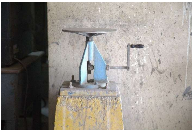
ชุดทดสอบคุณสมบัติการไหลของซีเมนต์มอร์ตาร์
