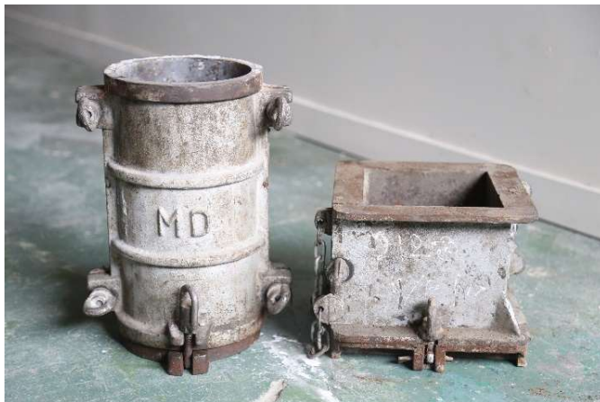
แบบหล่อคอนกรีต
