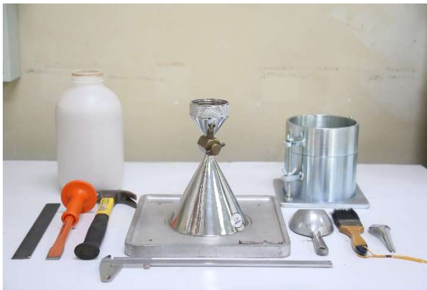
ชุดทดสอบหาค่าความหนาแน่นของดิน โดยวิธีกรวยทราย
