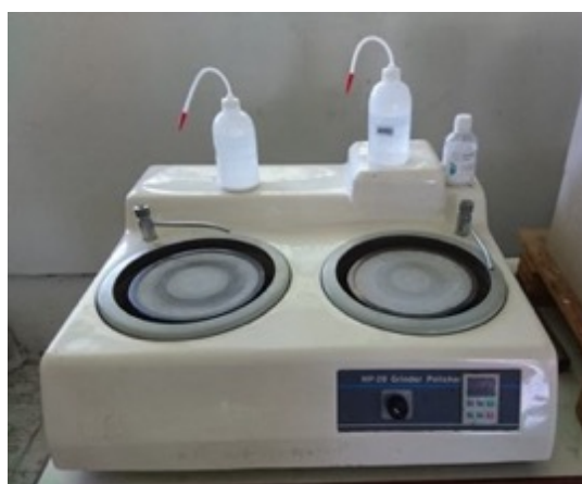
ภาพที่ 4.2 เครื่องขัดละเอียดจานหมุนแบบ 2 จาน
