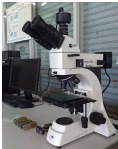
ภาพที่ 4.1 กล้องจุลทรรศน์ในการส่องดูโครงสร้างโลหะยี่ห้อ VSK
