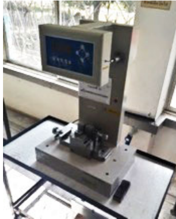
ภาพที่ 4.5 เครื่องทดสอบแรงกระแทกพลาสติกแบบ Charpy และ Izod
