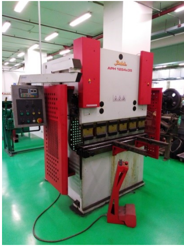
เครื่องพับโลหะแบบ Press Brake B11-400 ZONE A
