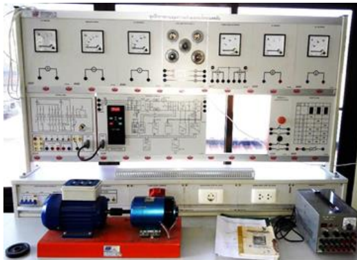
ภาพที่ 78 ชุดฝึกควบคุมความเร็วมอเตอร์กระแสสลับ (AC)
