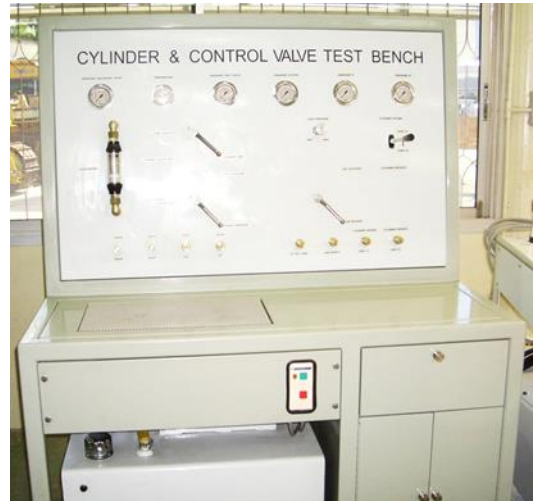
ภาพที่ 64 Hydraulics Cylinder & Valve Test
