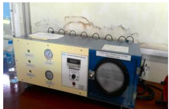
ภาพที่ 73 Refrigeration Unit
