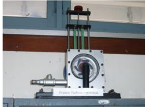
ภาพที่ 58 Pelton & Francis Turbine Set
