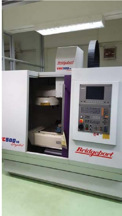
คำอธิบาย : เครื่องจักรกลซีเอ็นซีสามแนวแกน
