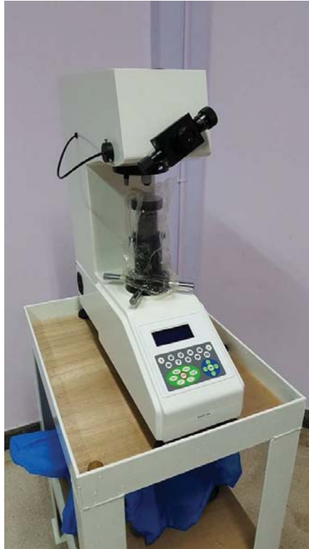
คำอธิบาย : เครื่องทดสอบความแข็งแบบ Vicker
