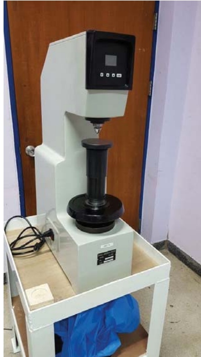
คำอธิบาย : เครื่องทดสอบความแข็งแบบ Brinell
