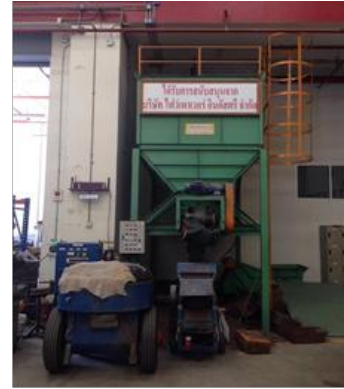
F: ซังเก็บทราย (The Sand Storage Silo)
