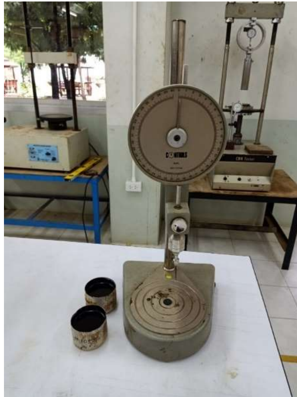
อุปกรณ์ทดสอบหาค่าการทะลวง (Penetration Test)
