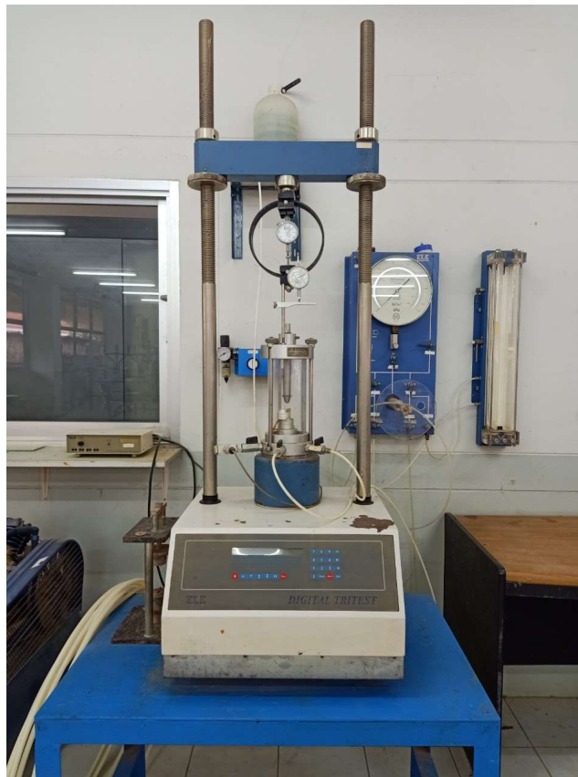
อุปกรณ์ทดสอบหาความต้านทานแรงเฉือนโดยวิธีอัดสามแกน (Triaxial Compression Test)
