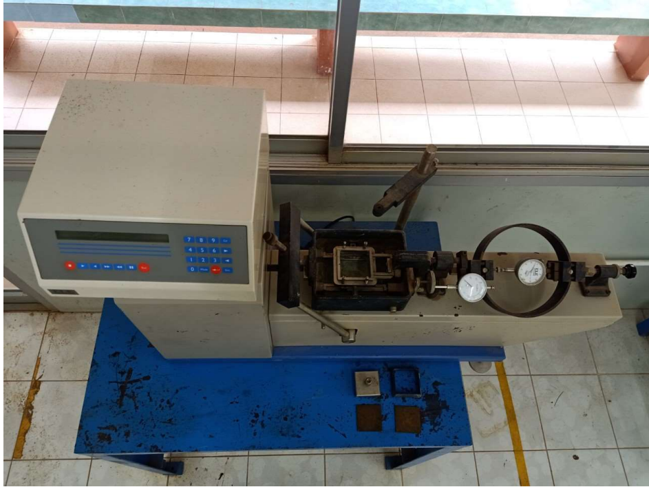
อุปกรณ์ทดสอบหาความต้านทานแรงเฉือนโดยวิธีแรงเฉือนตรง (Direct Shear Test)
