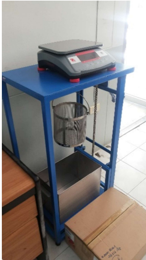
เครื่องมือทดสอบความถ่วงจำเพาะ การดูน้ำของมวลรวม
