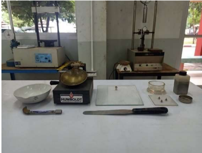
อุปกรณ์ทดสอบหาค่าพิกัตต์เทอร์เบอร์ก (Atterberg's Limit)
