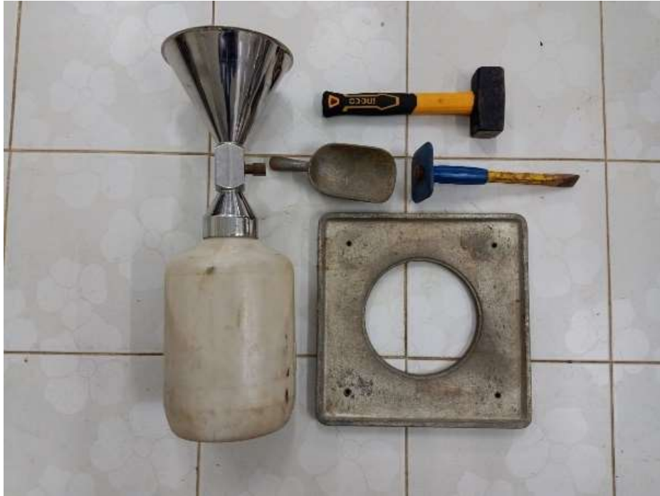
อุปกรณ์ทดสอบการแทนที่ด้วยทราย (Sand Replacement)
