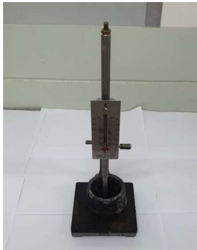
เครื่องมือทดสอบปริมาณน้ำที่เหมาะสมและระยะเวลาการก่อตัวของปูนซีเมนต์
