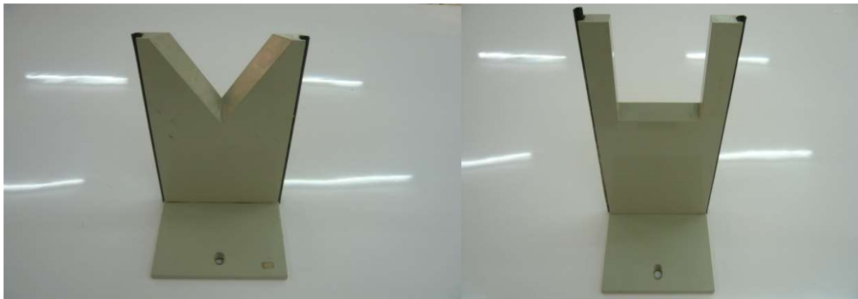
อุปกรณ์ทดลองการไหลผ่านร่องบาก (Flow Over a Notch)
