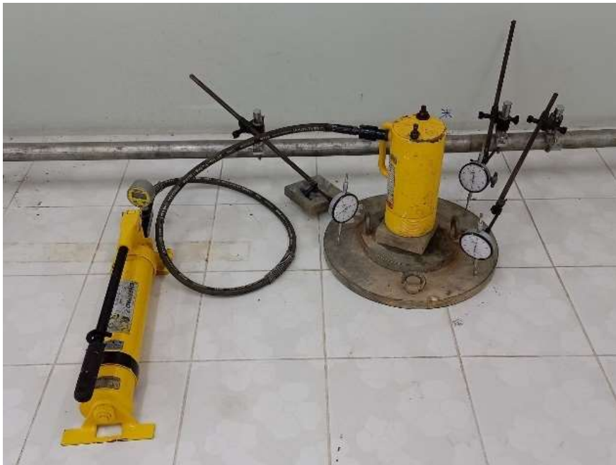
อุปกรณ์ทดสอบการรับน้ำหนักของดิน (Plate Bearing Test)
