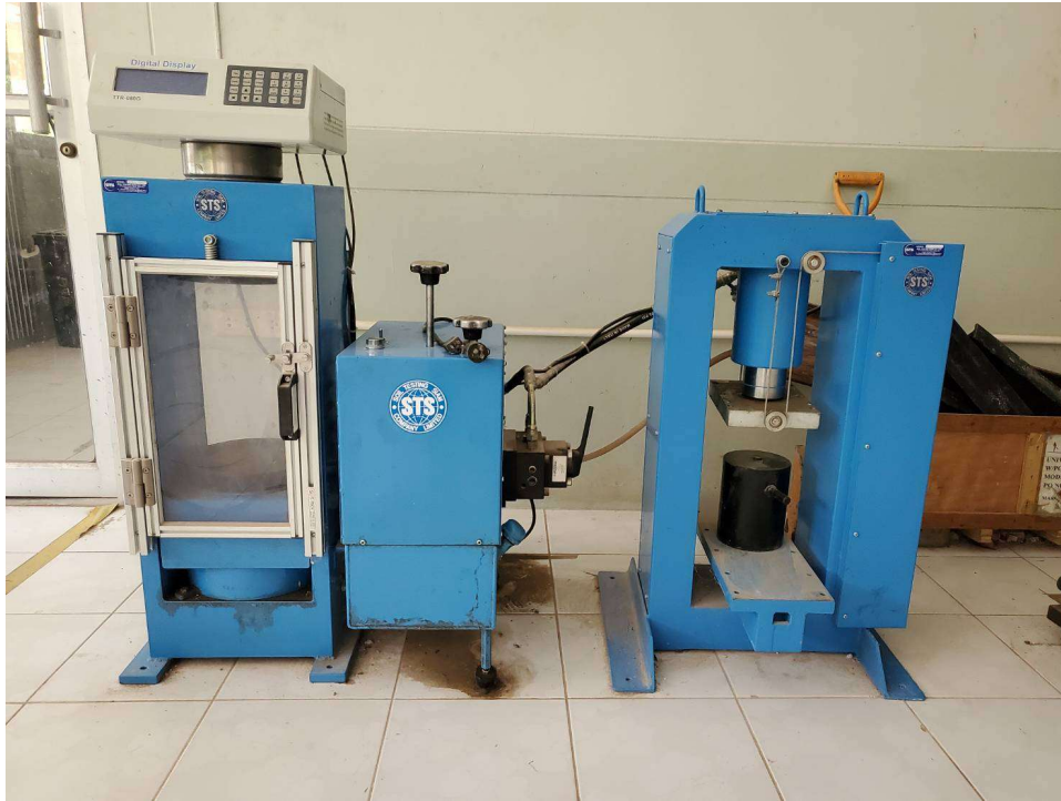
เครื่องมือทดสอบกำลังอัด และกำลังดึงผ้าซีกของตัวอย่างคอนกรีต
