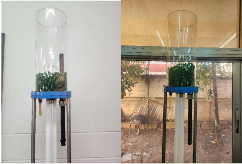
อุปกรณ์ทดลองหาออสบอร์นเรย์โนลด์ (Osborne Reynolds Apparatus)
