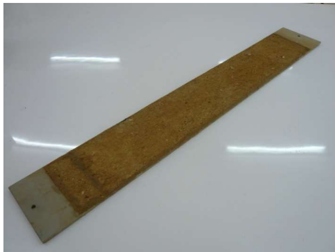
อุปกรณ์ศึกษาค่าสัมประสิทธิ์ความขรุขระ (Corrugated Bed)
