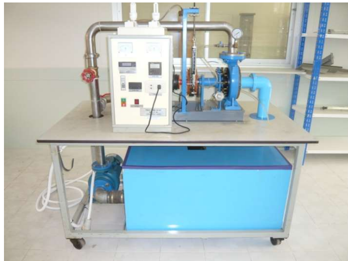
เครื่องมือหาคคุณลักษณะของฟรานซิสเทอร์ไบน์ขนาดเล็ก (Francis Turbine)
