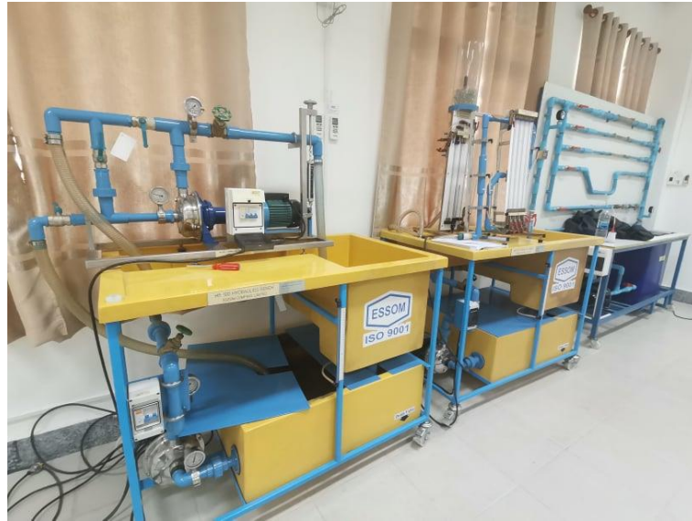
รูปที่ 69 ชุดทดสอบปั๊มน้ำแบบอนุกรมและแบบขนาน, แบบความเร็วคงที่
