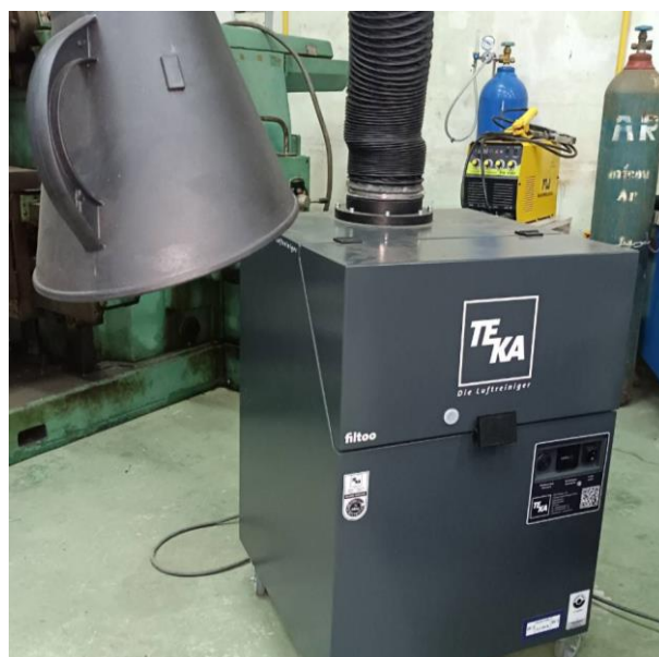
รูปที่ 23 เครื่องดูดควันเชื่อมแบบเคลื่อนย้าย
