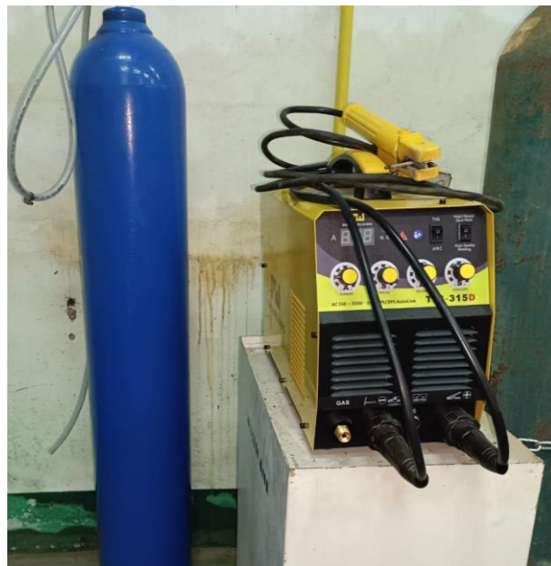
รูปที่ 25 เครื่องเชื่อมไฟฟ้าระบบอินเวอร์เตอร์+ทิก
