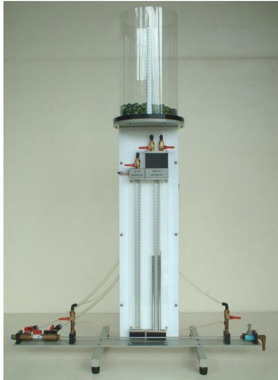
รูปที่ 63 อุปกรณ์วัดแรงเสียดทานภายในท่อ
