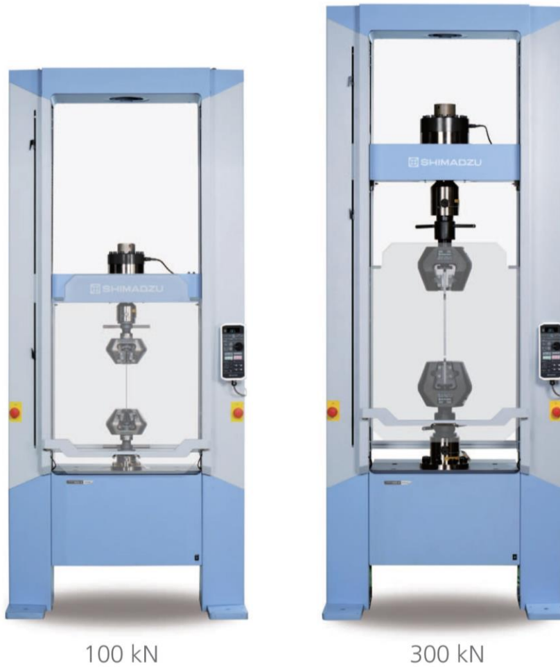
รูปที่ 110 (ต่อ) เครื่องทดสอบวิเคราะห์ความแข็งแรงของวัสดุขนาด 100 kN (UTM)
