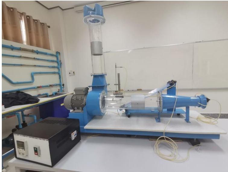
รูปที่ 65 ชุดทดสอบปั๊มแบบหมุนเหวี่ยง (Compact centrifugal fan test)
