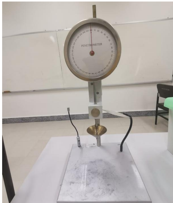
รูปที่ 66 เครื่องมือหาค่าความอ่อนแข็งของจาระบี (Penetrometer)
