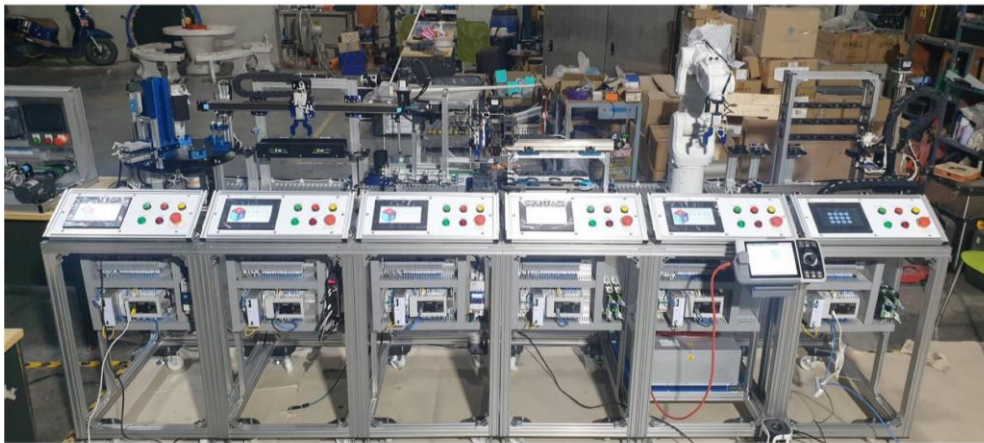
↑ station 1 สถานีผลิตชิ้นรูปชิ้นงานวัสดุ ↑ station 2 สถานีลำเลียงงานด้วยระบบลม ↑ station 3 สถานีตรวจสอบชิ้นงานด้วยกล้อง (Vision) ↑ station 4 สถานีคัดแยก และจัดเก็บชิ้นงาน ↑ station 5 สถานีเคลื่อนย้ายชิ้นงานด้วยแขนกลอัตโนมัติ ↑ station 6 สถานีจัดเก็บและนำออกคลังสินค้าแบบชิ้น
