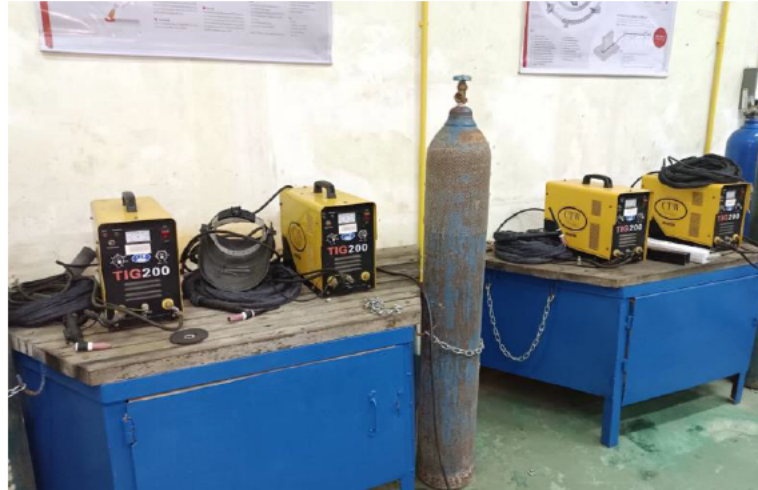
รูปที่ 9 เครื่องเชื่อมทิกระบบอินเวอร์เตอร์
