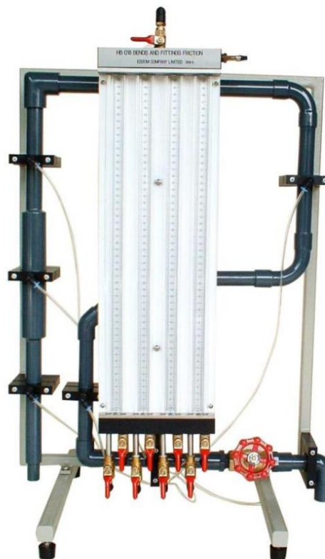
รูปที่ 64 อุปกรณ์วัดความเสียดทานในข้องอและข้อต่อท่อ
