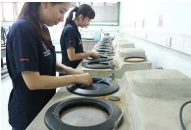
เครื่องขัดผิวโลหะ Metkon FORCIPOL 2V
