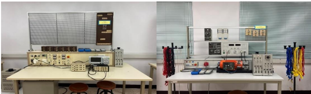
ชุดการทดลองมอเตอร์ไฟฟ้าเหนี่ยวนำ 3 เฟส และคุณสมบัติ T-S ของมอเตอร์ไฟฟ้า
