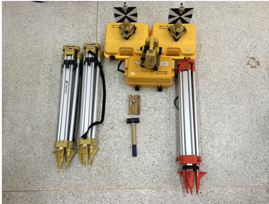
กล้องวัดมุม (Theodolite) เป้าเล็ง ลูกดิ่ง ค้อนปอนด์และหมุดไม้
