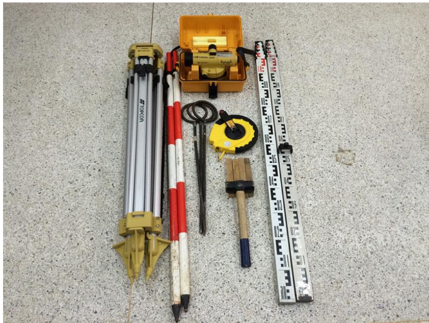
กล้องระดับ (Auto Level) ไม้ระดับ 3 - 4 เมตร หมุดไม้ ค้อนปอนด์ เทปวัดระยะและเหล็กเส้นแนว
