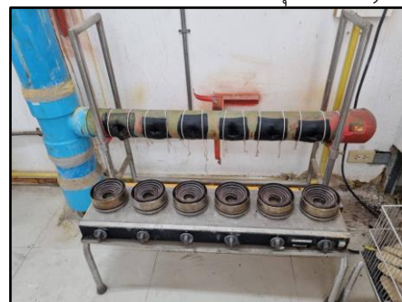
เครื่องย่อยไนโตรเจน ยี่ห้อ Gerhard Bonn รุ่น KI 26
