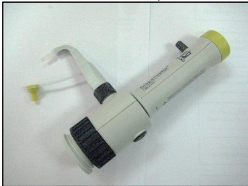
เครื่องดูดสารอันตราย ยี่ห้อ Brand รุ่น 4730140
