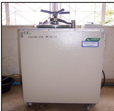
เครื่องนิ่งแรงดันไอน้ำ ยี่ห้อ Sturdy รุ่น SA-300VF
