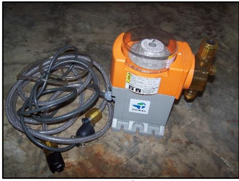
เครื่องสุบสารเคมี (ปั๊มไดอะแฟรม) ยี่ห้อ Pacmina รุ่น NCS-22-VFC-SW
