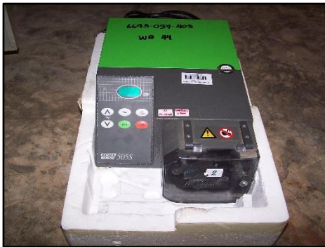
Peristaltic Pump Variable Speed ยี่ห้อ Watson Malow รุ่น 505 S
