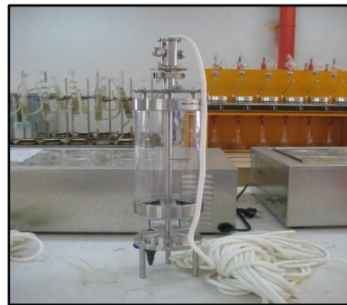
เครื่องเก็บตัวอย่างน้ำขนาด 2 ลิตร ยี่ห้อ T-Science รุ่น WS-1000VS
