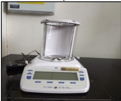
เครื่องชั่งละเอียด 5 ตำแหน่ง ยี่ห้อ Precisa/Switzerland รุ่น ES125SM
