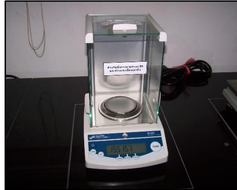
เครื่องชั่งละเอียด 4 ตำแหน่ง ยี่ห้อ Denver รุ่น IS-234
