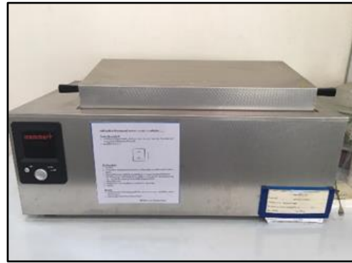
อ่างน้ำควบคุมอุณหภูมิ ยี่ห้อ Memmert รุ่น WNB45
