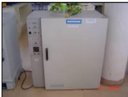
ตู้อบอุณหภูมิ 30 - 80 องศาเซลเซียส ยี่ห้อ Gallen Kamp
