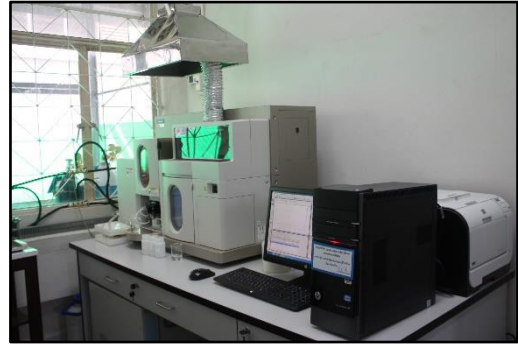
เครื่องวิเคราะห์โลหะหนัก ยี่ห้อ Hitachi รุ่น Z-2000
