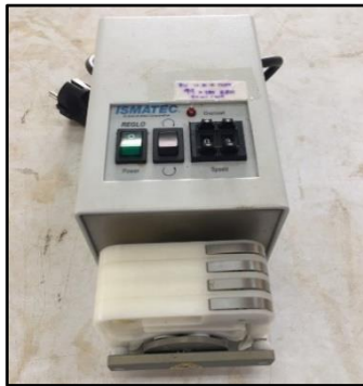
เครื่องสูบน้ำแบบบริด ยี่ห้อ ISMATEC รุ่น ISM8288
