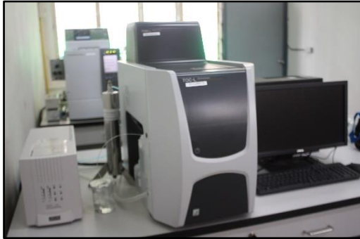
เครื่องวิเคราะห์สารอินทรีย์คาร์บอนทั้งหมด ยี่ห้อ shimadzu รุ่น TOC-L CPH
