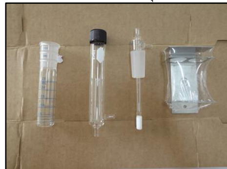
อุปกรณ์เก็บก๊าซ ทำด้วยแก้ว ยี่ห้อ SKC รุ่น Impingers
