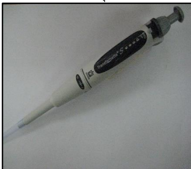
ปิเปตอัตโนมัติ (1 ชุดมี 3 ขนาด) 10,100,1000 ไมโครลิตร
