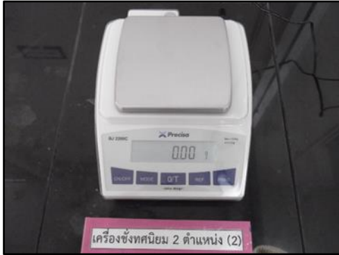
เครื่องชั่งทศนิยม 2 ตำแหน่ง ยี่ห้อ Precisa รุ่น BJ 2200C
