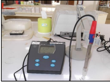
เครื่องวัดความเป็นกรดต่าง ยี่ห้อ QIS รุ่น B210T
