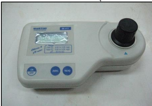
เครื่องวัดปริมาณคลอรีน ยี่ห้อ Martini Instrument
