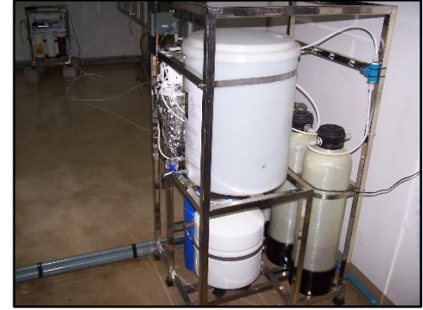
เครื่องทำน้ำกลั่นแบบรีเวอร์สออสโมซิส พร้อมถังเก็บ 50 ลิตร
