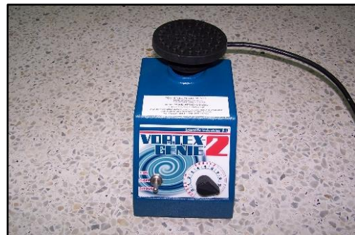
เครื่องผสมสารชนิดน้ำหมุนวน ยี่ห้อ Vortex รุ่น G560
