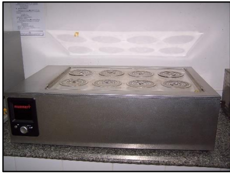
อ่างน้ำควบคุมอุณหภูมิ ยี่ห้อ Memmert รุ่น WNB29
