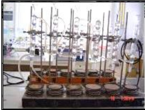
เครื่องวิเคราะห์ ซีไอดี (แบบเปิด) ยี่ห้อ Gerhard Bonn รุ่น EV 16
