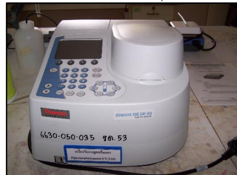
เครื่องวัดการดูดกลืนแสงแบบ UV-Vis ยี่ห้อ Thermo Fisher Scientific รุ่น Genesys 10S
