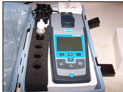
เครื่องวัดความขุ่น ยี่ห้อ HACH
