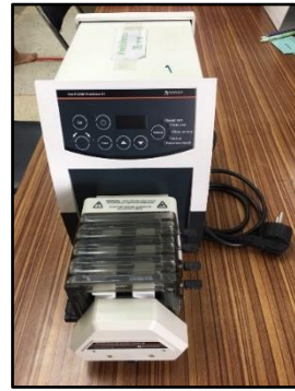
ปั๊มสารเคมีแบบลูกรีด ยี่ห้อ Heidolph รุ่น Hei-FLOW Precision
