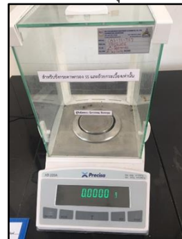
เครื่องชั่งไฟฟ้าทศนิยม 4 ตำแหน่ง ยี่ห้อ Precisa รุ่น XB22A
