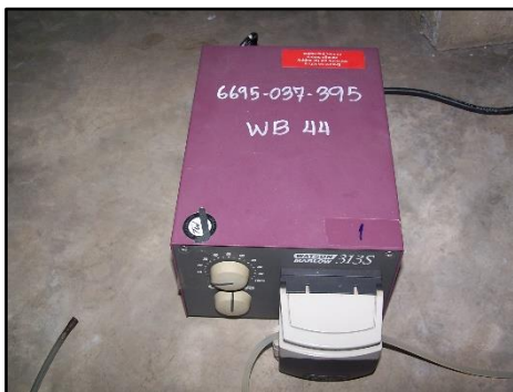
Low Speed Peristal Pump ยี่ห้อ Watson Malow รุ่น 313 S
