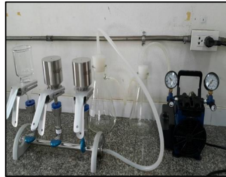
ปั๊มสุญญากาศ พร้อมชุดกรวยกรอง แบบ 3 หัว ยี่ห้อ Millipore
