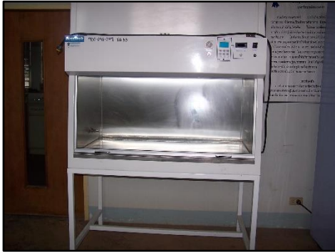
ตู้ปลอดเชื้อ laminar Flow Cabinet ยี่ห้อ Bosstech รุ่น HVBT120SE
