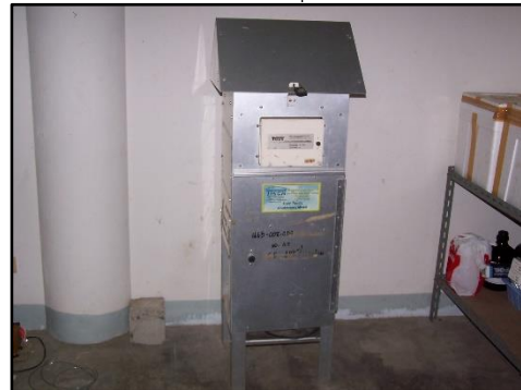
เครื่องเก็บฝุ่นละอองรวม (TSP) ยี่ห้อ Tisch environmental รุ่น TE-5170132
