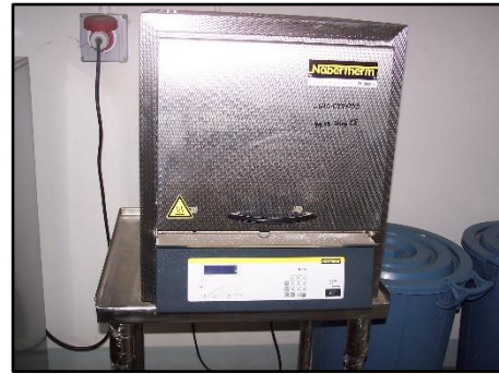
เตาเผาอุณหภูมิสูง 1300 องศาเซลเซียส ยี่ห้อ Natterthern รุ่น B180
