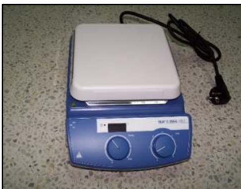
เครื่องผสมสารด้วยแรงแม่เหล็กไฟฟ้าแบบให้ความร้อน ยี่ห้อ IKA รุ่น C-MAGHS 7
