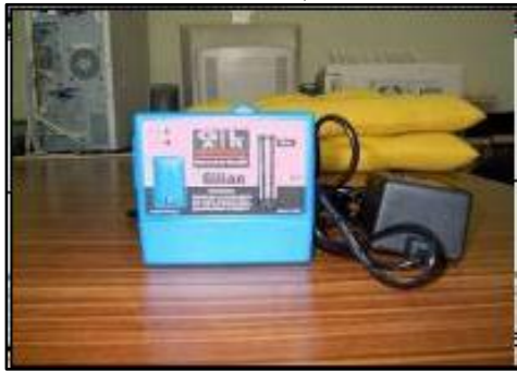
เครื่องเก็บตัวอย่างฝุ่นจากบุคคล ยี่ห้อ SKC รุ่น PCXR8
