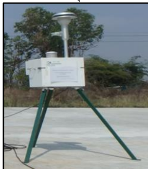
เครื่องเก็บตัวอย่างฝุ่นขนาดเล็กกว่า 2.5 ไมครอน พร้อมอุปกรณ์ ยี่ห้อ BGI รุ่น PQ200
