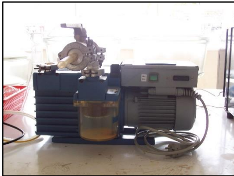
ปั๊มสุญญากาศและชุดหัวกรองสแตนเลส ยี่ห้อ Vacuum brand รุ่น RE - 8
