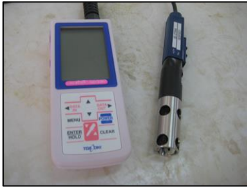
เครื่องวัดออกซิเจนละลายน้ำ ยี่ห้อ TOA รุ่น DO-31P
