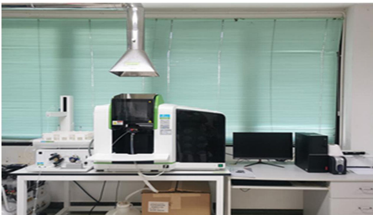
รูปที่ 6 เครื่อง Atomic Absorption Spectroscopy (AAS) ห้องปฏิบัติการ1 อาคาร EN14
