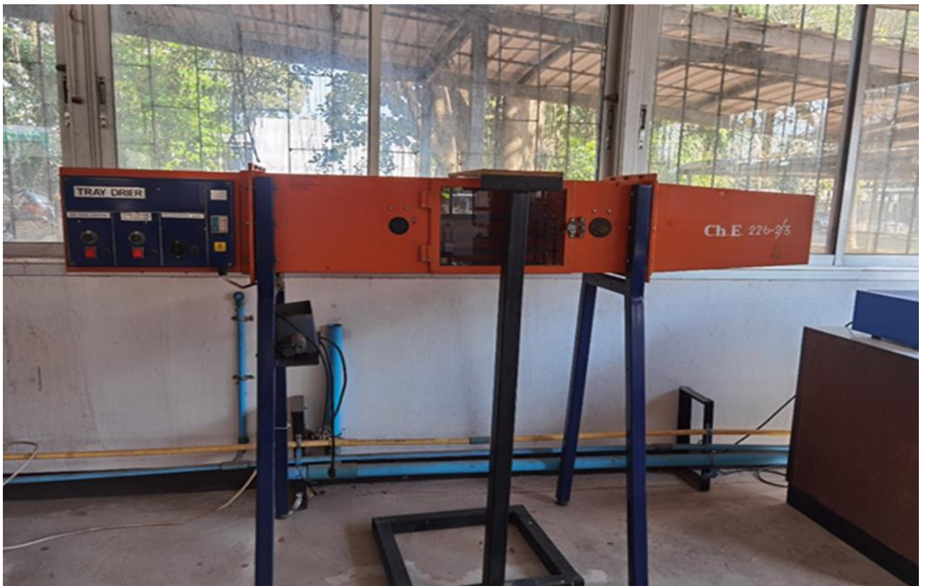
รูปที่ 8 เครื่อง Tray Dryer ห้อง Workshop อาคาร EN14
