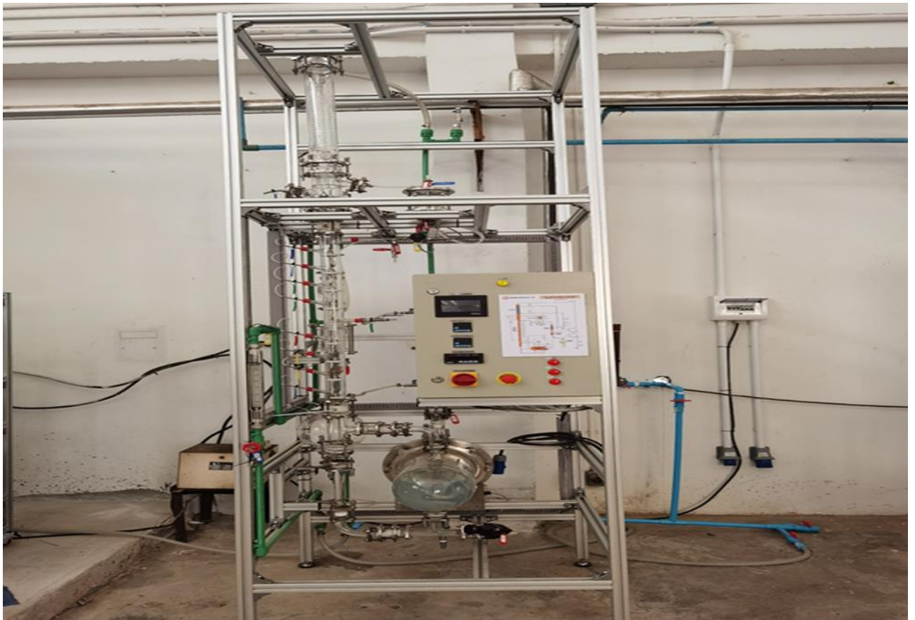
รูปที่ 7 เครื่อง Batch Distillation ห้อง Workshop อาคาร EN14
