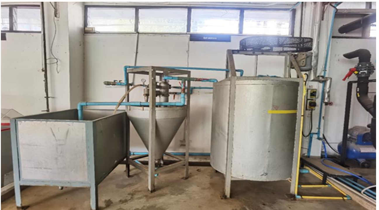
รูปที่ 6 เครื่อง Hydro cyclone ห้อง Workshop อาคาร EN14
