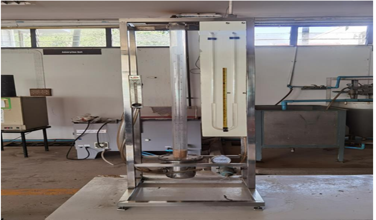
รูปที่ 5 เครื่อง Fluidization ห้อง Workshop อาคาร EN14
