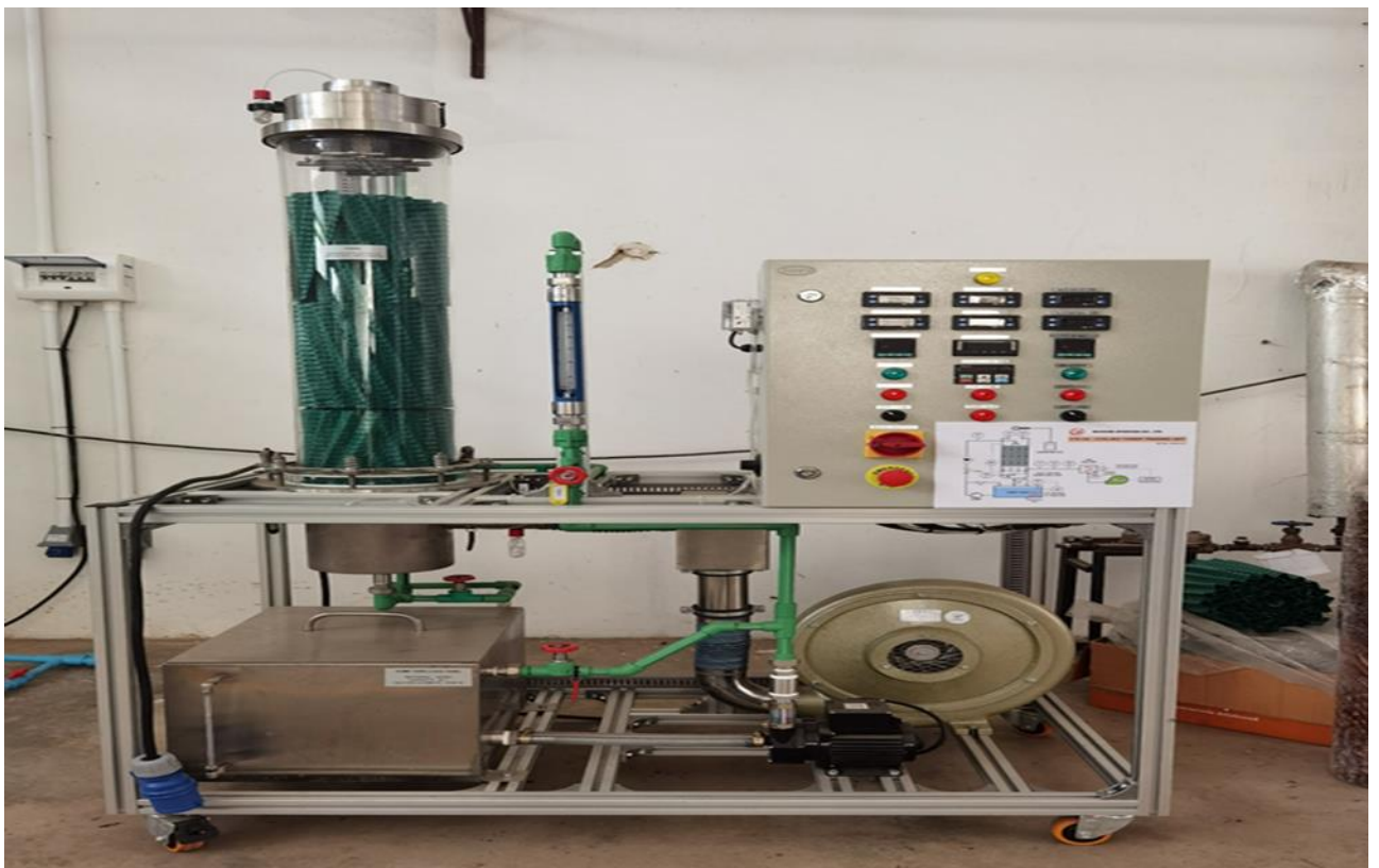
รูปที่ 2 เครื่อง Cooling Tower ห้อง Workshop อาคาร EN14
