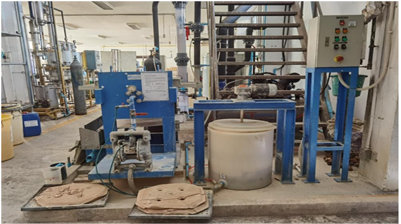
รูปที่ 3 เครื่อง Plate and frame (Filter Press) ห้อง Workshop อาคาร EN14
