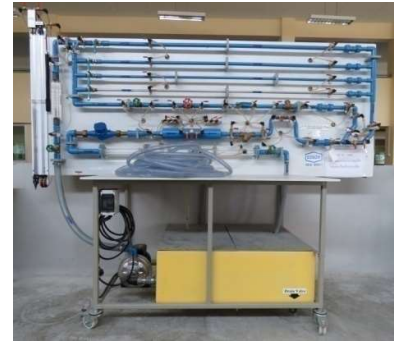
ภาพที่ 4 เครื่องทดสอบหาการสูญเสียในระบบปิด (Piping Loss test)
