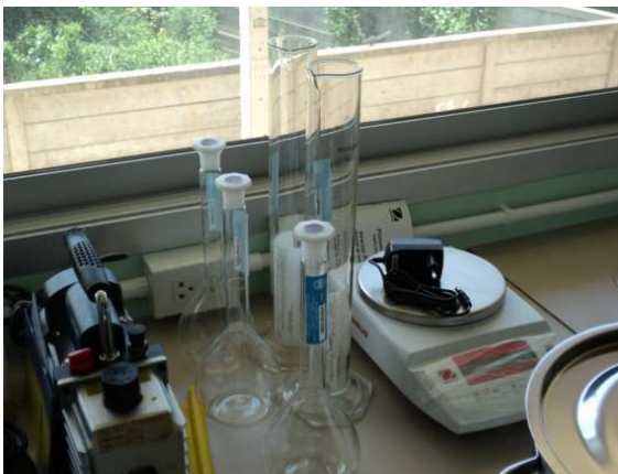
ภาพที่ 1 ชุดทดสอบหาค่าความถ่วงจำเพาะของซีเมนต์
