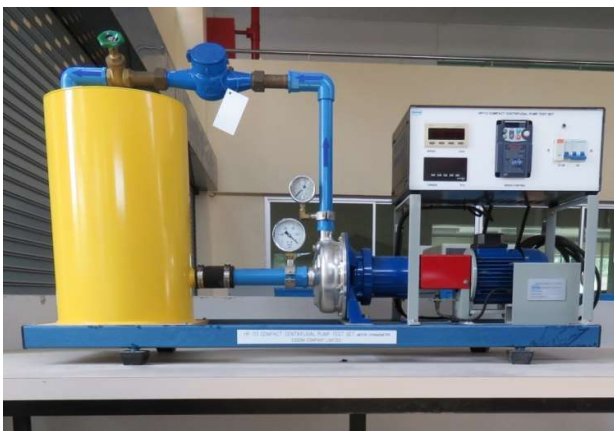
ภาพที่ 5 ชุดวัดประสิทธิภาพปั๊มหอยโข่ง (Centrifugal pump test)
