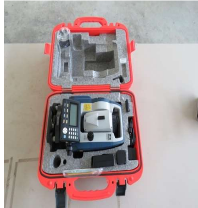
ภาพที่ 9 กล้องสำรวจแบบประมวลผล (SOKKIA CX-105 Dual Display Accuracy 5")
