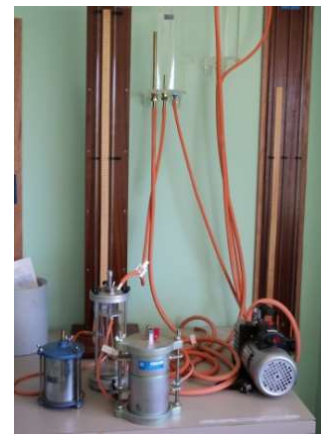
ภาพที่ 6 ชุดทดสอบแคลิฟอร์เนียแบริงเรโซ (C.B.R.) แบบใช้ไฟฟ้า
