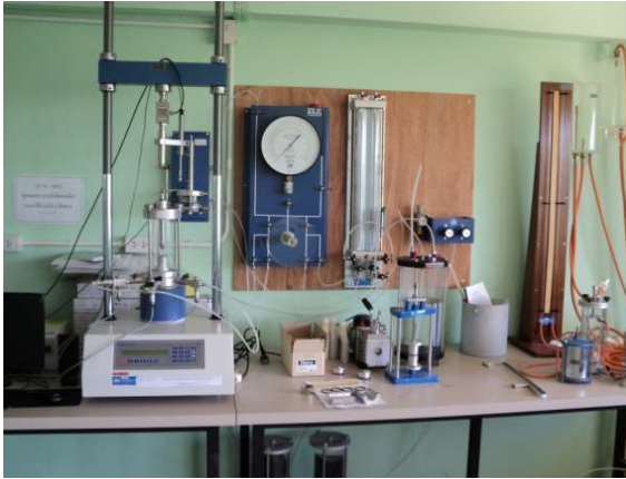
ภาพที่ 11 ชุดทดสอบ Triaxial Test
