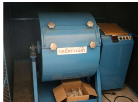
ภาพที่ 6 ชุดทดสอบความต้านทานการสึกกร่อนของวัสดุมวล รวม
