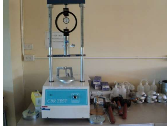
ภาพที่ 6 ชุดทดสอบแคลิฟอร์เนียแบริงเรโซ (C.B.R.) แบบใช้ไฟฟ้า
