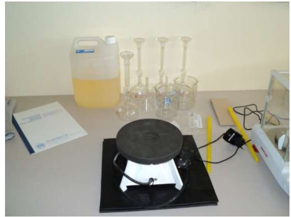
ภาพที่ 4 ชุดทดสอบหาค่าความถ่วงจำเพาะของมวลรวม ละเอียด
