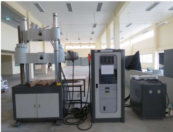
ภาพที่ 1 เครื่องทดสอบ Universal Testing Machine (100 T)
