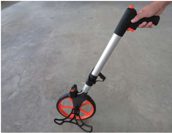
ภาพที่ 1 ล้อวัดระยะทาง (Roto-Sure รูน Classique Professional)
