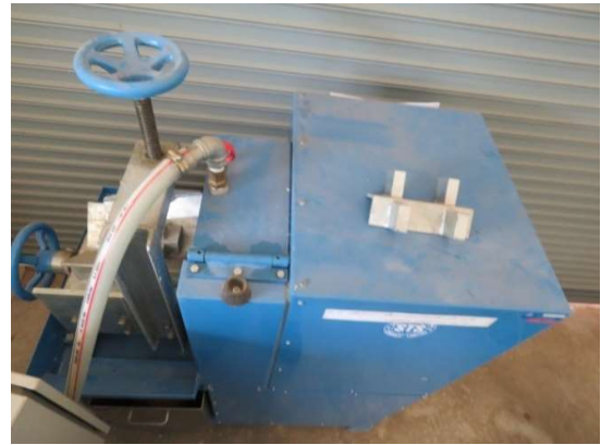
ภาพที่ 4 เครื่องเจียรผิวก้อนตัวอย่างคอนกรีตทดสอบแรงอัด
