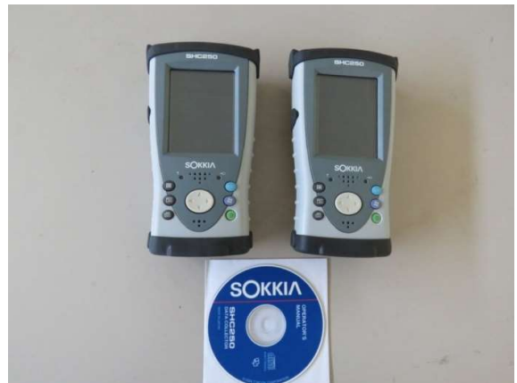
ภาพที่ 15 Data Controller ใช้งานร่วมกับเครื่องรับ สัญญาณดาวเทียม (Sokkia SHC 250)
