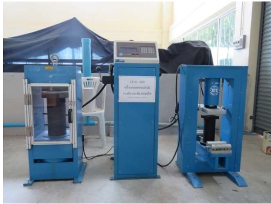
ภาพที่ 3 เครื่องทดสอบแรงอัดและแรงดึงของคอนกรีต
