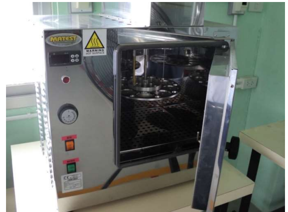
ภาพที่ 8 ชุดทดสอบหาความสูญเสียเมื่อได้รับความร้อน
