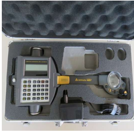
ภาพที่ 13 เครื่องมือวัดพื้นที่รูปแปลงแผนที่ (Planimeter) (USHIKATA รุ่น 460 F)
