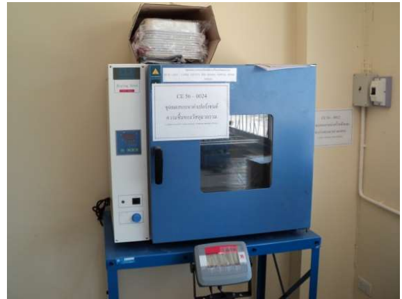
ภาพที่ 14 ชุดทดสอบหาค่าเปอร์เซ็นต์ความชื้นของวัสดุมวลรวม
