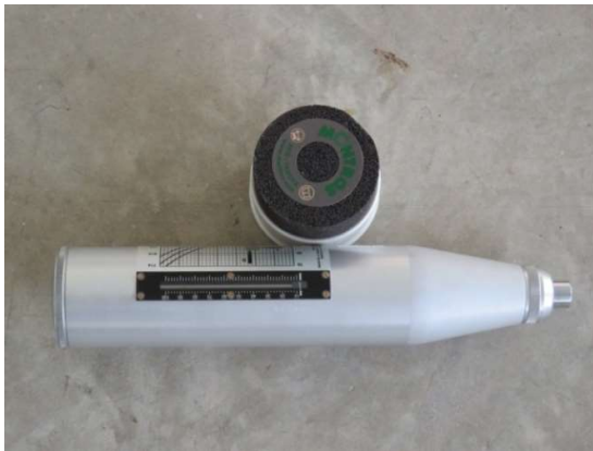
ภาพที่ 5 ชุดเครื่องตรวจสอบความแข็งแรงของคอนกรีตด้วยวิธีค้อนแรงสะท้อน (Rebound Hammer Test)
