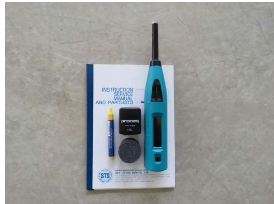
ภาพที่ 6 ชุดเครื่องตรวจสอบความแข็งแรงของคอนกรีตด้วยวิธีค้อนแรงสะท้อน (Rebound Hammer Test)
