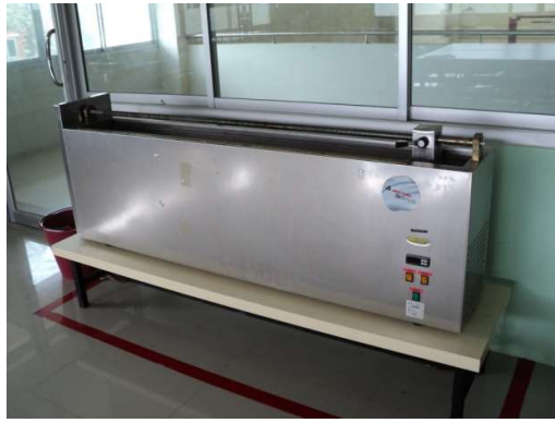
ภาพที่ 5 ชุดทดสอบหาจุดยึดตัวแรงดึง
