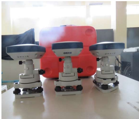
ภาพที่ 14 ชุดเครื่องมือและอุปกรณ์รับสัญญาณดาวเทียม (SOKKIA GSX 2)
