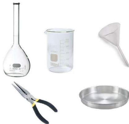
ภาพที่ 9 ชุดทดสอบหาเปอร์เซ็นต์การหลุดลอกระหว่างมวลรวม (Aggregate) กับยางแอสฟัลท์
