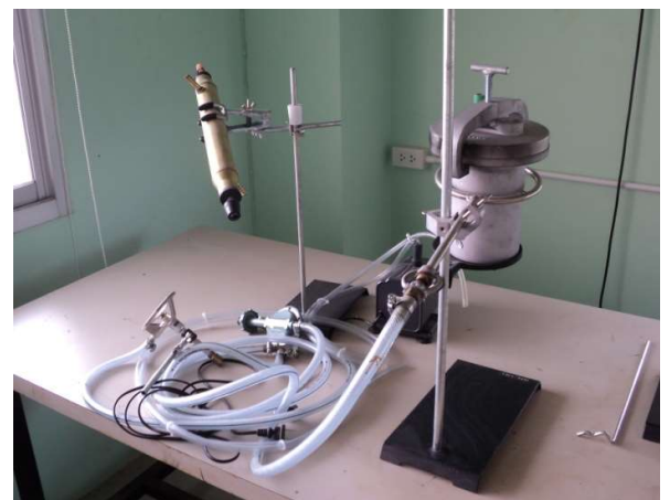
ภาพที่ 10 ชุดทดสอบหาปริมาณน้ำในยางมะตอยน้ำ (Emulsified Asphalts Distillation)
