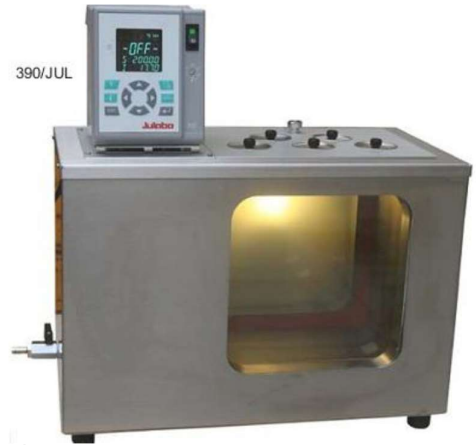
ภาพที่ 2 ชุดทดสอบความหนืดแบบคิเนแมติกของแอสฟัลท์ (CUT - BLACK ASPHALT)
