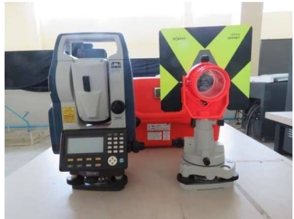
ภาพที่ 10 กล้องสำรวจแบบประมวลผล (SOKKIA CX-105 Dual Display Accuracy 5")
