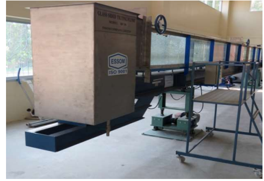
ภาพที่ 2 ชุดทดสอบการไหลของน้ำในรางเปิด (Glass sided tilting flume)
