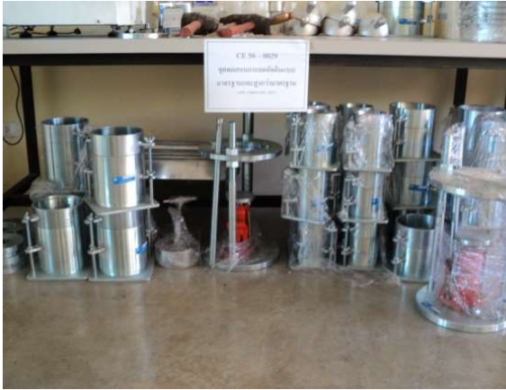
ภาพที่ 5 ชุดทดสอบการอัดดินแบบมาตรฐานและสูงกว่ามาตรฐาน (SOIL COMPACTION TEST)
