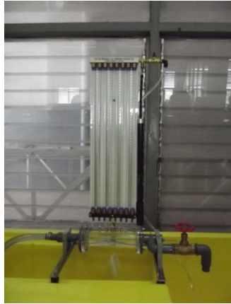
ภาพที่ 7 การทดลองทฤษฎีของเบอร์นูลลี (Bernoulli's theory)
