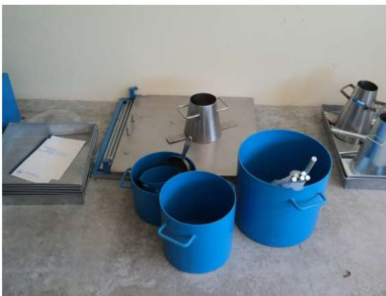
ภาพที่ 7 ชุดทดสอบหาหน่วยน้ำหนักของคอนกรีต
