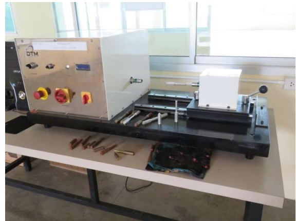
ภาพที่ 2 เครื่องทดสอบ Torsion
