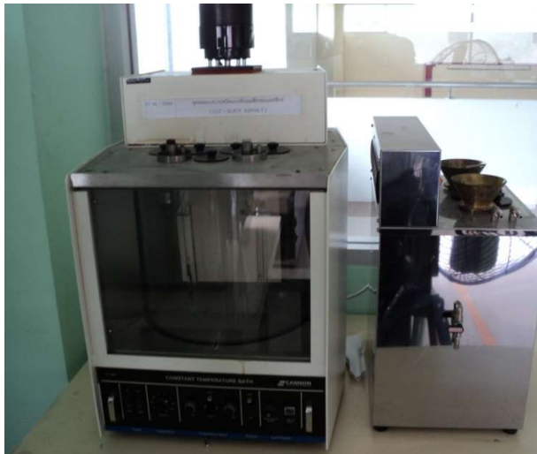
ภาพที่ 3 ชุดทดสอบความหนืดแบบเซย์โบลท์ฟูโรล
