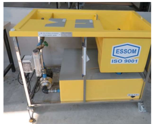
ภาพที่ 4 เครื่องทดสอบหาการสูญเสียในระบบปิด (Piping Loss test)
