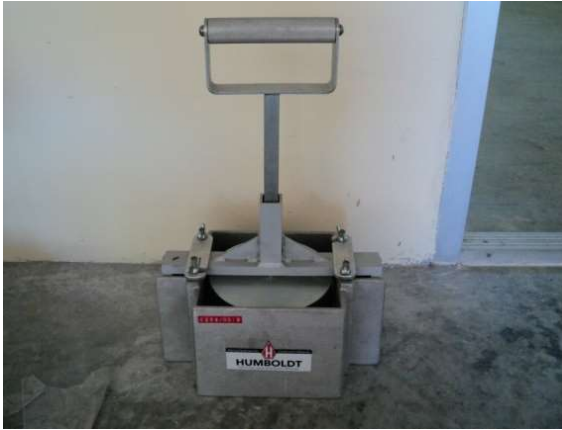
ภาพที่ 13 ชุดทดสอบการจมนของลูกบอล KELLY
