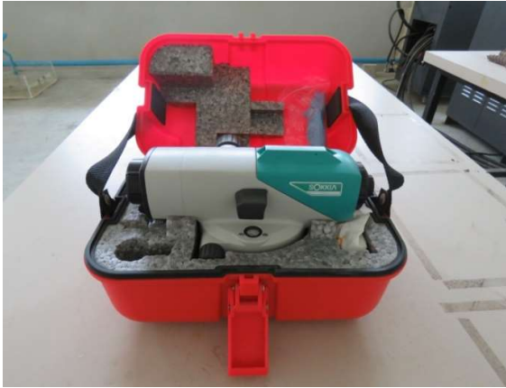
ภาพที่ 4 กล้องระดับอัตโนมัติ SOKKIA B30 (28 เท่า)
