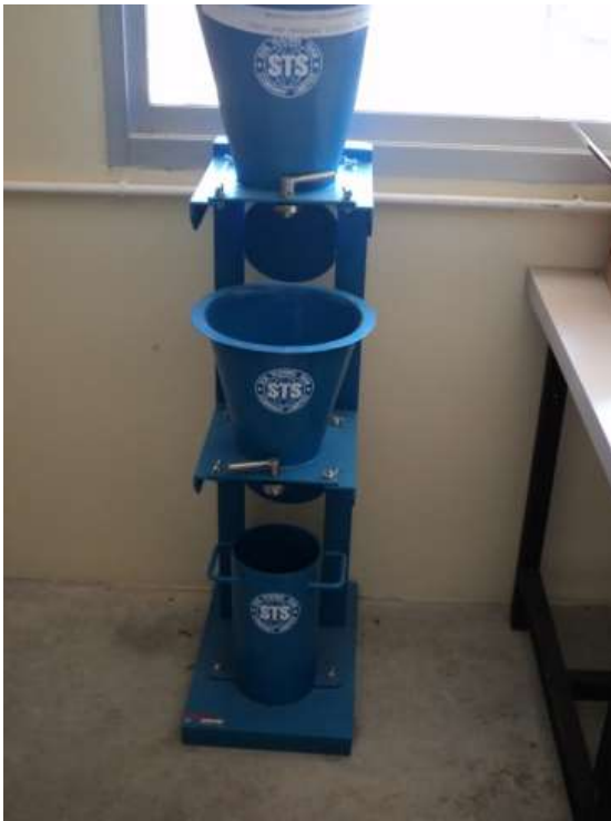
ภาพที่ 11 ชุดทดสอบหาค่าการอัดแน่นของคอนกรีต
