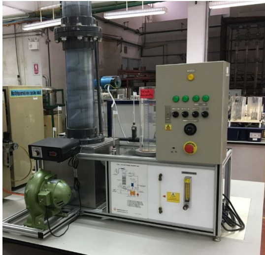
ภาพที่ 5.10 Cooling Tower
