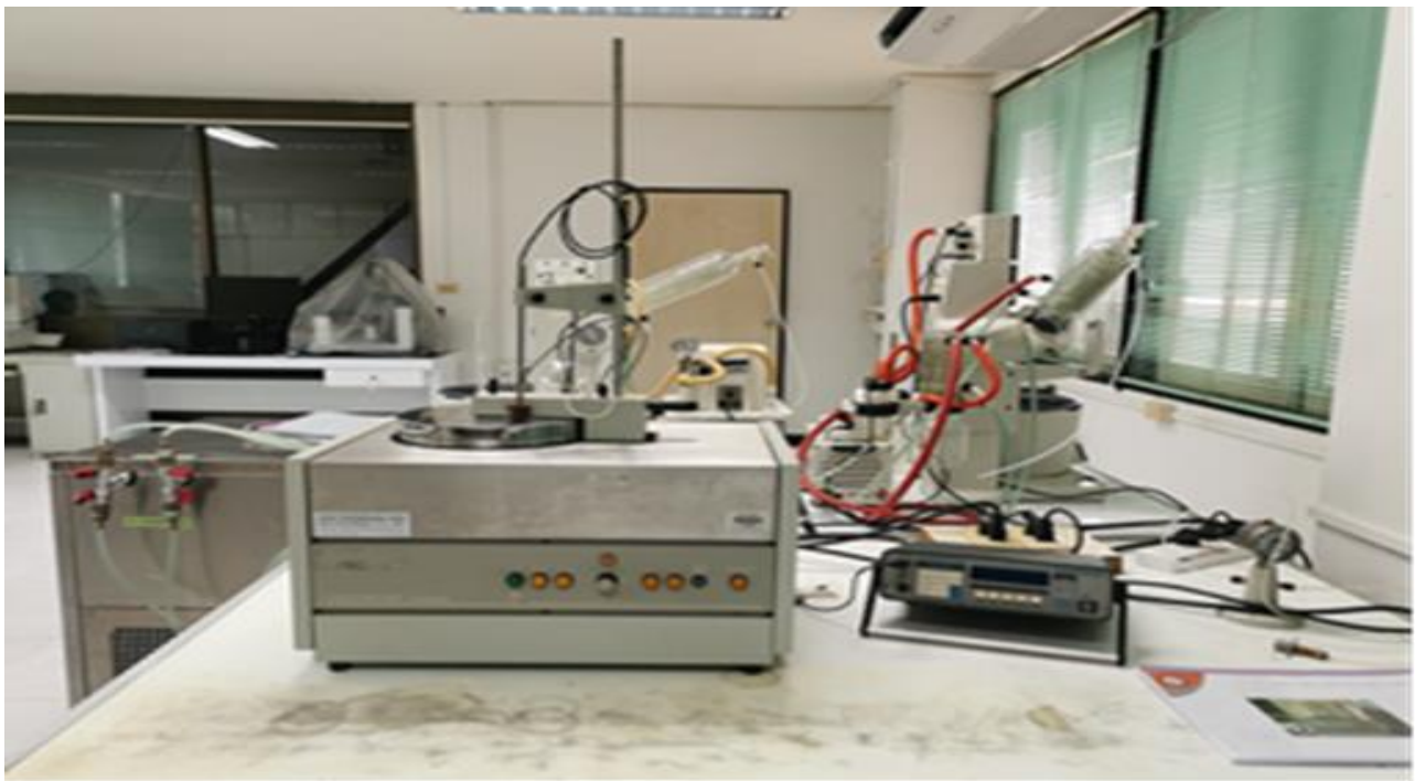
รูปที่ 4 เครื่อง Auto Bomb Calorimeter ห้องปฏิบัติการ1 อาคาร EN14
