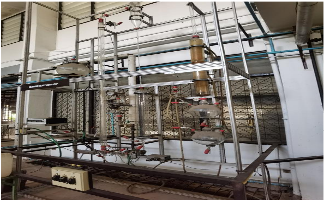
รูปที่ 14 เครื่อง Climbing Film ห้อง Workshop อาคาร EN14
