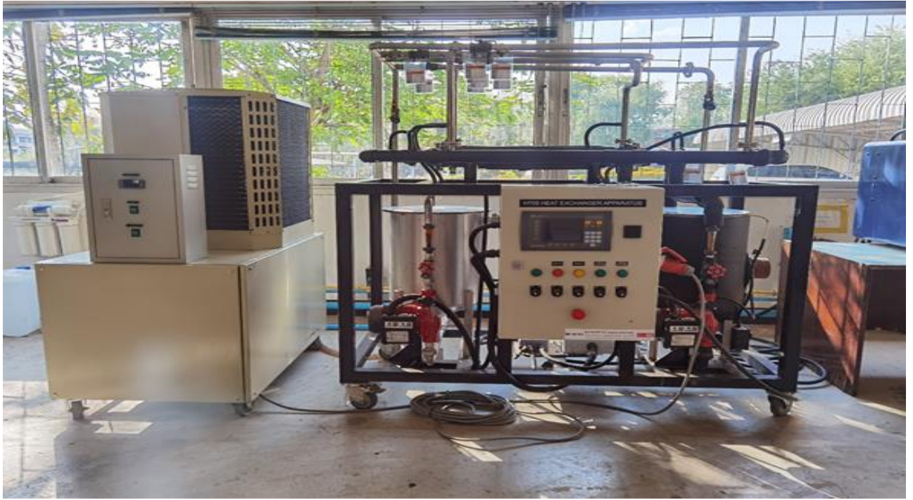
รูปที่ 9 เครื่อง Double pipe Heat Exchanger ห้อง Workshop อาคาร EN14
