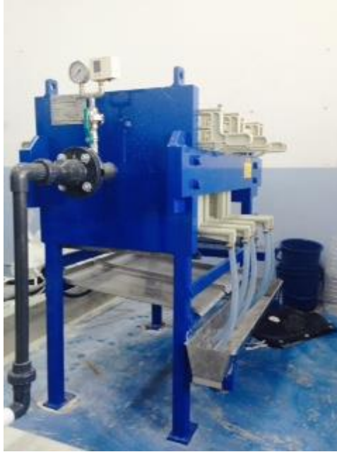
(6) ชุดทดลองการกรอง (Filtration Unit)
