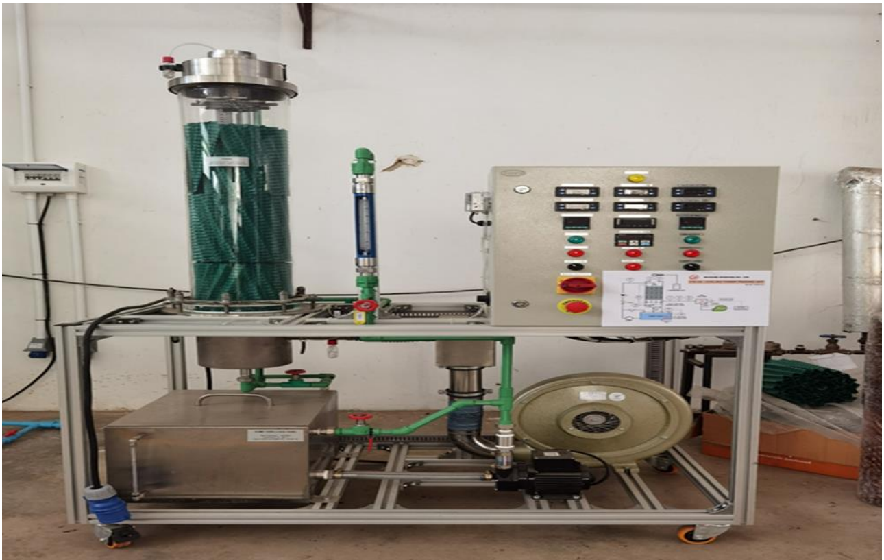
รูปที่ 10 เครื่อง Cooling Tower ห้อง Workshop อาคาร EN14
