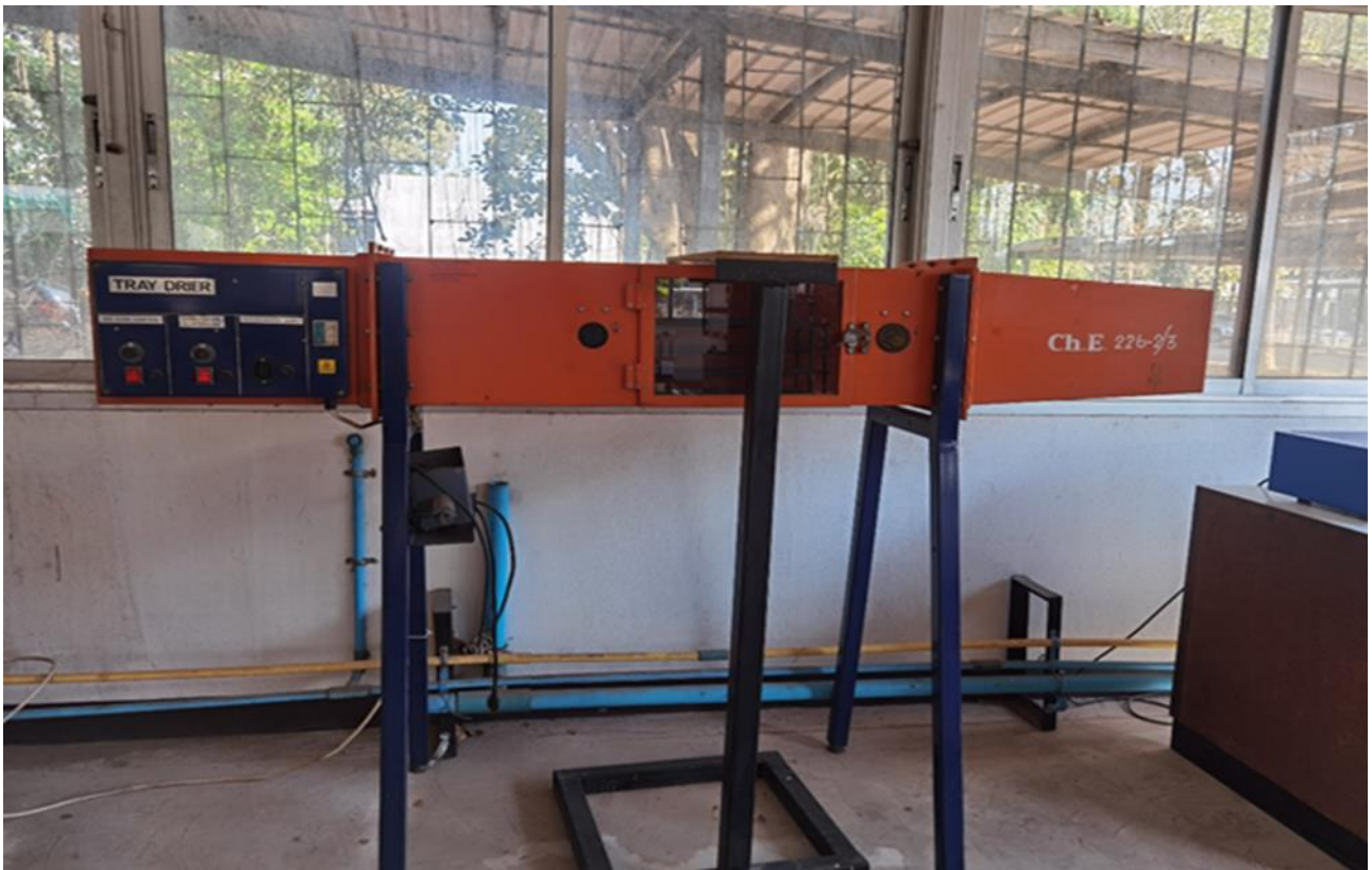
รูปที่ 16 เครื่อง Tray Dryer ห้อง Workshop อาคาร EN14
