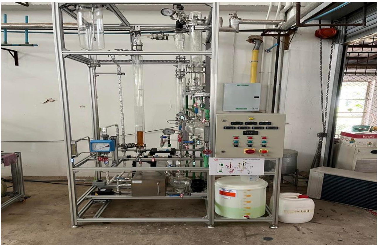
รูปที่ 14 เครื่อง Rising film evaporation ห้อง Workshop อาคาร EN14
