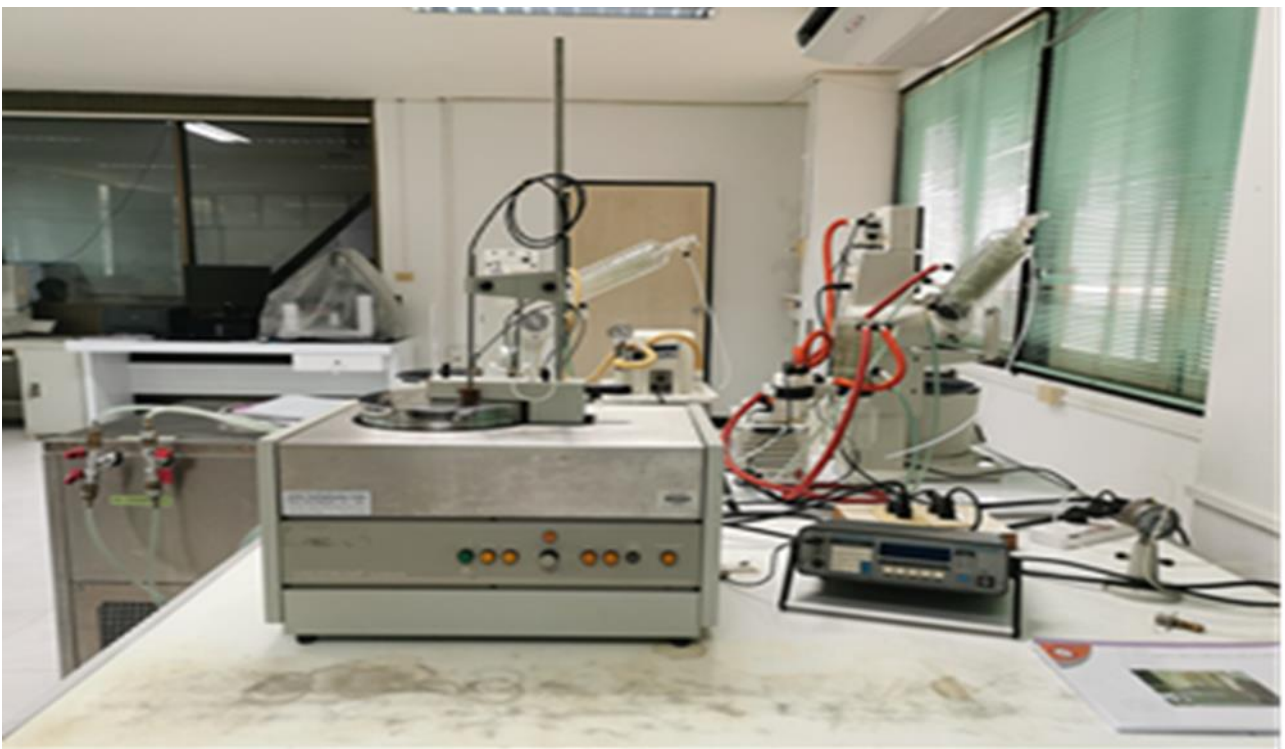
รูปที่ 4 เครื่อง Auto Bomb Calorimeter ห้องปฏิบัติการ1 อาคาร EN14
