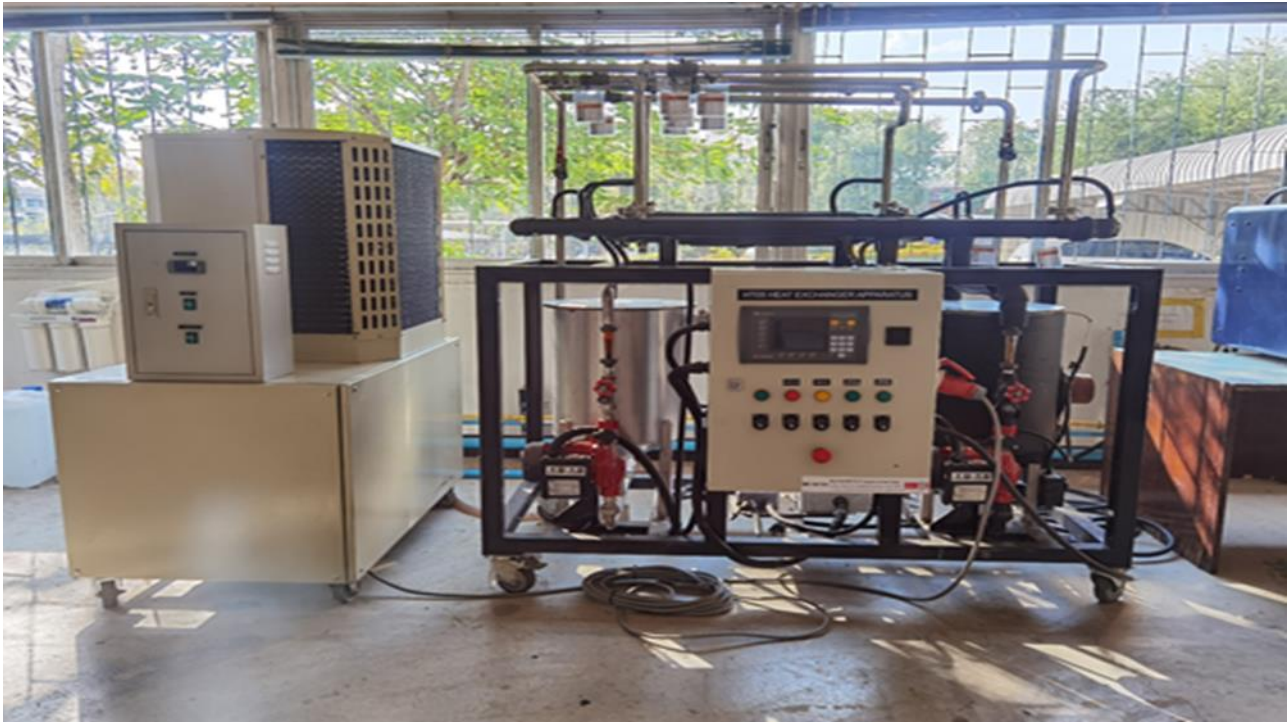
รูปที่ 23 เครื่อง Shell and Tube Heat Exchanger ห้อง Workshop อาคาร EN14
