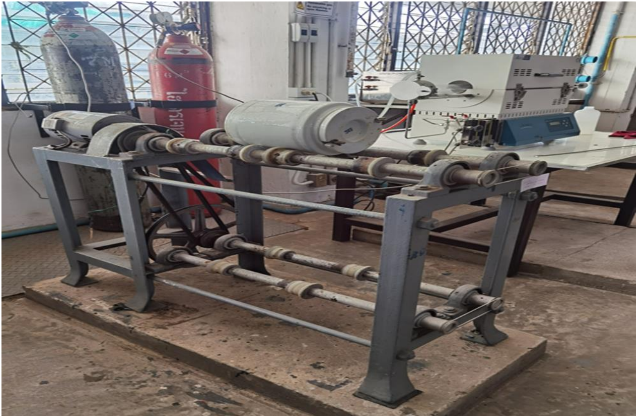
รูปที่ 8 เครื่อง Size reduction ห้อง Workshop อาคาร EN14
