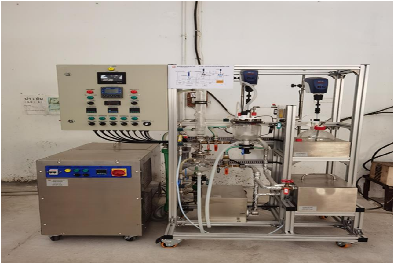
รูปที่ 13 เครื่อง Crystallization ห้อง Workshop อาคาร EN14
