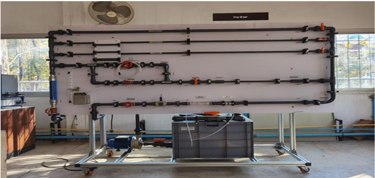
รูปที่ 1 เครื่อง Friction loss ห้อง Workshop อาคาร EN14
