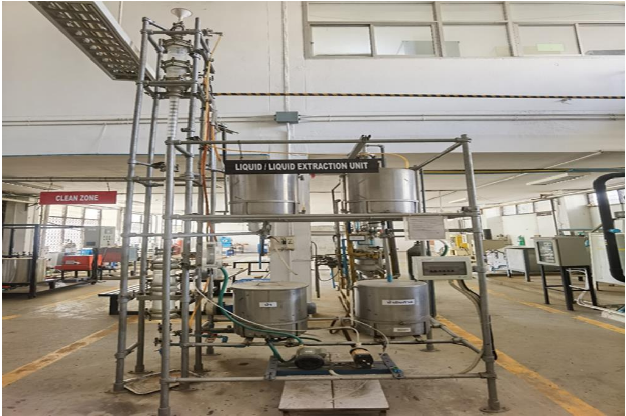
รูปที่ 11 เครื่อง Liquid-Liquid Extraction ห้อง Workshop อาคาร EN14
