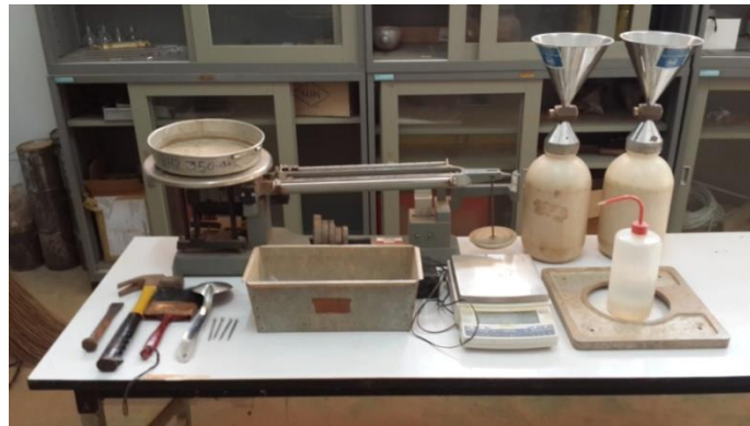
ภาพที่ 7 ชุดทดสอบการหาค่าความหนาแน่นของดินในสนาม
