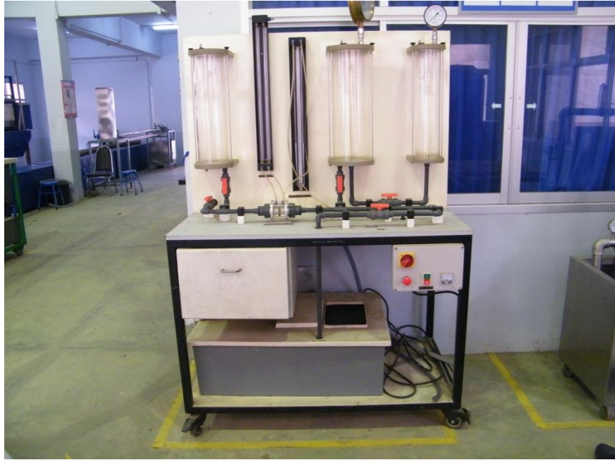
ภาพที่ 1 การหาแรงดันและความดันสถิตของน้ำ
