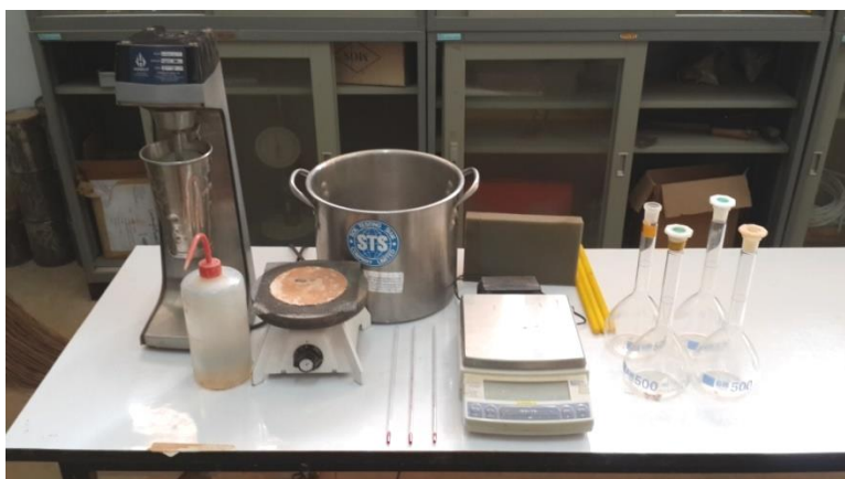
ภาพที่ 1 ชุดทดสอบการหาค่าความถ่วงจำเพาะของเม็ดดิน
