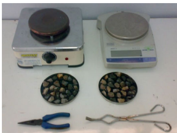
ภาพที่ 7 การทดลองการหลุดลอกโดยวิธี Plate test
