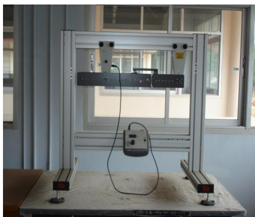
ภาพที่ 7 ชุดเครื่องทดสอบการหาแรงในชิ้นส่วนของคาน
