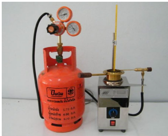
ภาพที่ 11 การทดลองหาจุดวาบไฟหรือจุดติดไฟโดยใช้ด้วยการทดลองคลื่นโอเพน
