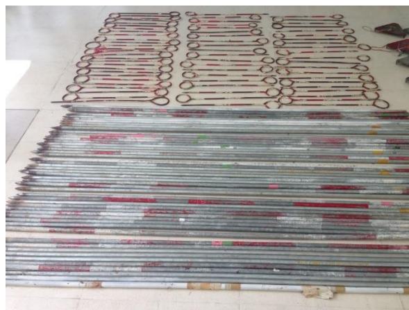
ภาพที่ 12 หลักลงแนว (Pole) และท่วงคเนน (Pin)
