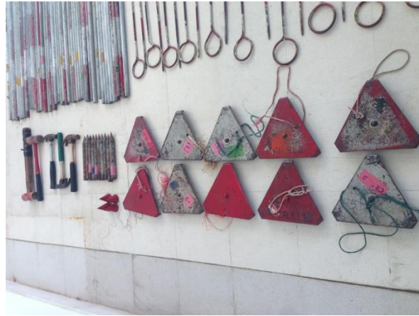
ภาพที่ 13 Foot Plate, Spike, ค้อน และลูกดิ่ง
