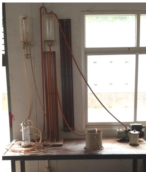
ภาพที่ 8 ชุดทดสอบการหาค่าความชื้นได้ของน้ำผ่านดิน
