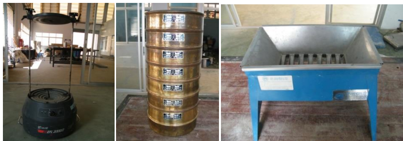
ภาพที่ 1 การทดลองหาขนาดเม็ดของวัสดุโดยผ่านตะแกรงแบบไม้ล้างแบบล้าง
