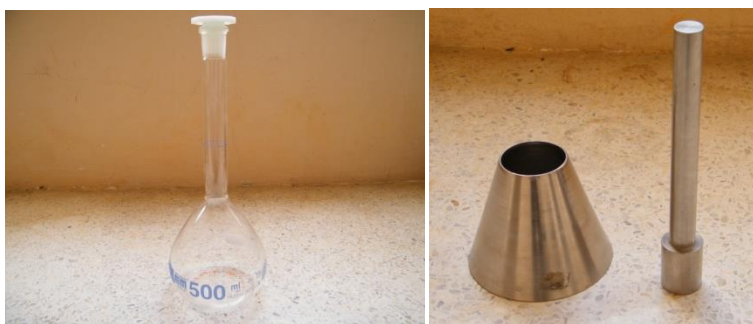
ภาพที่ 2 การทดลองความถ่วงจำเพาะและการดูดซึมน้ำของวัสดุมวลรวมละเอียด
