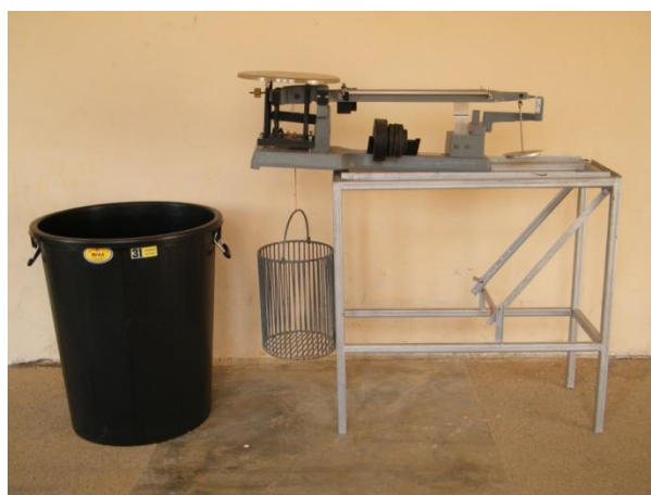
ภาพที่ 3 การทดลองความถ่วงจำเพาะและการดูดซึมน้ำของวัสดุมวลรวมหยาบ
