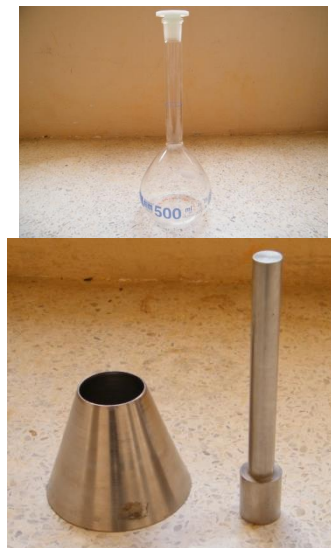
ภาพที่ 12 ชุดทดสอบหาค่าความถ่วงจำเพาะของวัสดุมวลรวมละเอียด
