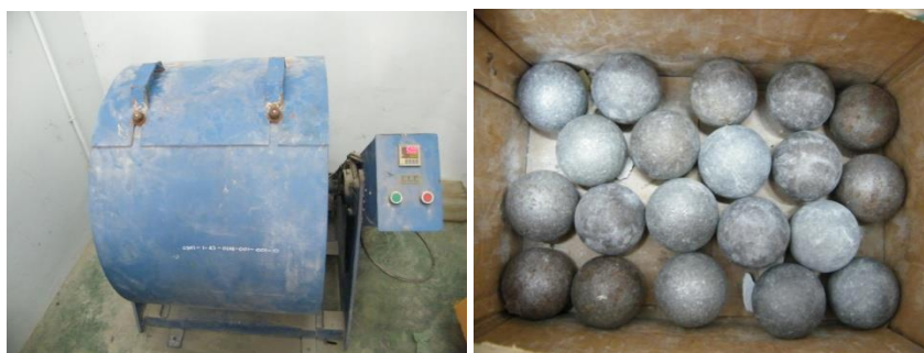
ภาพที่ 6 การทดลองหาการสึกหรอของวัสดุมวลรวมหยาบโดยใช้เครื่อง Los Angeles
