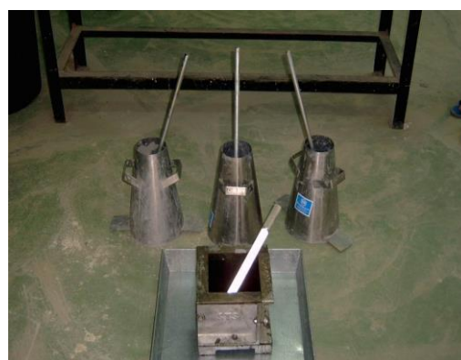
ภาพที่ 16 ชุดทดสอบการหาค่าการยุบตัวของ คอนกรีต
