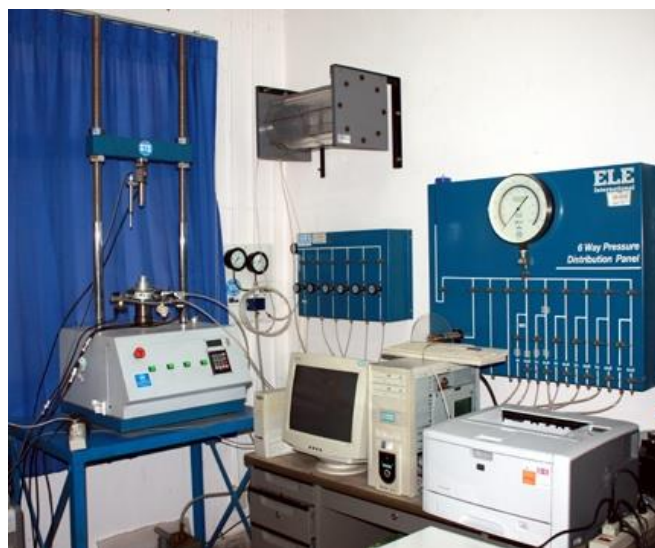
ภาพที่ 11 ชุดทดสอบ Triaxial Test
