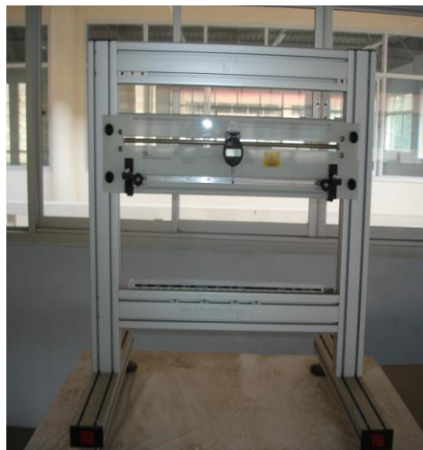
ภาพที่ 6 ชุดเครื่องทดสอบหาการโก่งตัวของคาน
