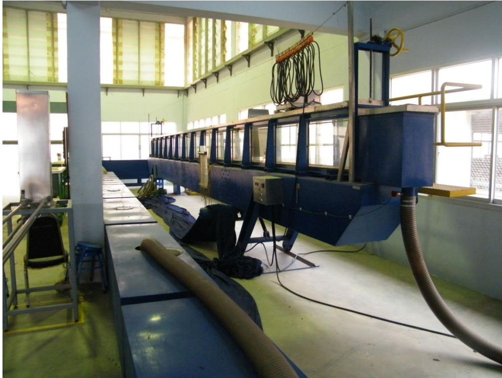
ภาพที่ 14 การทดสอบการไหลในทางน้ำเปิด
