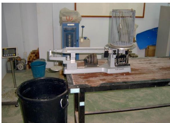
ภาพที่ 13 ชุดทดสอบหาค่าความถ่วงจำเพาะของวัสดุ มวลรวมหยาบ
