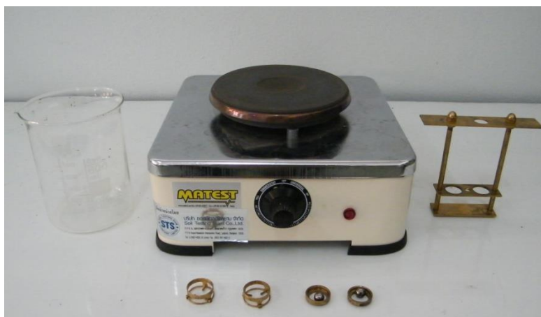
ภาพที่ 13 การทดลองหาจุดอ่อนตัวของวัสดุปิทูเมน
