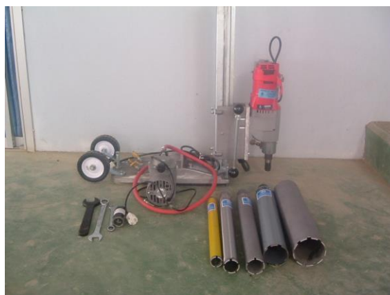
ภาพที่ 8 ชุดเครื่องมือทดสอบ Coring Concrete
