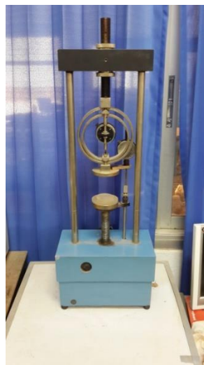
ภาพที่ 10 ชุดทดสอบ Unconfined Compression Test
