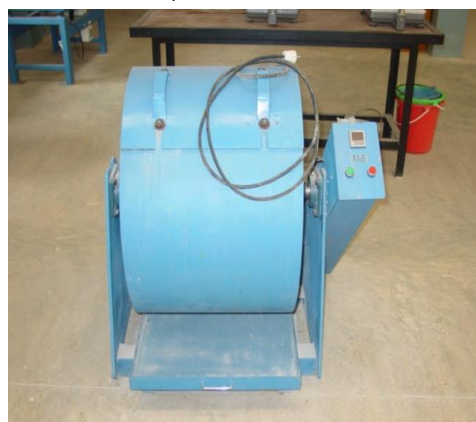
ภาพที่ 14 ชุดทดสอบการสีหรือของวัสดุมวล รวม
