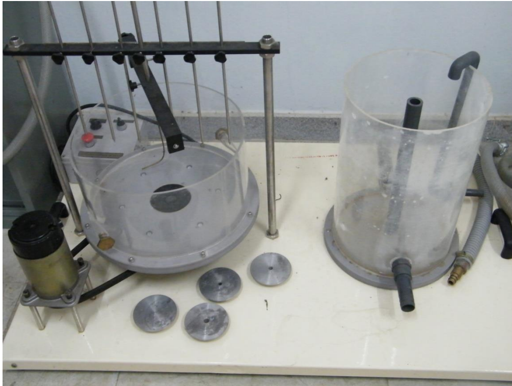
ภาพที่ 5 พฤติกรรมการไหลวนแบบอิสระและบังคับ
