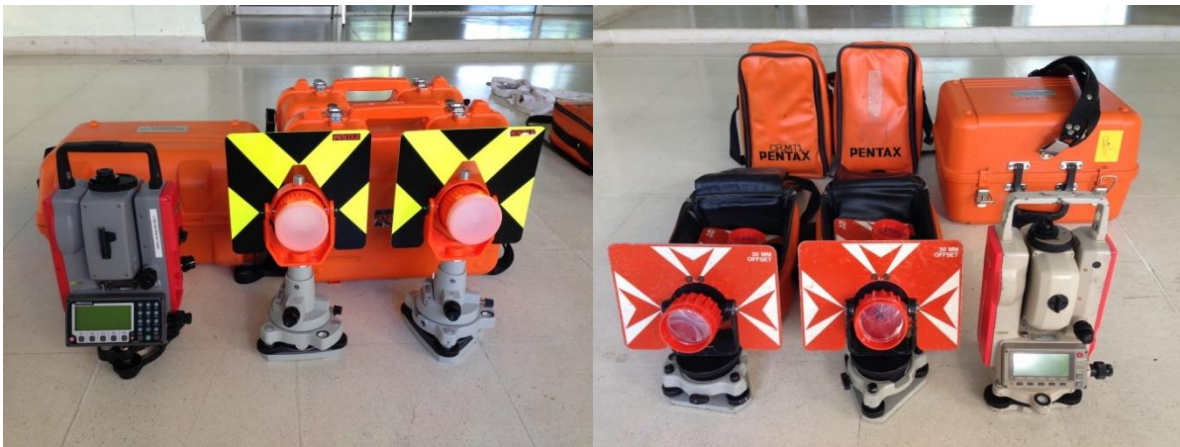
ภาพที่ 6 กล้องวัดมุม Total Station พร้อมอุปกรณ์
