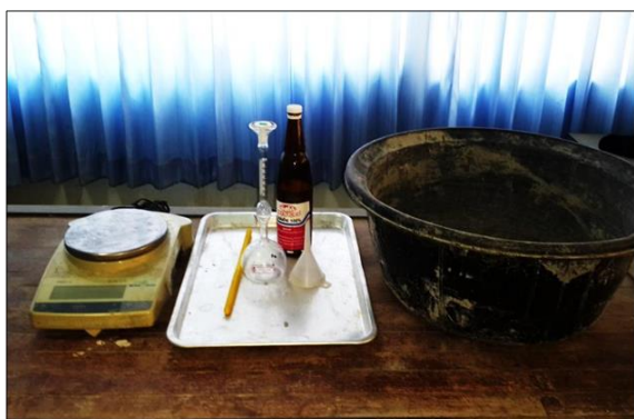
ภาพที่ 9 ชุดทดสอบการหาค่าความถ่วงจำเพาะของ ซีเมนต์
