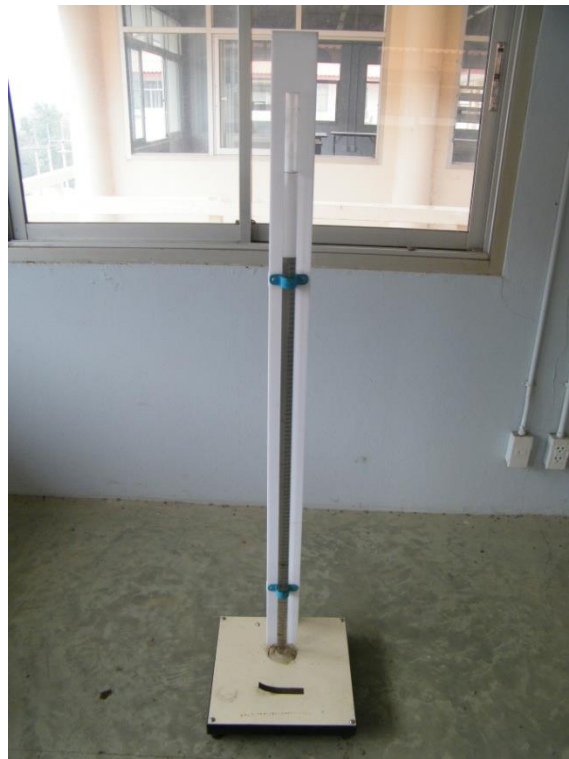
ภาพที่ 6 การหาความหนืดของของไหลแบบลูกบอลตก
