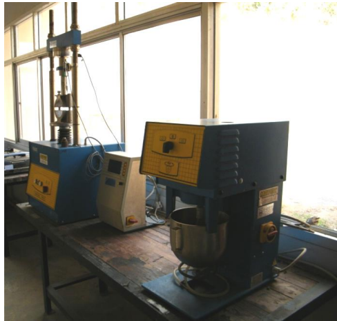
ภาพที่ 18 การทดลองความต้านทานการไหลของแอสฟัลต์คอนกรีตโดยวิธีมาร์แชลล์
