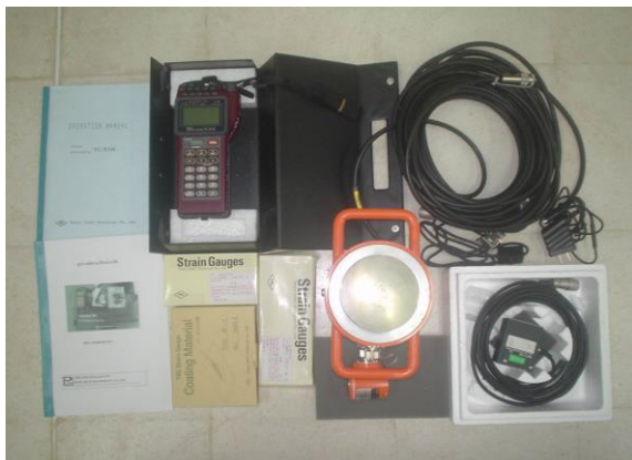
ภาพที่ 5 เครื่องทดสอบและอุปกรณ์สอบเทียบแรงและ เครื่องวัดการยืดหดตัวด้วยระบบไฟฟ้า
