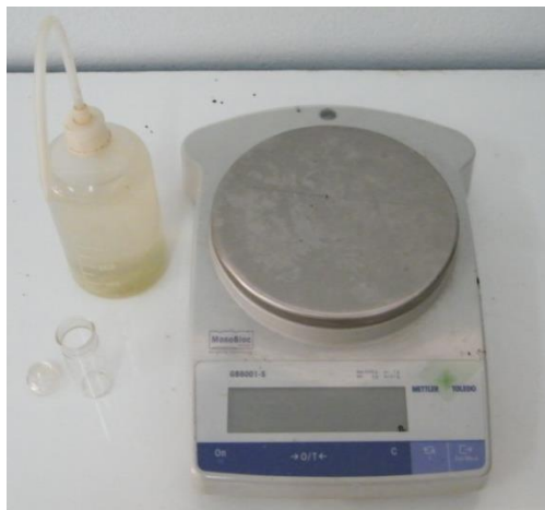
ภาพที่ 8 การทดลองความถ่วงจำเพาะและความหนาแน่นของวัสดุปิทิวเมนสภาพกึ่งแข็ง
