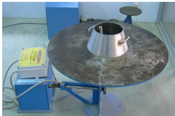
ภาพที่ 18 ชุดทดสอบไต้การไหล
