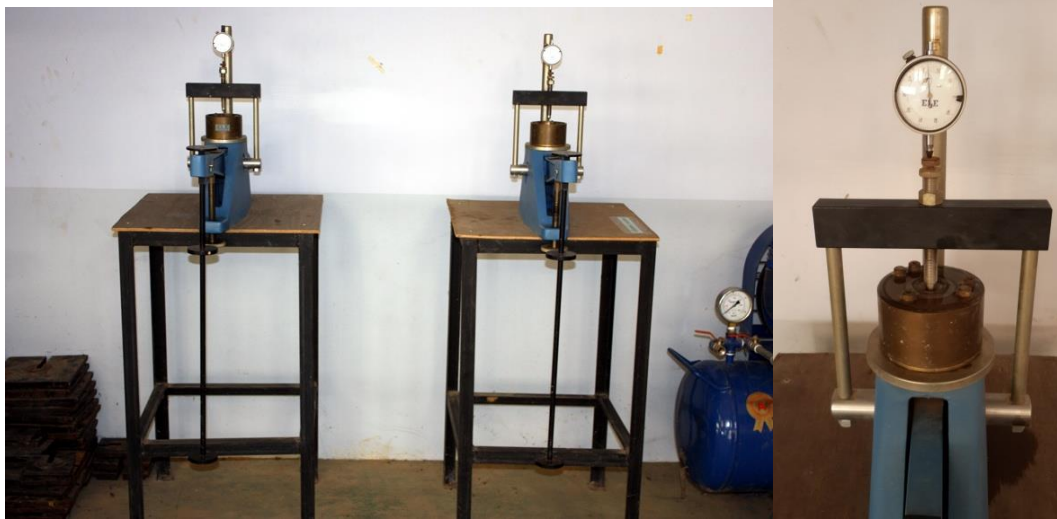
ภาพที่ 12 ชุดทดสอบ Consolidation Test
