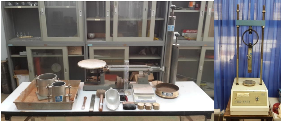
ภาพที่ 6 ชุดทดสอบแคลิฟอร์เนียแบร์ริงเรโซ(C.B.R.)
