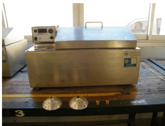
ภาพที่ 12 การทดลองหาค่าความชื้นเหลือของวัสดุปิทูเมนโดยใช้จานลอย
