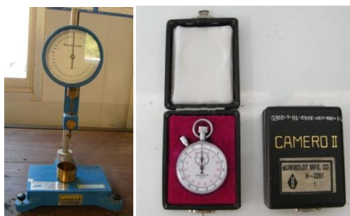
ภาพที่ 9 การทดลองหาค่าการทะลวงของวัสดุปิทิวเมน
