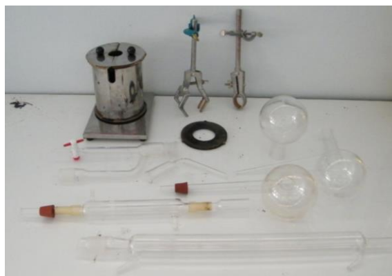
ภาพที่ 16 การทดลองการกลั่นผลิตภัณฑ์แอสฟัลท์ (ปิทูเมน) ชนิดคัทแบค
