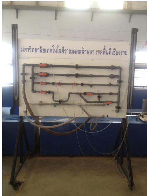
ภาพที่ 12 การวัดการสูญเสียพลังงานหลักและรองในท่อ
