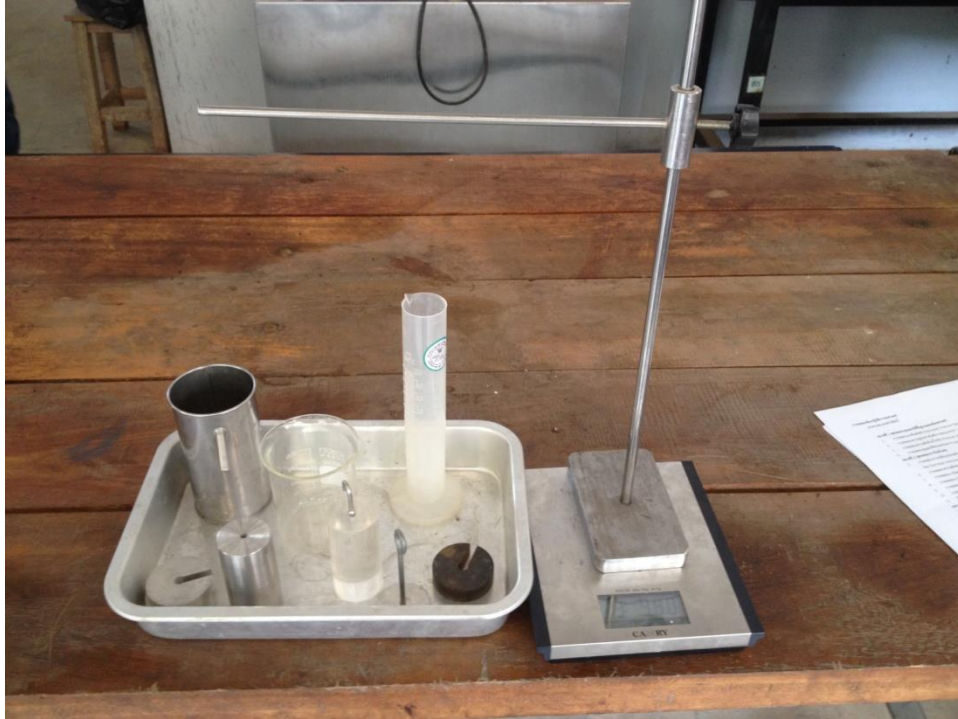
ภาพที่ 7 การแทนที่วัตถุด้วยหลักการของอาร์คิมิดีส
