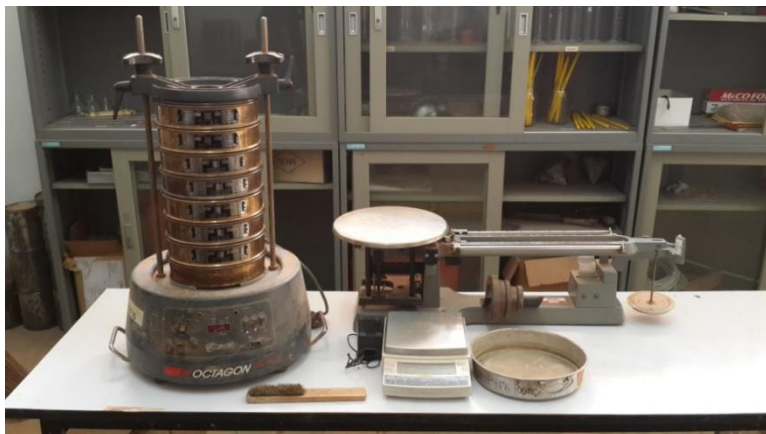
ภาพที่ 3 ชุดทดสอบการจำแนกขนาดของเม็ดดินโดยวิธีใช้เตาแก๊สร้อน
