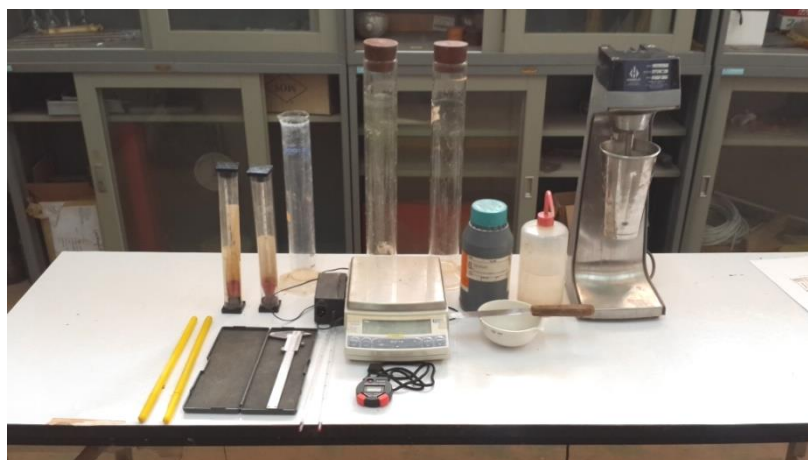
ภาพที่ 4 ชุดทดสอบการจำแนกขนาดของเม็ดดินโดยวิธีใช้ Hydrometer
