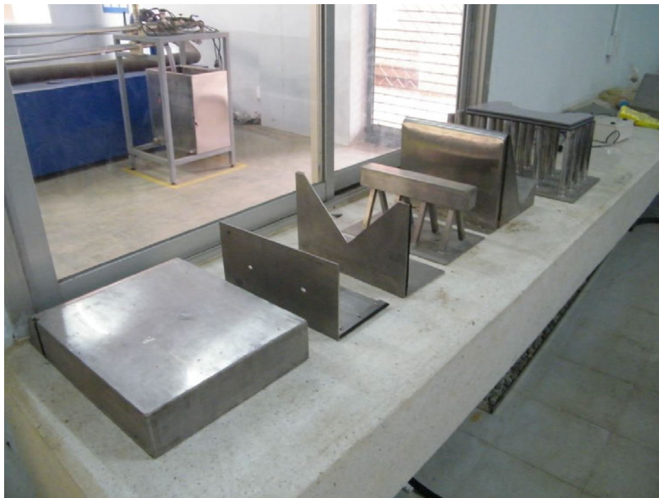
ภาพที่ 15 การจำลองการไหลผ่านฝายชนิดต่างๆ
