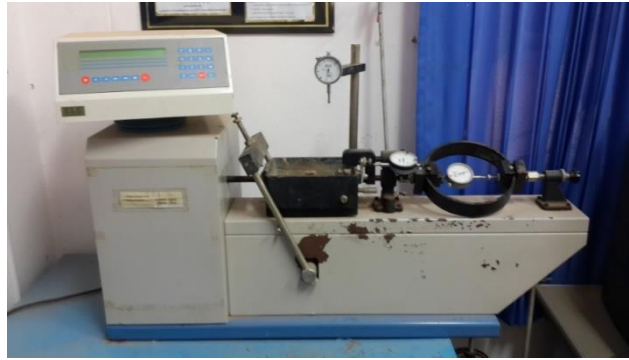
ภาพที่ 9 ชุดทดสอบ Direct Shear Test
