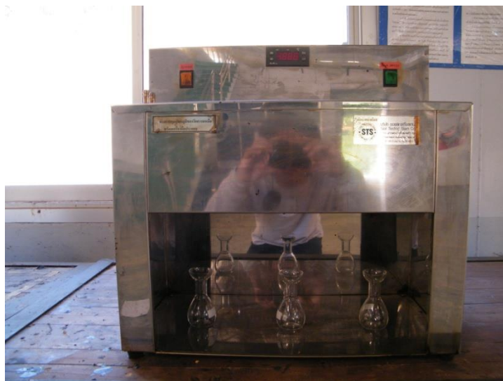
ภาพที่ 14 การทดลองหาค่าความหนืดแบบเซย์โบร์ทฟูโรท
