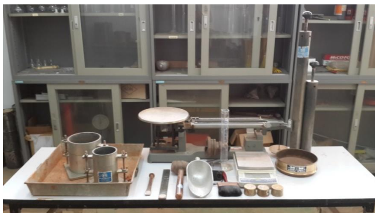
ภาพที่ 5 ชุดทดสอบการบดอัดดินแบบมาตรฐานและแบบสูงกว่ามาตรฐาน
