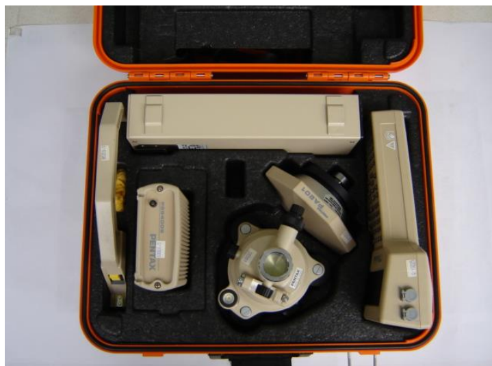
ภาพที่ 1 เครื่องกำหนดตำแหน่งบนพื้นโลกด้วยดาวเทียม (G.P.S)
