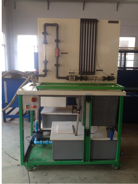
ภาพที่ 11 การวัดอัตราการไหล
