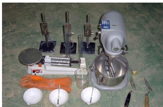
ภาพที่ 10 ชุดทดสอบการหาค่าขีดจำกัดความชื้น เหลวปกติของซีเมนต์เพสท
