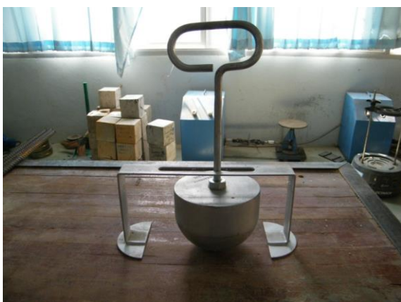
ภาพที่ 21 ชุดทดสอบการรวมของบอลเคลลี
