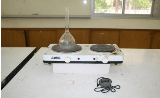
1. ชุดทดสอบการหาค่าความถ่วงจำเพาะของเม็ดดิน
