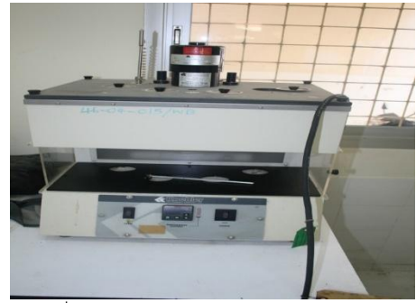
2. เครื่องมือทดสอบความเหนียวแบบคิเนแมติก และแบบเซย์โบลฟูโรล
