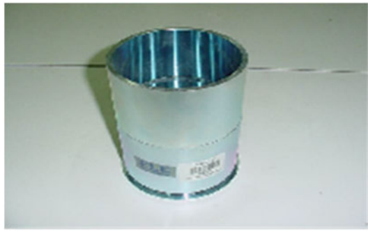
19. อุปกรณ์ทดสอบ Compaction Mould
