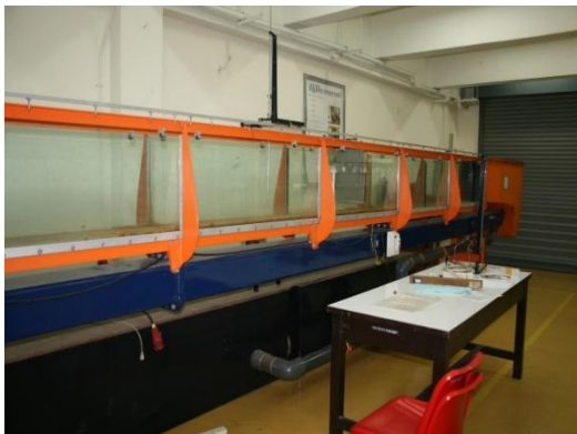
3. ชุดรางน้ำสำหรับทดสอบทฤษฎีการไหลในทางน้ำเปิด
