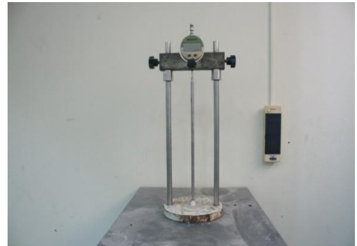
26. เครื่องมือวัดการยึดและหลุดตัวของซีเมนต์มอร์ตาร์
