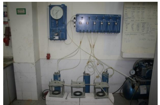
14. ชุดทดสอบ water penetration ของคอนกรีต
