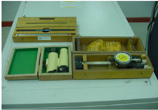
23. กล่องส่งตรวจสอรอยแตกร้าวของคอนกรีต
