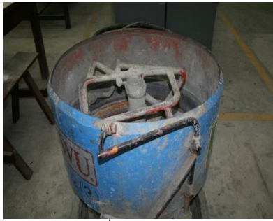
31. เครื่องผสมคอนกรีต
