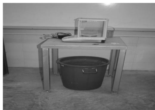
5. ชุดทดสอบการหาค่าความถ่วงจำเพาะของวัสดุมวลรวมหยาบ
