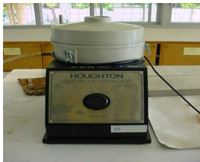
15. เครื่องมือทดสอบการล้างหรือแยกยางมะตอย เพื่อหาส่วนผสม
