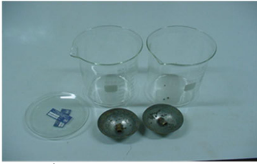
1. เครื่องมือทดสอบการทะลวงของวัสดุปิทูเมน
