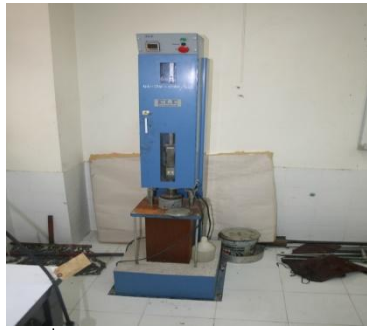
9. เครื่องมือทดสอบอัสปท์คอนกรีตมิกซ์ โดยวิธีมาร์แชล
