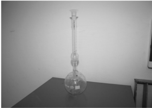
1. ชุดทดสอบการหาค่าความถ่วงจำเพาะของซีเมนต์
