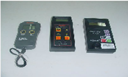
27. ชุดทดสอบสอบอบอุณหภูมิและค่า pH ของดิน
