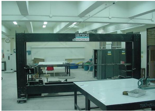
7. ชุดทดสอบคานคอนกรีต
