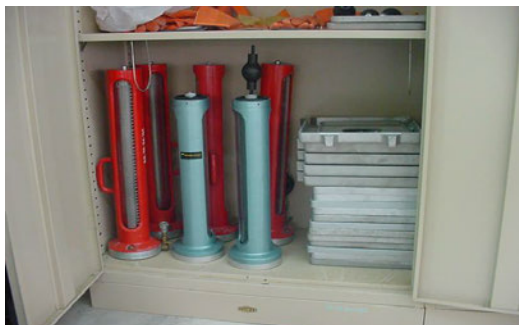
21. ชุดทดสอบความหนาแน่นของดินในสนาม แบบใช้บอลลูน
