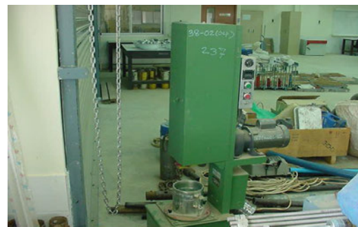
5. ชุดบดอัดดินแบบมาตรฐานและสูงกว่ามาตรฐาน
