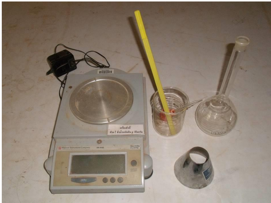
อุปกรณ์การทดสอบความถ่วงจำเพาะและการดูดซึมของวัสดุมวลรวมละเอียด
