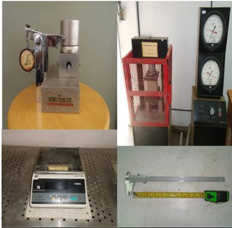
อุปกรณ์สำหรับการทดสอบแรงอัดของไม้ในแนวตั้งฉากเสี้ยน
