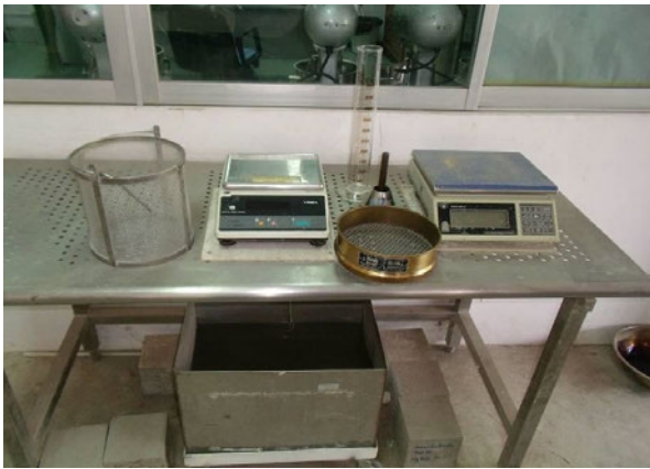
อุปกรณ์สำหรับการทดสอบความถ่วงจำเพาะและการดูดซึมน้ำของวัสดุมวลรวม
