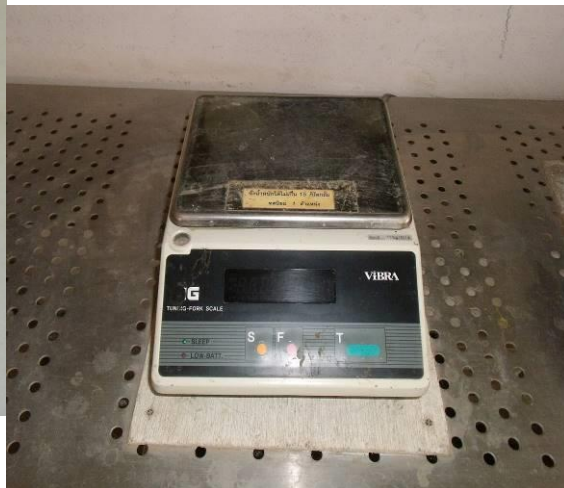
อุปกรณ์สำหรับการทดสอบการหาค่าความละเอียดของปูนซีเมนต์ปอร์ตแลนด์ โดยใช้เครื่องหาความชื้นอากาศแบบเบลน
