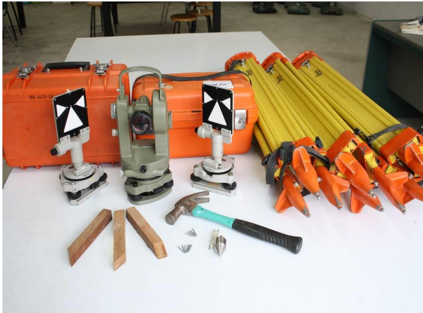
อุปกรณ์สำหรับการทำวงรอบและการปรับแก้ด้วยกล้อง Mechanics
