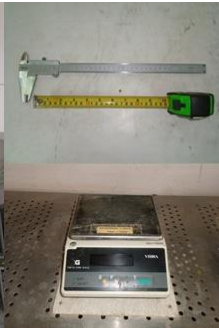
อุปกรณ์สำหรับการทดสอบการรับแรงดึงของเหล็กเสริมคอนกรีต
