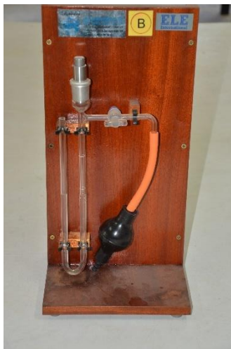
อุปกรณ์สำหรับการทดสอบการหาค่าความละเอียดของปูนซีเมนต์ปอร์ตแลนด์ โดยใช้เครื่องหาความชื้นอากาศแบบเบลน
