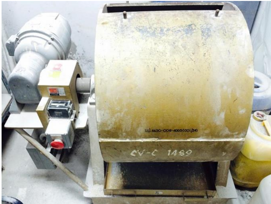
การทดสอบหาการสึกหรอของวัสดุมวลรวมหยาบโดยเครื่อง Los Angeles
