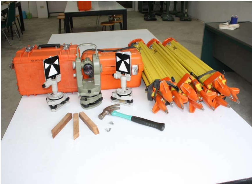
กล้องวัดมุมและอุปกรณ์สำหรับการปรับแก้ด้วยกล้อง Mechanics
