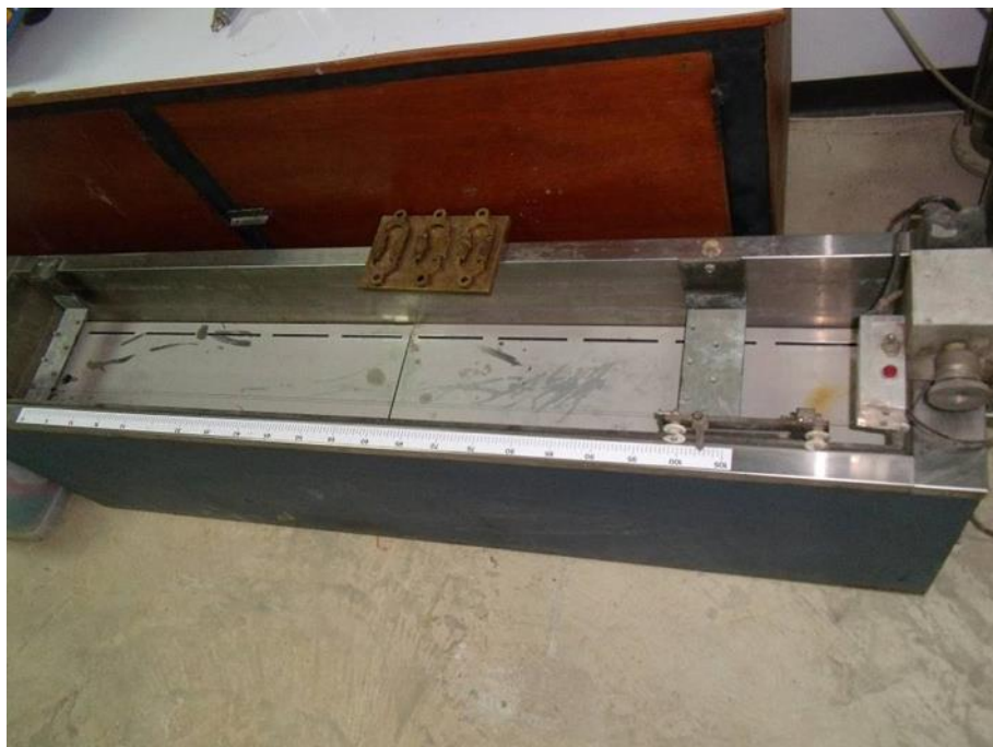
อุปกรณ์สำหรับการทดสอบความยึดดึงของวัสดุคอมโพสิต
