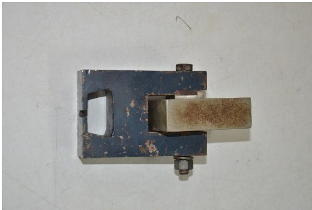
อุปกรณ์สำหรับการทดสอบแรงกดตะปู
