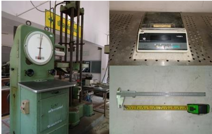
อุปกรณ์สำหรับการทดสอบการรับแรงดัดของเหล็กเสริมรูปพรรณ
