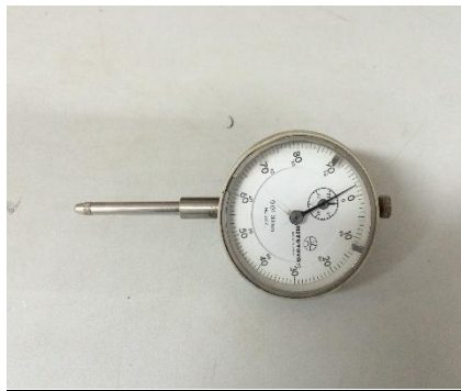
อุปกรณ์สำหรับการเปรียบเทียบเครื่องมือทดสอบและ Dial Gauge
