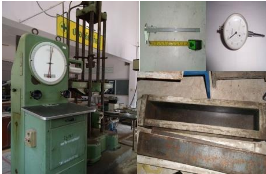
อุปกรณ์สำหรับการแรงดัดของคานคอนกรีต
