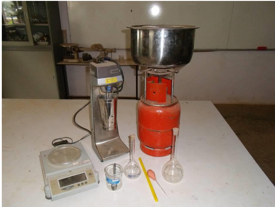
อุปกรณ์การทดสอบหาค่าความถ่วงจำเพาะของเม็ดดิน
