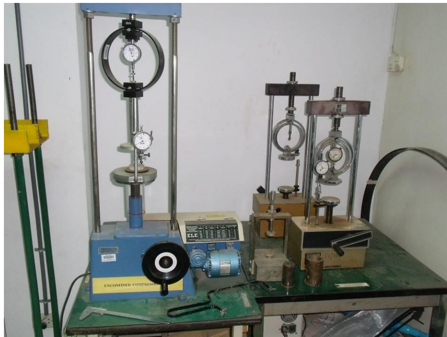
อุปกรณ์การทดสอบหาค่ากำลังของดินแบบ Unconfined
