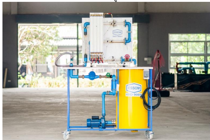
ชุดทดลองเครื่องมือวัดอัตราการไหลภายในท่อ
