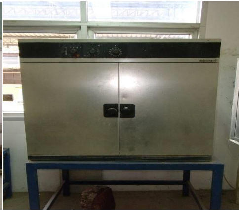
อุปกรณ์สำหรับการทดสอบความถ่วงจำเพาะและการดูดซึมน้ำของวัสดุมวลรวม
