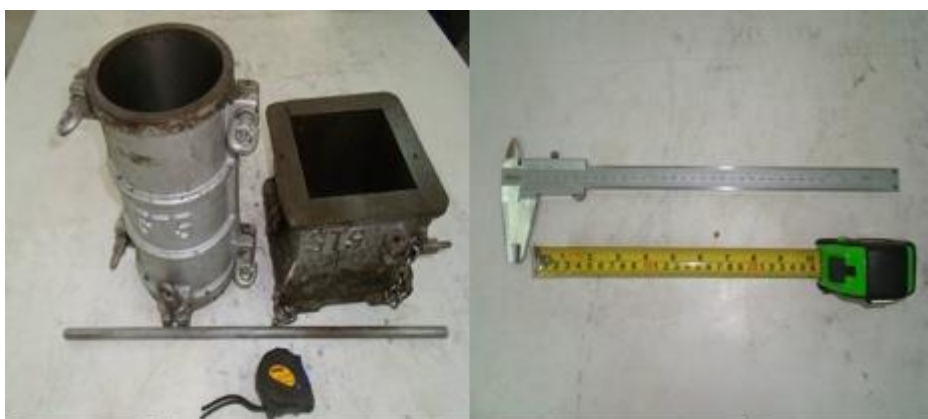
อุปกรณ์สำหรับการทดสอบค่าการยุบตัวของคอนกรีต
