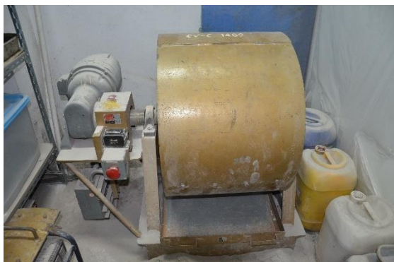
อุปกรณ์สำหรับการทดสอบความต้านทานการสึกกร่อนของหิน โดยเครื่องลอสเองเจลิส
