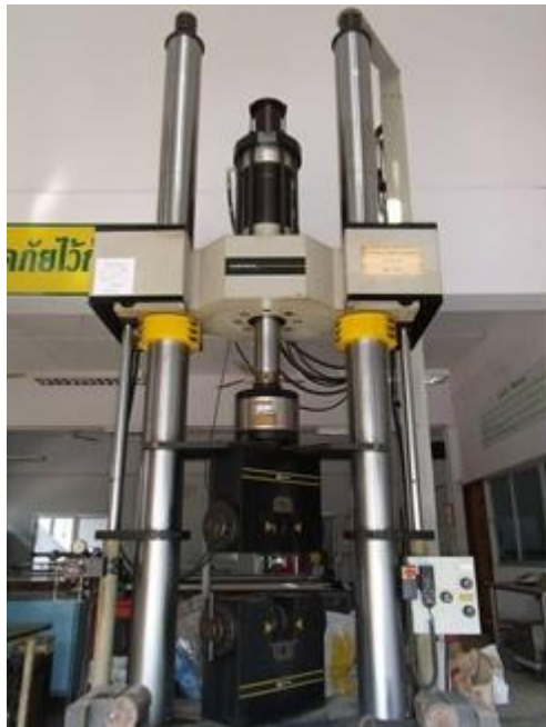
อุปกรณ์สำหรับการทดสอบการรับแรงดึงของเหล็กเสริมคอนกรีต
