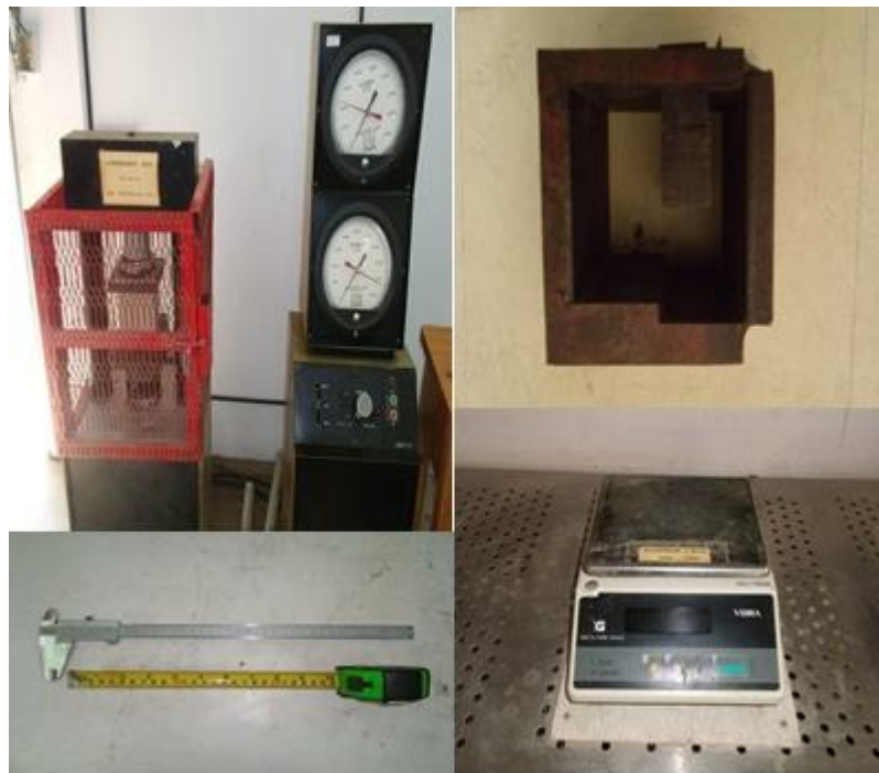
อุปกรณ์สำหรับการทดสอบแรงเฉือนของไม้ในแนวขนานเสี้ยน
