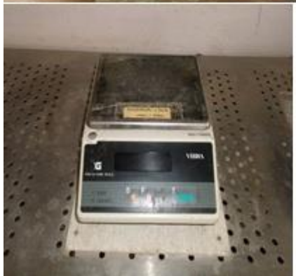
อุปกรณ์สำหรับการทดสอบหาขนาดคละและค่าโมดูลัสความละเอียดของวัสดุมวลรวม
