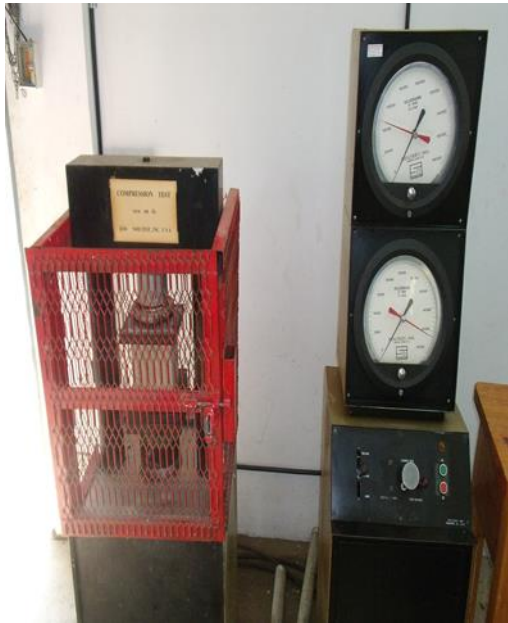
อุปกรณ์สำหรับการทดสอบแรงเฉือนของสลักเกลียว
