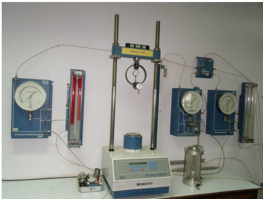
อุปกรณ์การทดสอบหาค่ารับแรงของดินแบบ Triaxial
