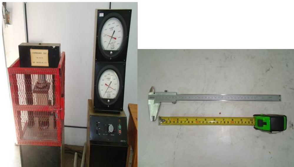
อุปกรณ์สำหรับการทดสอบรับแรงกดของอิฐก่อสร้าง และคอนกรีตบล็อก
