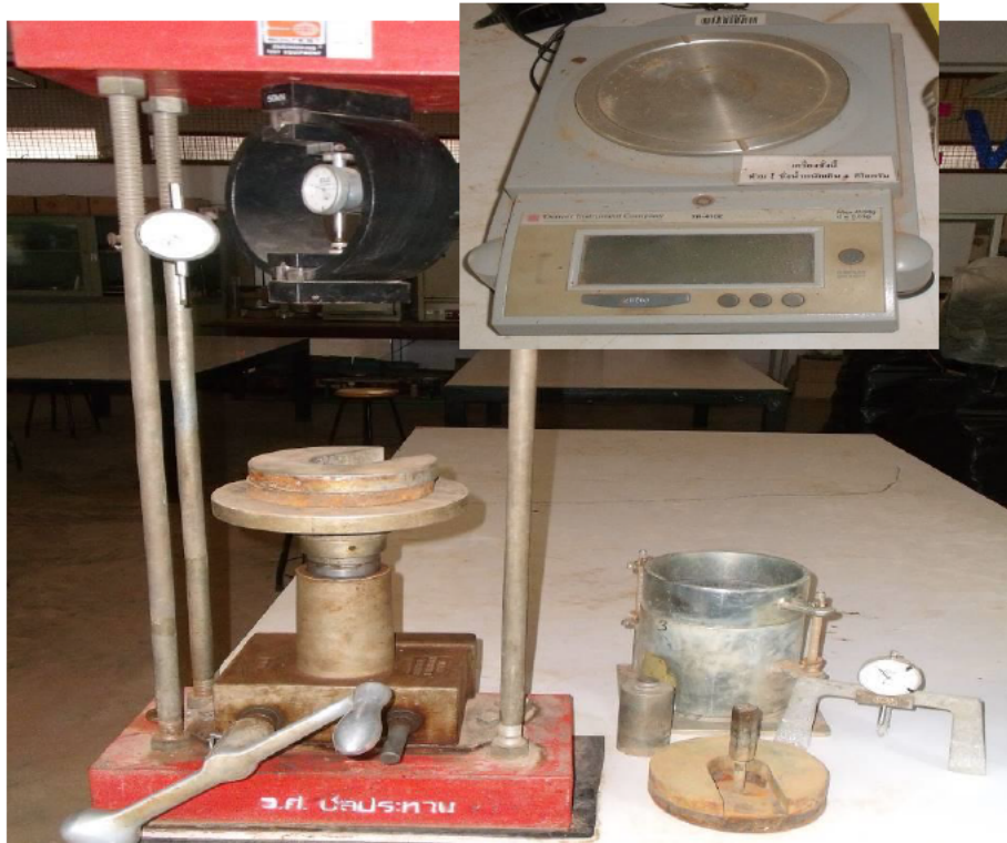
อุปกรณ์การทดสอบหาค่าแคลิฟอร์เนียแบร์ริงเรโซ
