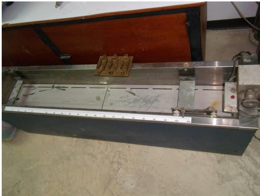
อุปกรณ์การทดสอบความยืดดึงของวัสดุพิวแมน
