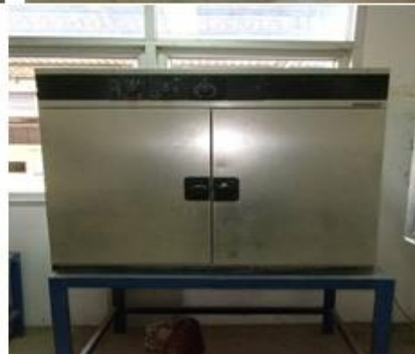
อุปกรณ์สำหรับการทดสอบหาขนาดคละและค่าโมดูลัสความละเอียดของวัสดุมวลรวม
