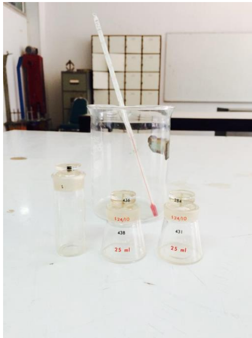
การทดสอบความถ่วงจำเพาะและความหนาแน่นของวัสดุบิโทเมนสภาพกึ่งแข็ง
