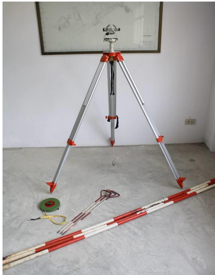
กล้องวัดมุมและอุปกรณ์สำหรับการปรับแก้ด้วยกล้องเข็มทิศ
