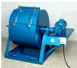
รูปที่ 4.1 เครื่อง Los Angeles Abrasion
