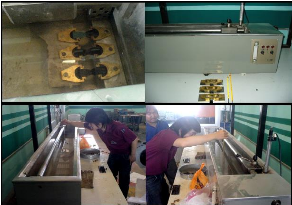
รูปที่ 8.1 เครื่องมือ และการทดสอบความเหนียวของบิทูมินัสภายใต้แรงดึง และแบบหล่อ
