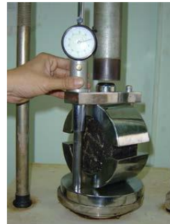
รูปที่ 11.6 เครื่องทดสอบมาร์แชลล์
