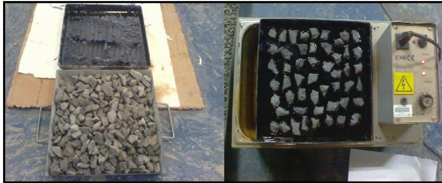
รูปที่ 10.7 เครื่องมือ อุปกรณ์ทดสอบการหลุดลอกของมวลรวม
