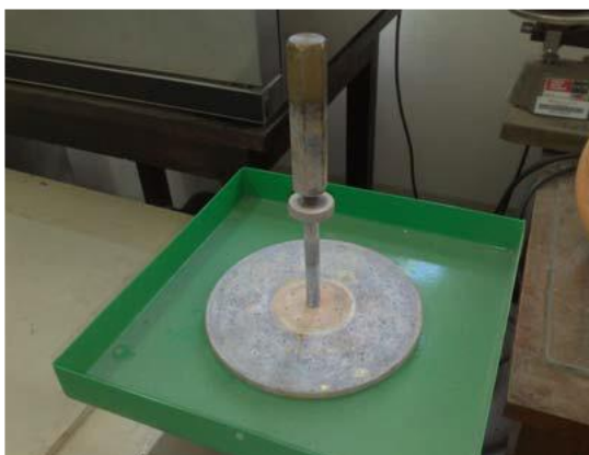
รูปที่ 6.3 แผ่นวัดการขยายตัว (Swell Plate)
