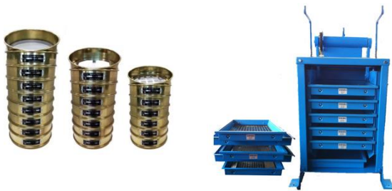
รูปที่ 1.2 ชุดตะแกรงมาตรฐานสหรัฐอเมริกา (US Standard Sieve Series)
