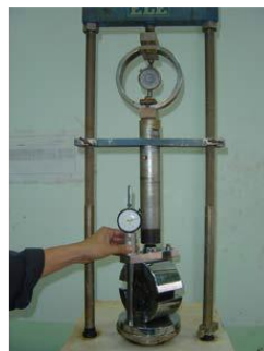
รูปที่ 11.6 เครื่องทดสอบมาร์แชลล์
