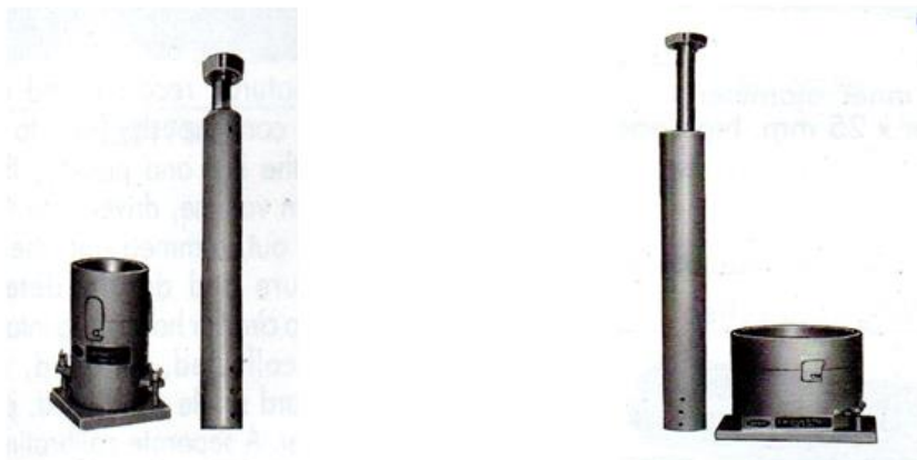
รูปที่ 3.2 แบบอัดดินขนาดเส้นผ่าศูนย์กลาง 4 , 6 นิ้ว และค้อนบดอัดดินแบบ STANDARD HAMMER
