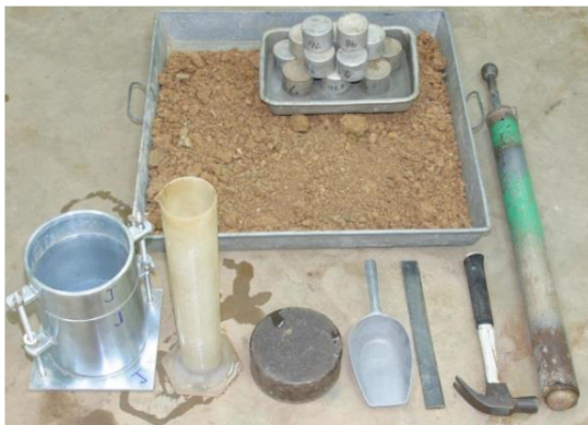
รูปที่ 6.1 อุปกรณ์ที่ใช้ในการบดอัด
