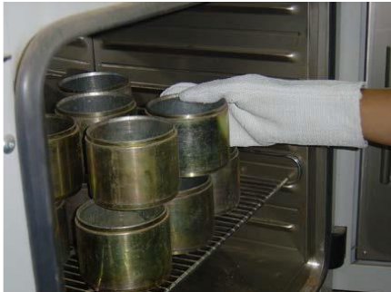
รูปที่ 11.2 แบบหล่อตัวอย่าง
