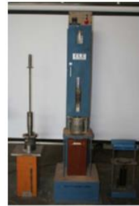
รูปที่ 11.3 แท่นรองการบดอัด พร้อมค้อนบดอัด
