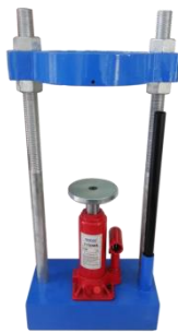
รูปที่ 11.4 เครื่องดันตัวอย่าง
