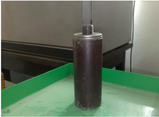
รูปที่ 6.5 ท่อนกด (Penetration Piston)
