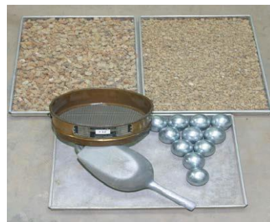
รูปที่ 4.2 ลูกเหล็กทรงกลมและตะแกรง
