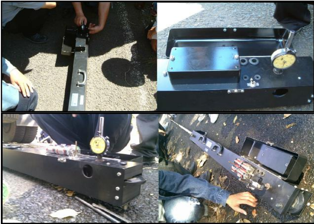
รูปที่ 12.1 Benkleman Beam และลำดับขั้นตอนทดสอบการทรุดตัวของผิวทาง
