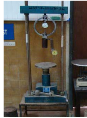
รูปที่ 6.6 เครื่องกด (Loading Machine)
