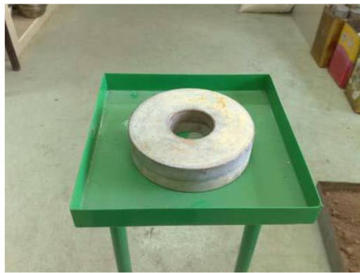
รูปที่ 6.2 แผ่นถ่วงน้ำหนัก (Surcharge Weight)
