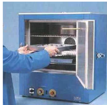
รูปที่ 4.4 การหาค่า W_2 โดยการอบวัสดุมวลรวมส่วนที่เหลือ
