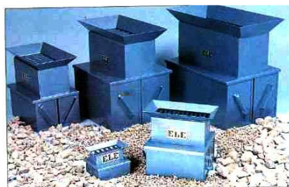
รูปที่ 1.4 เครื่องแบ่งตัวอย่าง
