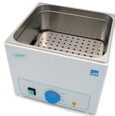
รูปที่ 10.2 อ่างน้ำสำหรับควบคุมอุณหภูมิได้
