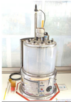
ภาพที่ 5.76 ชุดอุปกรณ์ทดสอบความเหนียวแบบเซย์โบลฟูโรล
