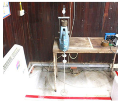
ภาพที่ 5.44 เครื่องทดสอบการหาค่าอัดตัวคายนํ้า
