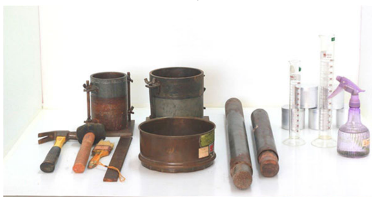
ภาพที่ 5.40 ชุดอุปกรณ์ทดสอบการบดอัดดินแบบมาตรฐานและแบบสูงกว่ามาตรฐาน
