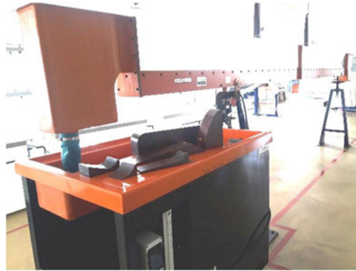
ภาพที่ 5.60 ชุดทดสอบการไหลผ่านฝายสันมนและฝายสันกว้าง
