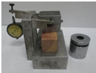
ภาพที่ 5.5 อุปกรณ์ทดสอบการหดตัวของไม้ในแนวตั้งฉากเส้นไม้ (โดยใช้เครื่องทดสอบตามภาพที่ 5.1 ประกอบกัน)
