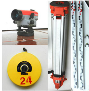
ภาพที่ 5.62 ชุดอุปกรณ์การทำระดับแบบ Differential Leveling
