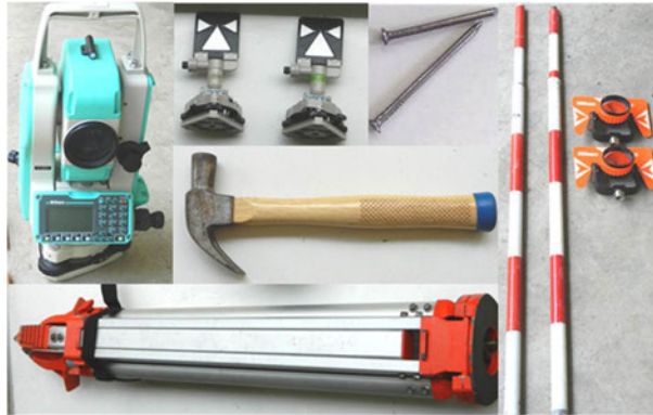
ภาพที่ 5.65 ชุดอุปกรณ์การวางหมุดและเก็บรายละเอียด
