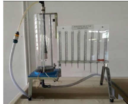
ภาพที่ 5.52 ชุดทดสอบการสัมพันธ์การไหลและสัมพันธ์ความเร็วของการไหลผ่านรูระบายขนาดเล็ก
