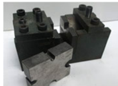
ภาพที่ 5.12 ชุดทดสอบแรงเฉือนเหล็ก (โดยใช้เครื่องทดสอบตามภาพที่ 5.9 และ 4.10 ประกอบกัน)
