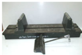
ภาพที่ 5.11 ฐานรองรับคาน (โดยใช้เครื่องทดสอบตามภาพที่ 5.9 และ 4.10 ประกอบกัน)
