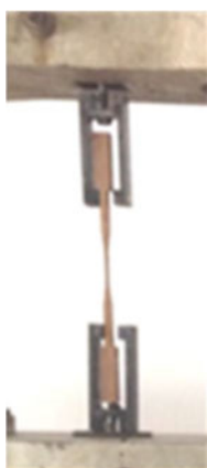
ภาพที่ 5.8 อุปกรณ์ทดสอบแรงดึงของไม้(โดยใช้เครื่องทดสอบตามภาพที่ 5.6 ประกอบกัน)
