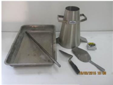
ภาพที่ 5.25 ชุดทดสอบการผสมคอนกรีตในห้องปฏิบัติการ
