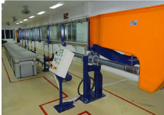
ภาพที่ 5.55 ชุดทดสอบการไหลในทางน้ำเปิด ขนาด 12 เมตร
