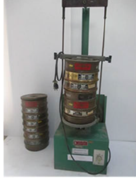
ภาพที่ 5.23 ชุดทดสอบวิเคราะห์ขนาดมวลรวม โดยวิธีร่อนผ่านตะแกรง
