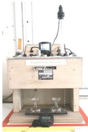
ภาพที่ 5.77 ชุดอุปกรณ์ทดสอบหาความเหนียวของแอสฟัลต์อิมัลชัน
