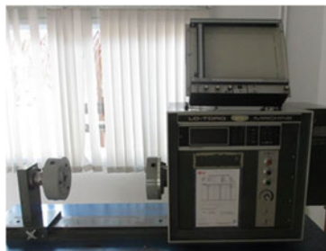
ภาพที่ 5.12 ชุดทดสอบแรงบิดของเหล็กเสริม(โดยใช้ 4.10 ประกอบกัน)
