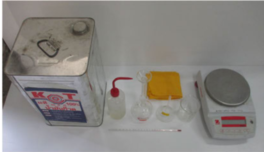
ภาพที่ 5.13 ชุดอุปกรณ์ทดสอบหาค่าความถ่วงจำเพาะของปูนซีเมนต์
