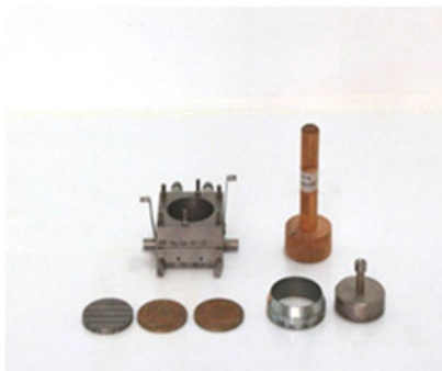
ภาพที่ 5.45 โมลทองเหลืองสำหรับบรรจุตัวอย่าง
