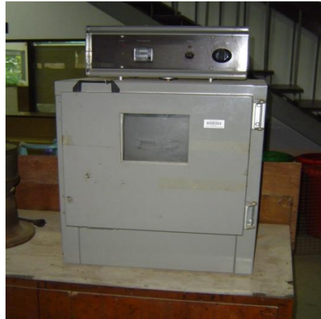
8) เตาอบสำหรับการทดสอบ Thin Film Oven Test
