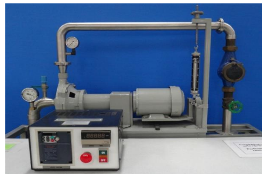
10) เครื่องมือทดสอบการทำงานของเครื่องสูบน้ำแบบ หอยโข่ง
