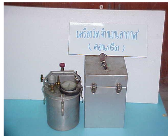
32) เครื่องวัดปริมาณอากาศในคอนกรีต
