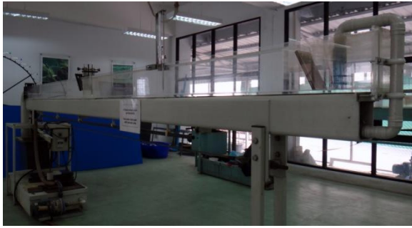
7) เครื่องมือทดลองการไหลผ่านประตูระบายน้ำ และไฮดรอลิกจัม
