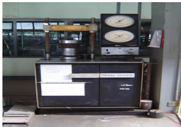
15) เครื่องทดสอบแรงดึงและแรงอัดขนาด 15 ตัน
