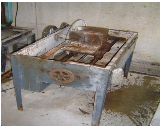
20) เครื่องตัดคอนกรีต
