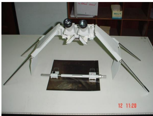
9) กล้องมองภาพสามมิติและไม้วัดระยะเหลือ้ม
