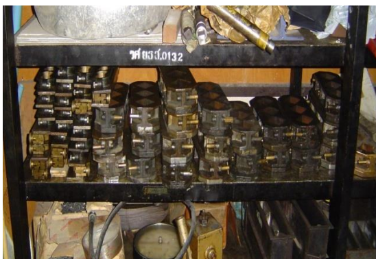
11) แบบหล่อคอนกรีต
