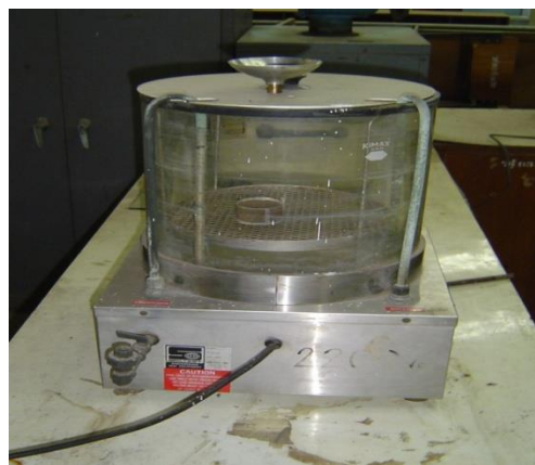
12) อ่างน้ำทดสอบ(Testing Bath)พร้อมจานลอย
