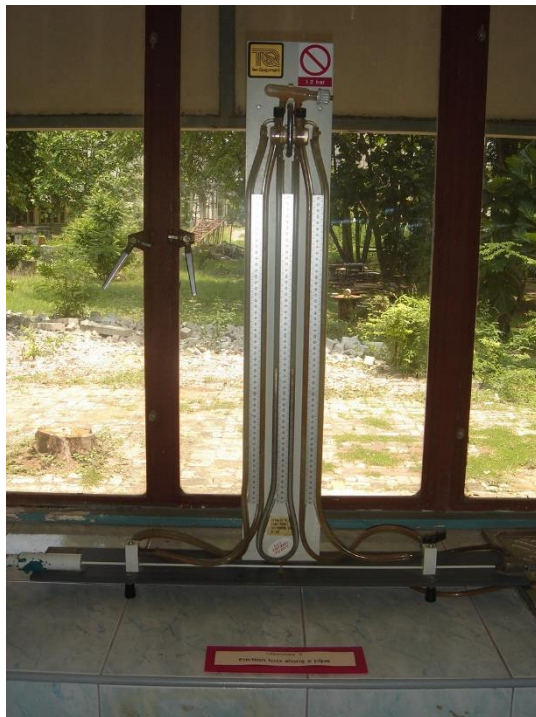
รูปที่ 4.58 Friction Loss Along a Pipe (ตำแหน่งการจัดวางตามผังห้องปฏิบัติการตำแหน่งที่ 9)
