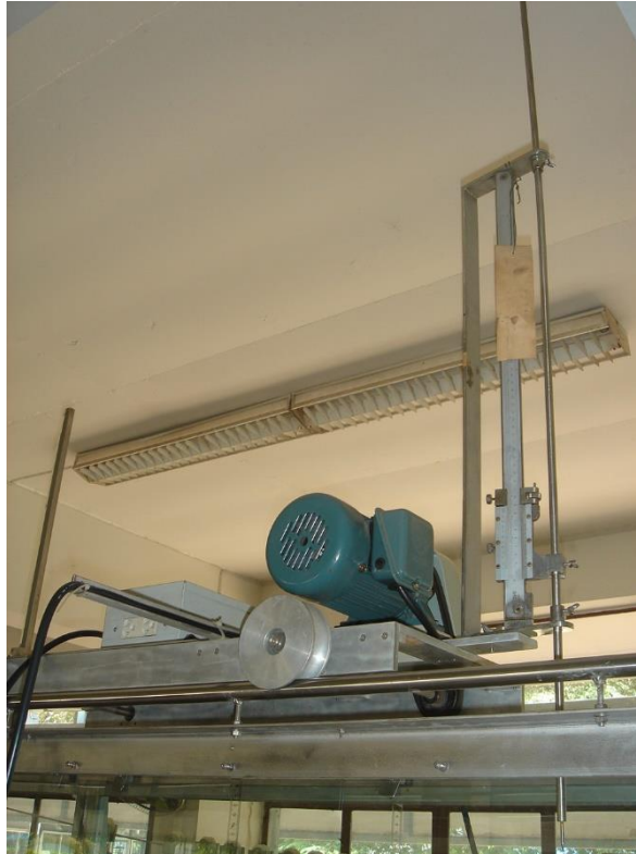
รูปที่ 4.51 Hook Gauge (ตำแหน่งการจัดวางตามผังห้องปฏิบัติการตำแหน่งที่ 1)
