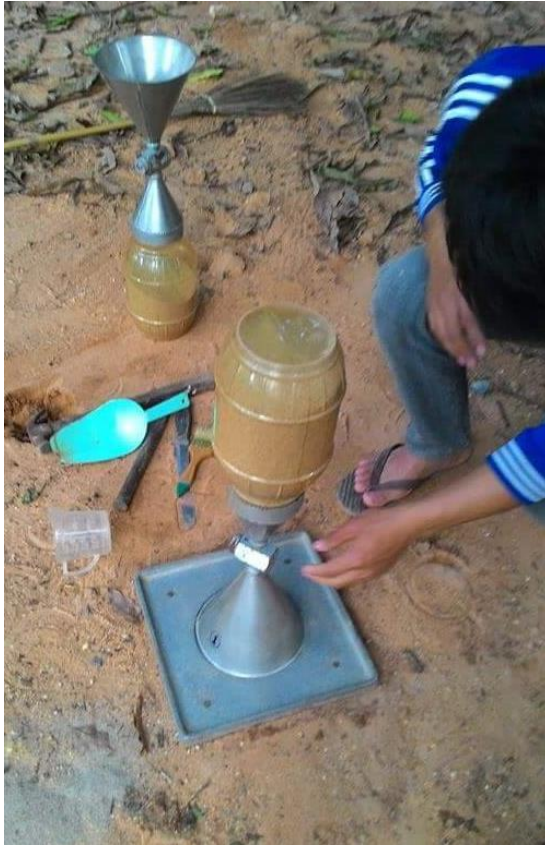
รูปที่ 4.38 การทดสอบความหนาแน่นในสนาม
