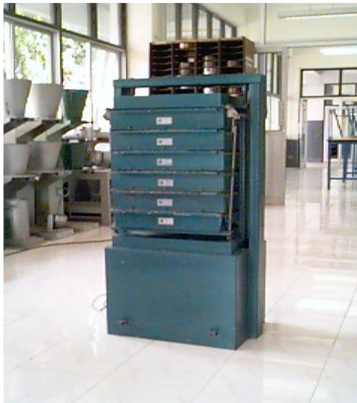
รูปที่ 4.14 Coarse Aggregate Shaker (ตำแหน่งการจัดวางตามผังห้องปฏิบัติการตำแหน่งที่ 17)
