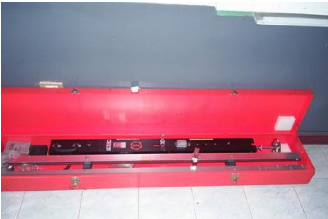
รูปที่ 4.77 Benkelman Beam in Metric (ตำแหน่งการจัดวางตามผังห้องปฏิบัติการตำแหน่งที่ 16)
