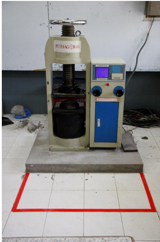
รูปที่ 4.7 เครื่องทดสอบแรงอัดของคอนกรีต (ตำแหน่งการจัดวางตามผังห้องปฏิบัติการตำแหน่งที่ 3)
