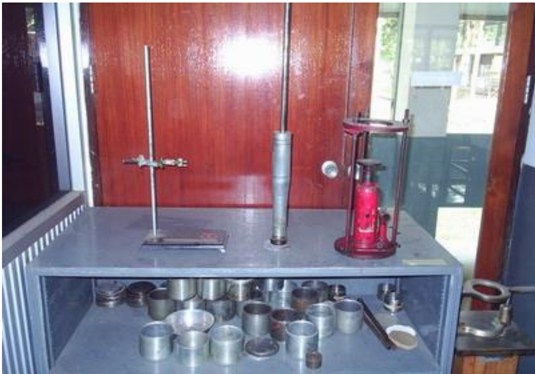
รูปที่ 4.79 Asphalt Compaction Mould (ตำแหน่งการจัดวางตามผังห้องปฏิบัติการตำแหน่งที่ 18)
