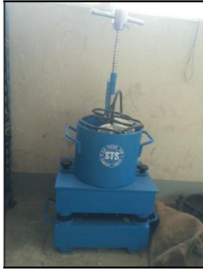
(ป) ชุดทดสอบวัดระยะเวลาที่ใช้ในการเซ้าด้วยเครื่องวีบี
