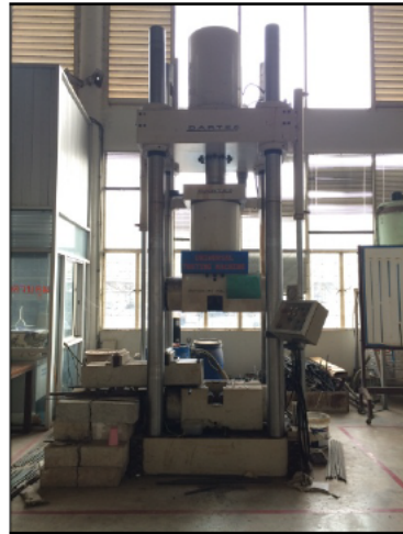
(ค) ชุดทดสอบเอนกประสงค์ขนาด 100 ตัน (UTM)
