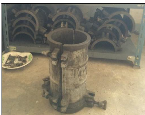
(จ) แบบหล่อลูกบาศก์ขนาด Ø15x30 ซม.
