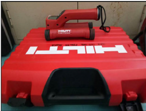
(ช) เครื่องตรวจหาเหล็กเสริมในคอนกรีต
