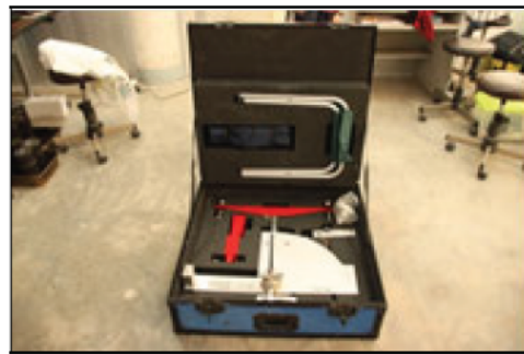
(ข) เครื่อง PORTABLE SKID RESISTANCE
