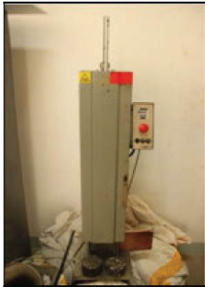
(ซ) เครื่อง MARSHALL COMPACTOR
