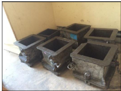
(ง) แบบหล่อลูกบาศก์ขนาด 15x15x15 ซม.
