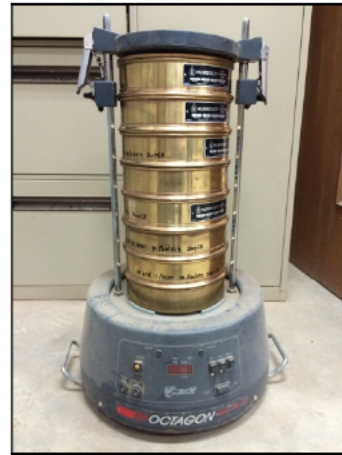
(ง) ชุดทดสอบการหาขนาดเม็ดดิน (วิธีตะแกรงร่อน)
