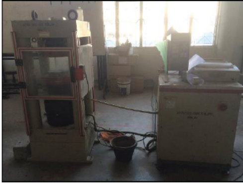
(ฉ1) ชุดทดสอบหากำลังรับแรงอัด
