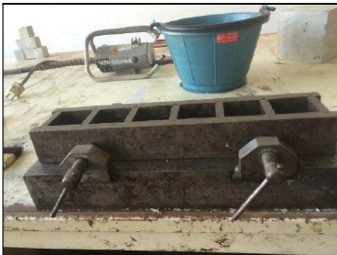
(ค) แบบหล่อลูกบาศก์ขนาด 5x5x5 ซม.
