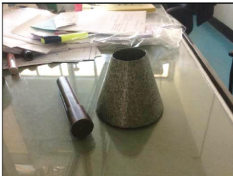
(จ) ชุดทดสอบหาค่าความถ่วงจำเพาะ และการดูดซึมของทราย
