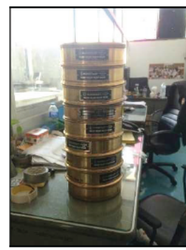
(ฐ) ชุดทดสอบหาขนาดคละของมวลรวม (ละเอียด)
