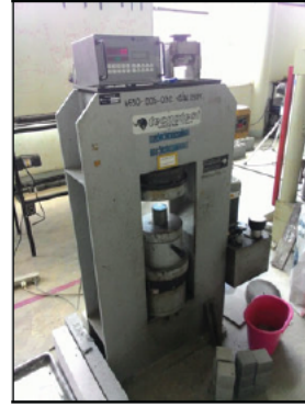
(ฉ2) ชุดทดสอบหากำลังรับแรงอัด
