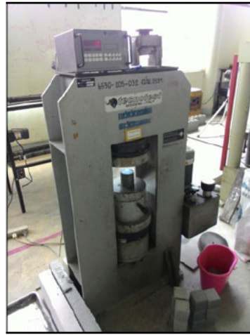
(ก2) เครื่องทดสอบแรงอัดและแรงดึง 200 ตัน (ใช้ร่วมกับปฏิบัติการทดสอบคอนกรีต)
