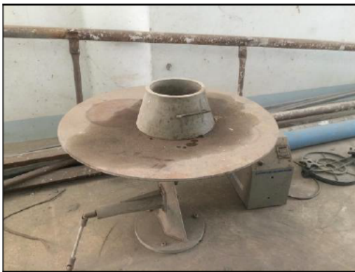
(ผ) ชุดทดสอบหาค่าการไหลแผ่ของคอนกรีต
