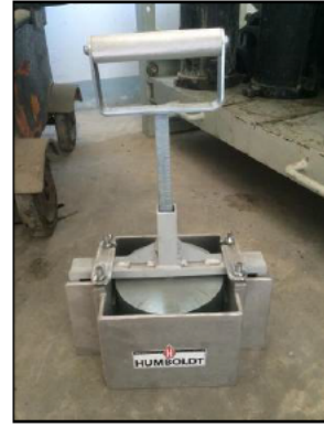
(ผ) เครื่องทดสอบการวัดระยะเวลาการจมของลูกบอลเคลลี
