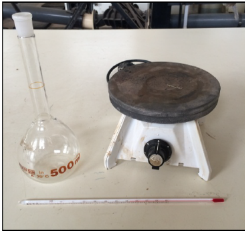
(ค) ชุดทดสอบความถ่วงจำเพาะของเม็ดดิน
