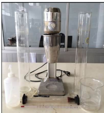
(จ) ชุดทดสอบการหาขนาดเม็ดดิน (วิธีไฮโดรมิเตอร์)
