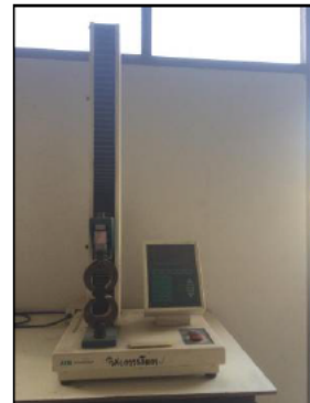
(ซ) เครื่องทดสอบหาค่ากำลังรับแรงดึงของมอร์ตาร์
