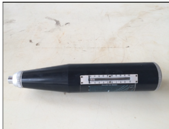
(จ) ชุดทดสอบกำลังของคอนกรีตแบบไม่ทำลาย
