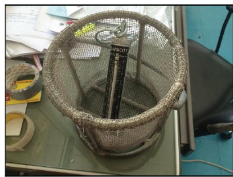
(ฉ) ชุดทดสอบหาค่าความถ่วงจำเพาะ และการดูดซึมของมวลรวมหยาบ
