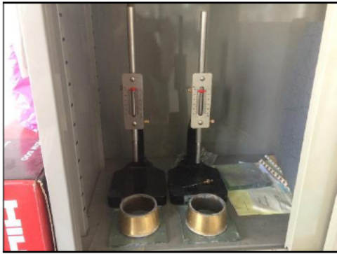
(ก) ชุดทดสอบความชื้นเหลวปกติ และระยะการก่อตัวของซีเมนต์เพสต์โดยใช้เข็มแบบไวแคต
