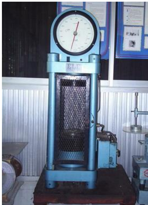
รูปที่ 4.16 Hand-Operated Standard Compression Machines แบบ 100 ตัน และ แบบ Digital ระบบไฟฟ้า 200 ตัน (ตำแหน่งการจัดวางตามผังห้องปฏิบัติการตำแหน่งที่ 21)
