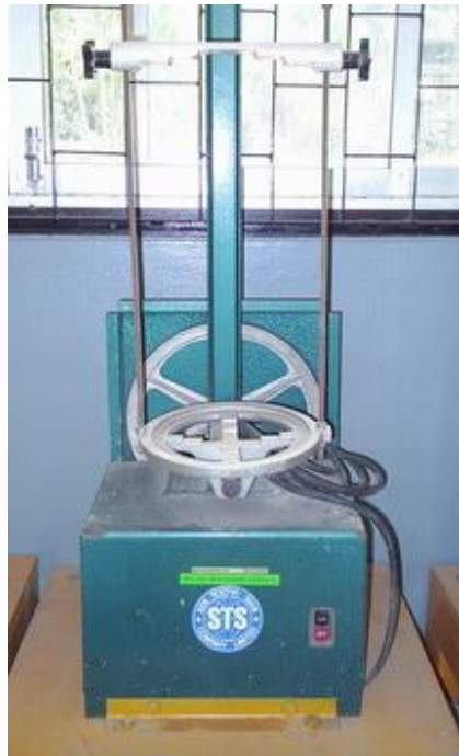
รูปที่ 4.5 Sieve Shaker (ตำแหน่งการจัดวางตามผังห้องปฏิบัติการตำแหน่งที่ 1)
