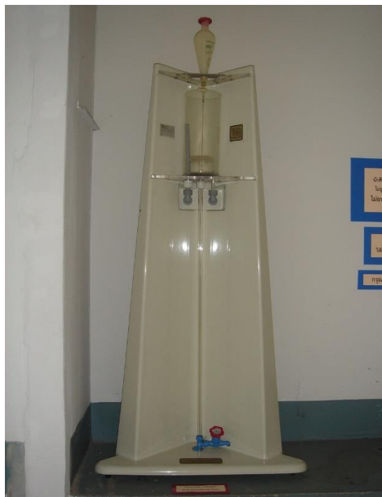
รูปที่ 4.52 Reynolds Number and Transition (ตำแหน่งการจัดวางตามผังห้องปฏิบัติการตำแหน่งที่ 2)
