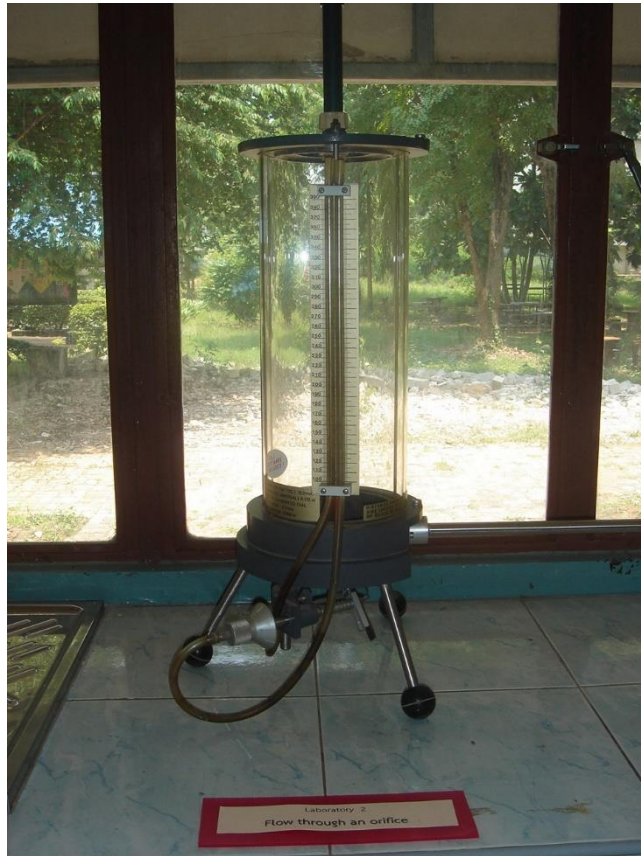
รูปที่ 4.55 Flow Through an Orifice (ตำแหน่งการจัดวางตามผังห้องปฏิบัติการตำแหน่งที่ 6)
