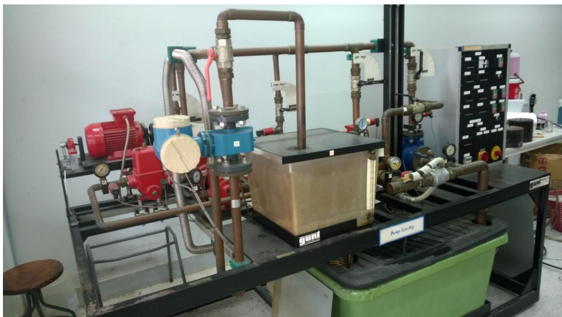
รูปที่ 4.64 ชุดทดสอบ Series and parallel pump (ตำแหน่งการจัดวางตามผังห้องปฏิบัติการตำแหน่งที่ 15)
