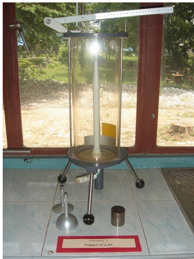
รูปที่ 4.60 Impact of a Jet (ตำแหน่งการจัดวางตามผังห้องปฏิบัติการตำแหน่งที่ 11)
