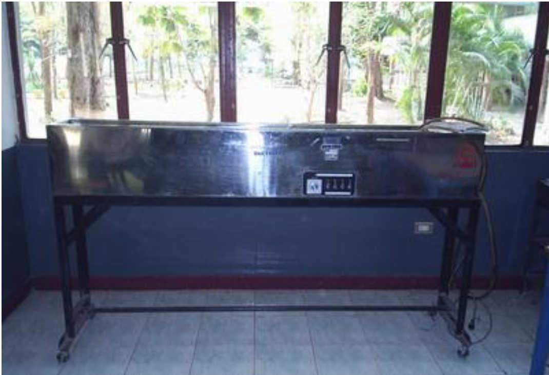
รูปที่ 4.74 Ductility Testing Machine (MIA.452-0-03) MARUI (ตำแหน่งการจัดวางตามผังห้องปฏิบัติการ ตำแหน่งที่ 10)
