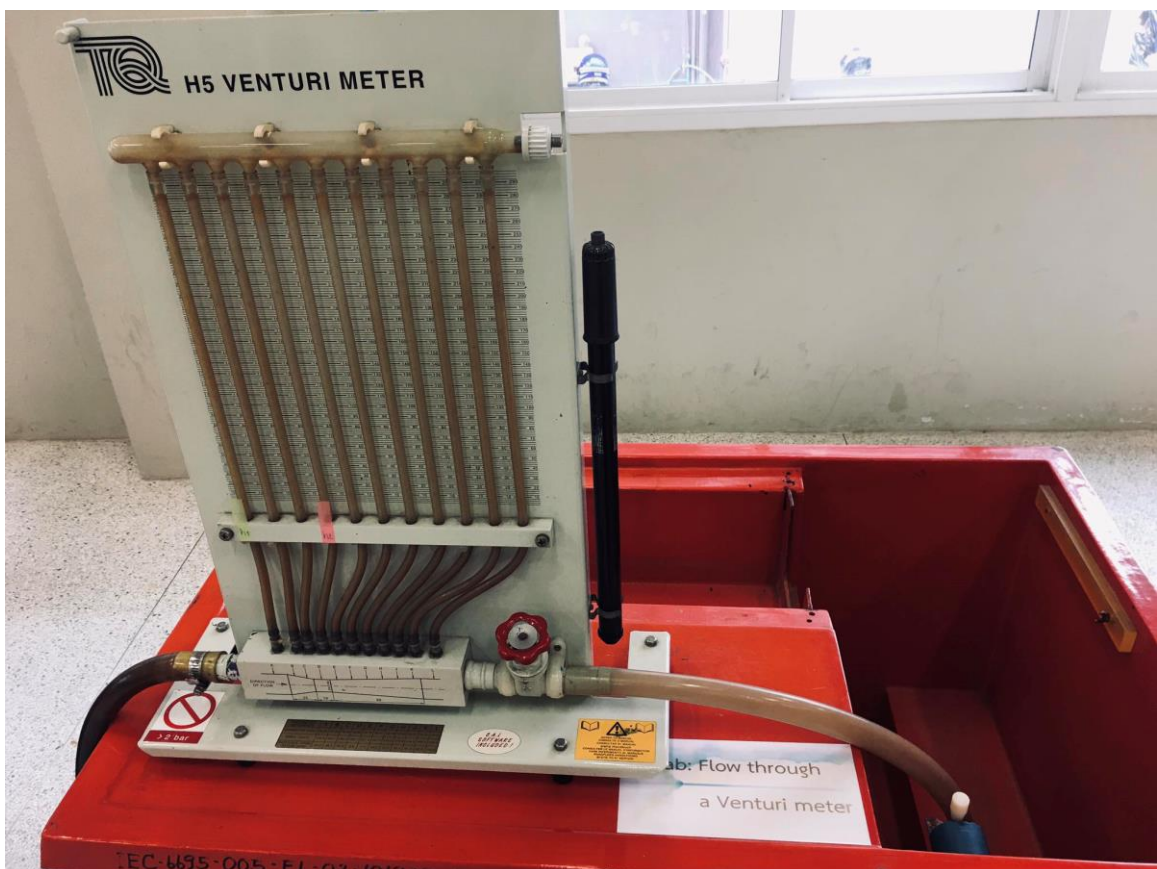
รูปที่ 4.62 Flow Through a Venturi Meter (ตำแหน่งการจัดวางตามผังห้องปฏิบัติการตำแหน่งที่ 14)
