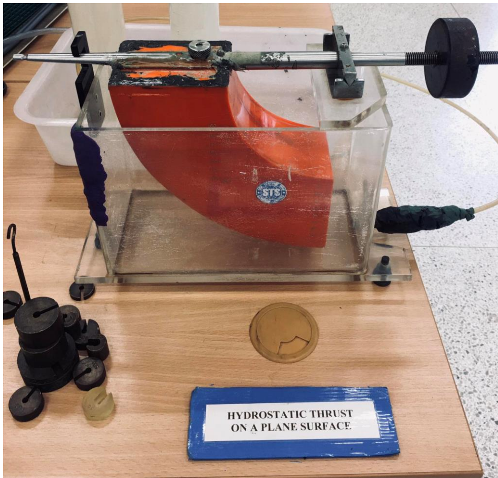
รูปที่ 4.56 Hydrostatic Thrust on a Plane Surface (ตำแหน่งการจัดวางตามผังห้องปฏิบัติการตำแหน่งที่ 7)
