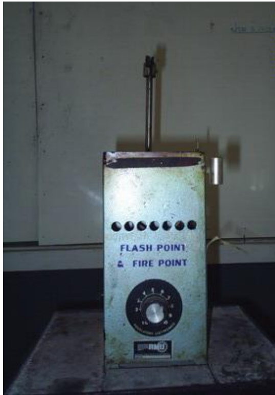
รูปที่ 4.72 Flash Point and Fire Point Tester (ตำแหน่งการจัดวางตามผังห้องปฏิบัติการตำแหน่งที่ 7)
