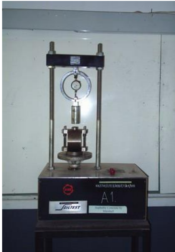
รูปที่ 4.78 Marshall At Ability Test Equipment (ตำแหน่งการจัดวางตามผังห้องปฏิบัติการตำแหน่งที่ 17)
