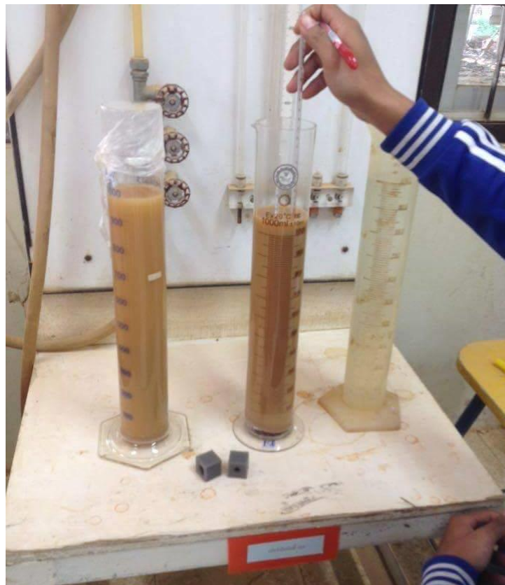
รูปที่ 4.35 การหาขนาดของเม็ดดินด้วยตะแกรงร้อนและไฮโดรมิเตอร์
