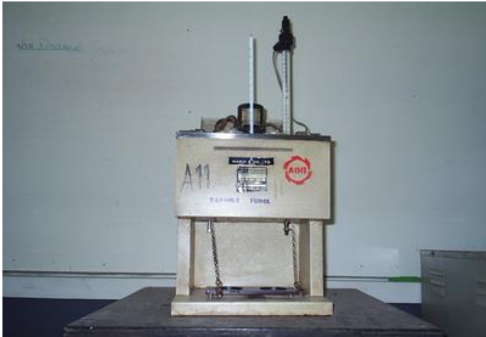
รูปที่ 4.70 Basic Viscometer Set Sayboul (ตำแหน่งการจัดวางตามผังห้องปฏิบัติการตำแหน่งที่ 5)
