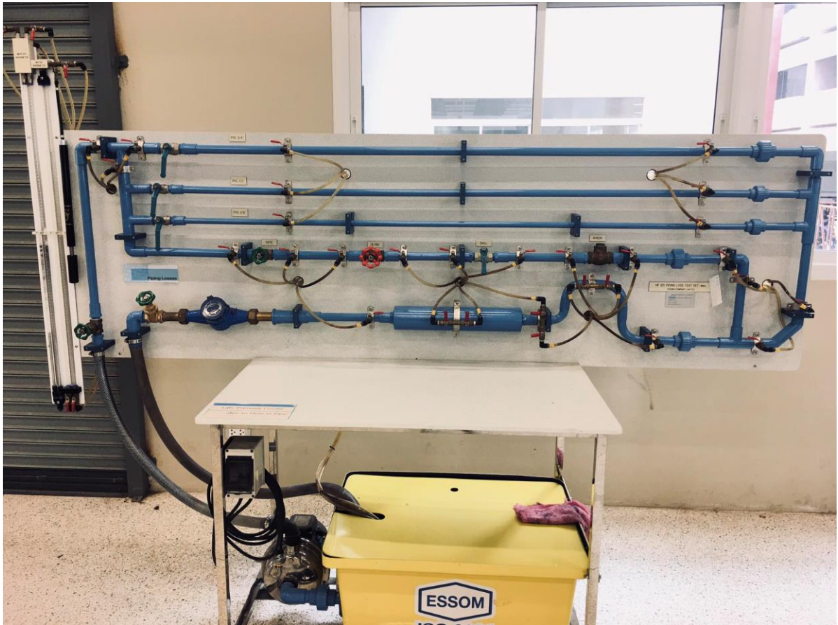
รูปที่ 4.65 ชุดทดสอบ Pressure Losses due to Flow in Pipe (ตำแหน่งการจัดวางตามผังห้องปฏิบัติการ ตำแหน่งที่ 16)
