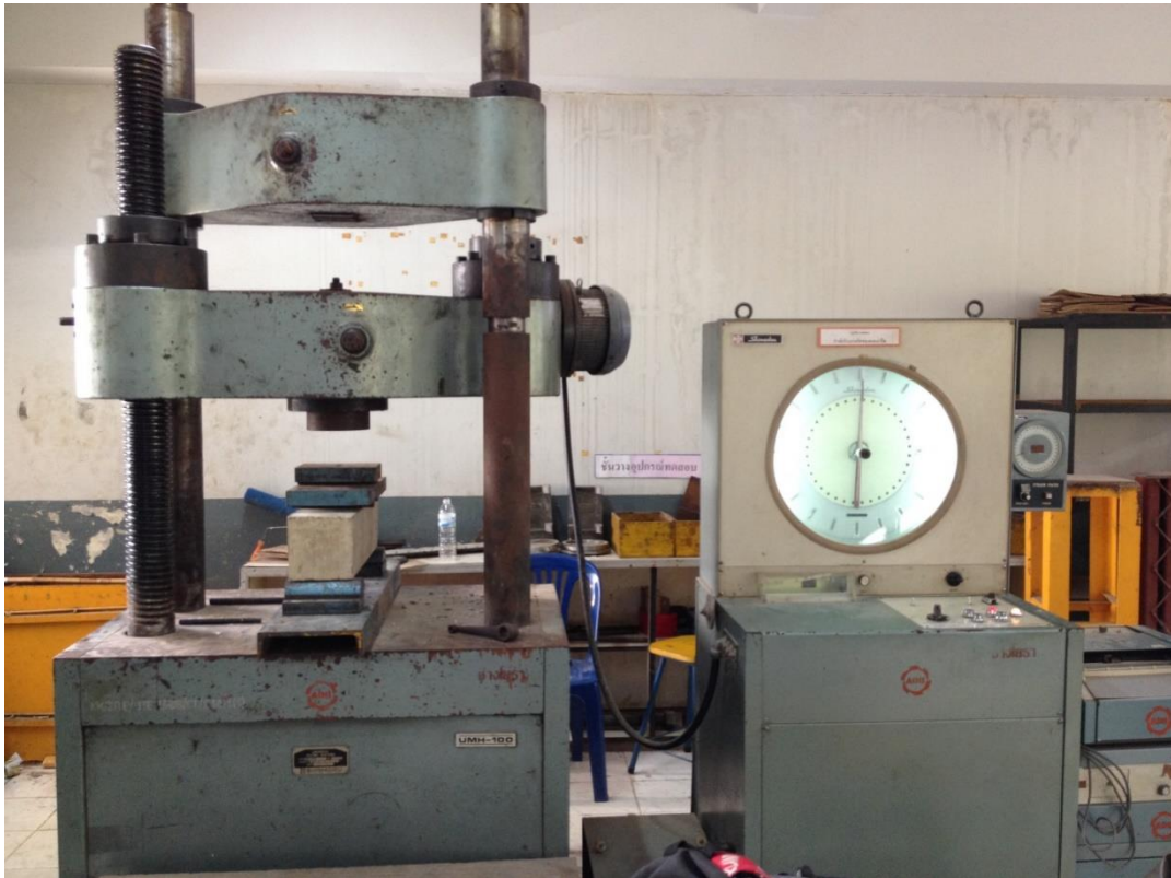
รูปที่ 4.48 Universal Testing (UMH-100) (ตำแหน่งการจัดวางตามผังห้องปฏิบัติการตำแหน่งที่ 17)
