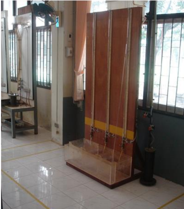
รูปที่ 4.40 การทดสอบสัมประสิทธิ์การซึมผ่าน
