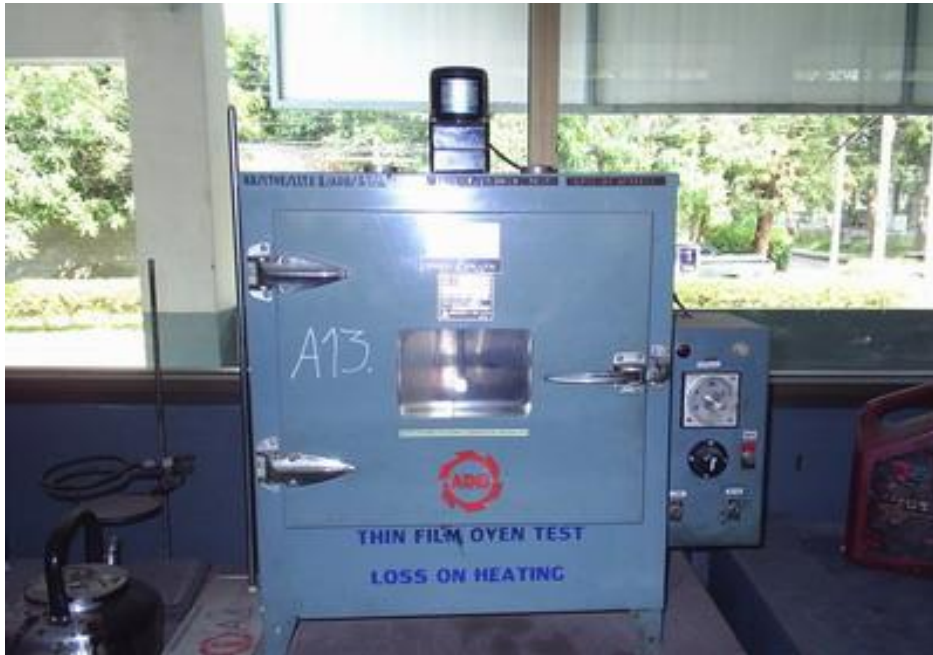
รูปที่ 4.68 Asphalt Oven Revolving Shelf (ตำแหน่งการจัดวางตามผังห้องปฏิบัติการตำแหน่งที่ 2)
