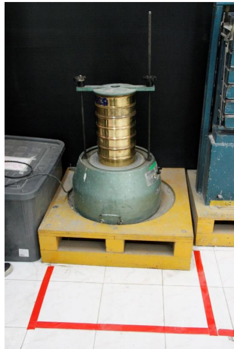
รูปที่ 4.5 Sieve Shaker (ตำแหน่งการจัดวางตามผังห้องปฏิบัติการตำแหน่งที่ 1)
