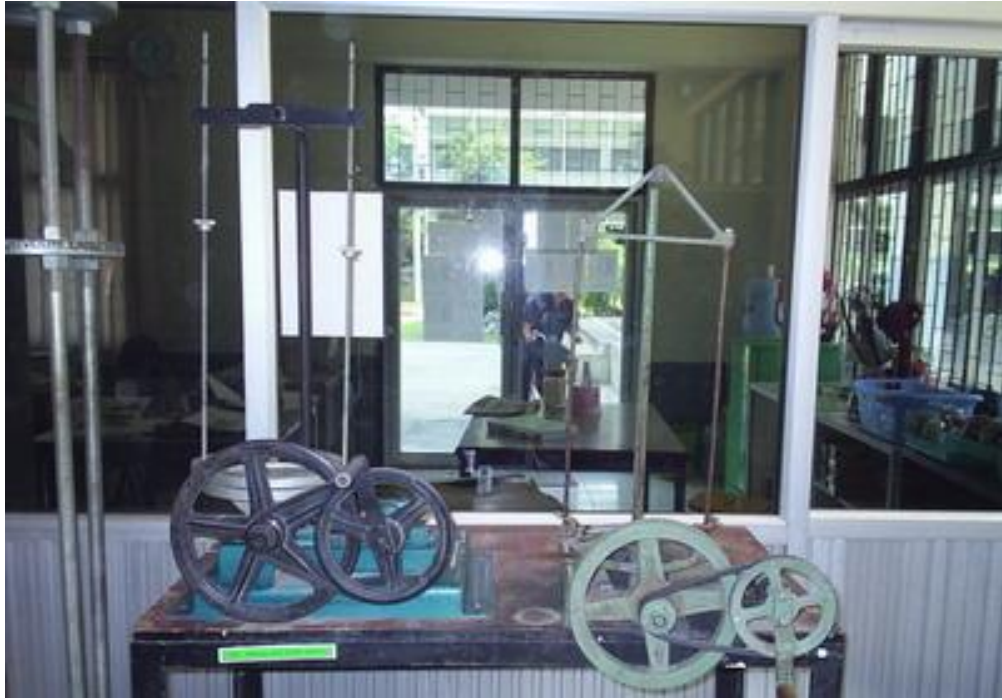
รูปที่ 4.15 Hand-Operated Sieve Shaker (ตำแหน่งการจัดวางตามผังห้องปฏิบัติการตำแหน่งที่ 19, 20.)
