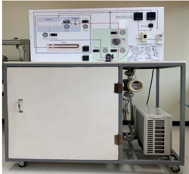
รูปที่ 23 ชุดปฏิบัติการจำลองการทำงานของระบบทำความเย็นและระบบปรับอากาศ
