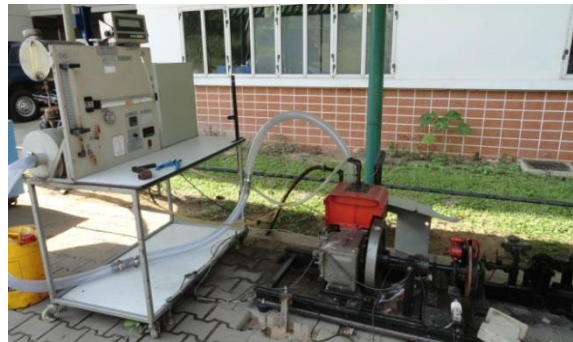
รูปที่ 18 ชุดปฏิบัติการทดสอบเครื่องจักรกลต้นกำลังสำหรับเครื่องยนต์สูบเดี่ยว
