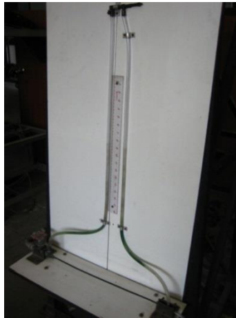
รูปที่ 1 Friction Loss in Pipe
