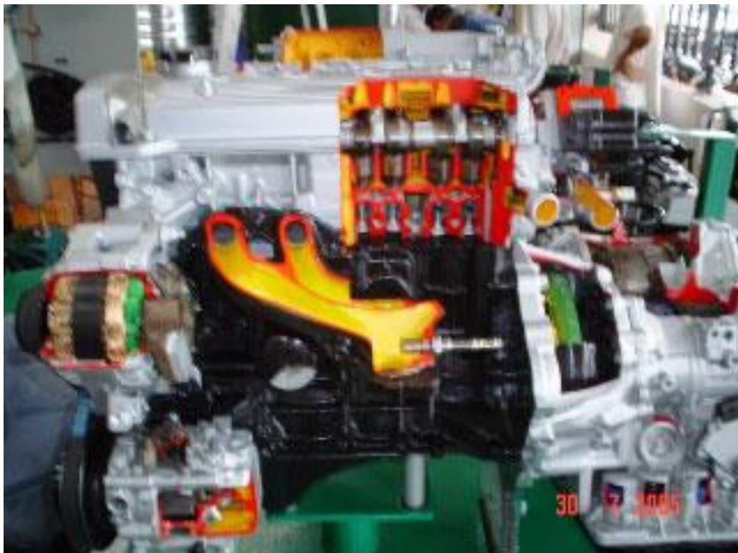
7.4ชุดทดสอบเครื่องยนต์แก๊สโซลีนผ่า
