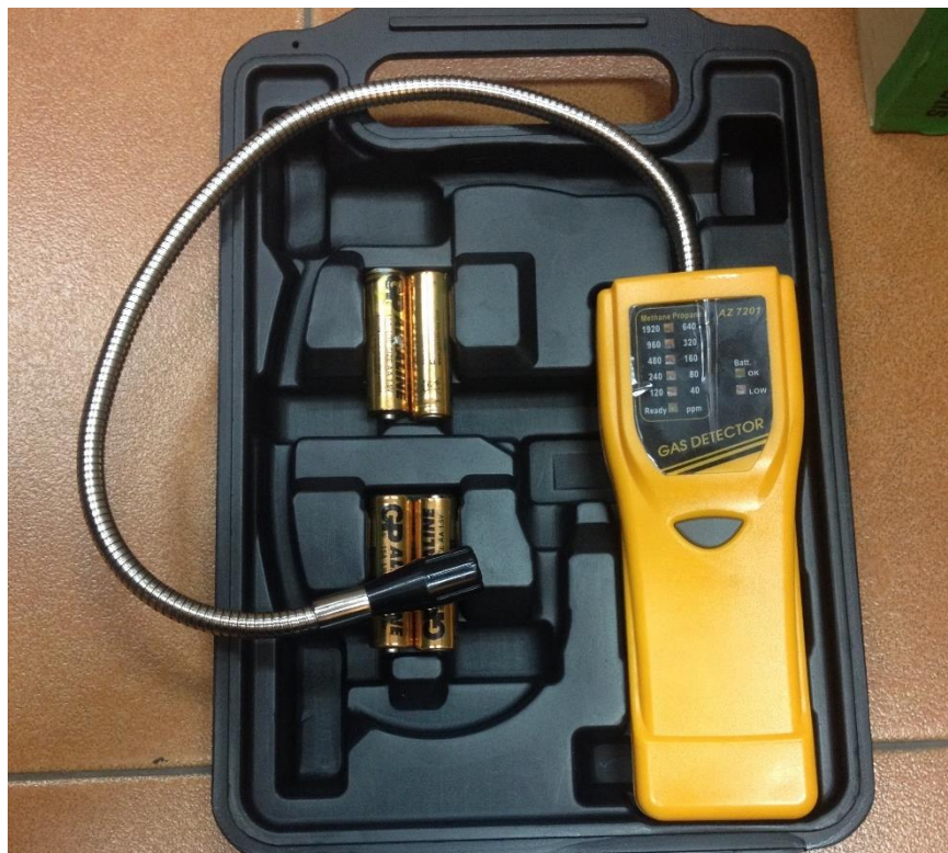
7.18 เครื่องตรวจวัดแก๊ส(Gas Detector)
