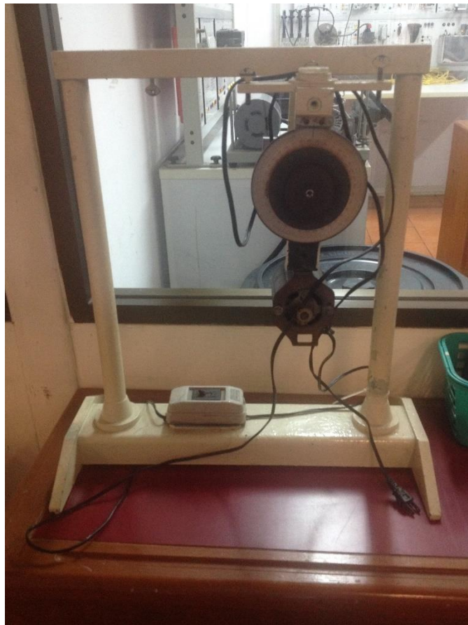
4.7 เครื่องทดสอบ Dynamic Balance
