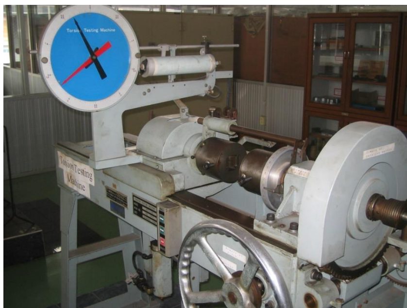
4.3 เครื่องทดสอบความเค้นบิดของวัสดุ
