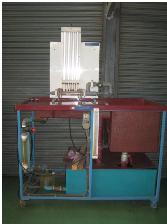
3.3ชุดทดลองการไหลในท่อ Venturi
