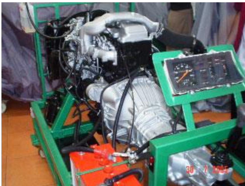
7.1ชุดทดสอบเครื่องยนต์ดีเซล
