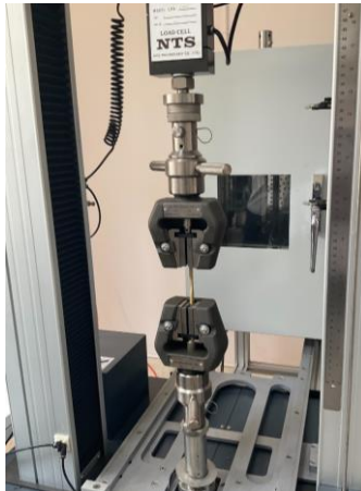
รูปที่ 10 ติดตั้งชิ้นงานไม้ไผ่เข้ากับเครื่องทดสอบสมบัติทางกลแบบอเนกประสงค์
