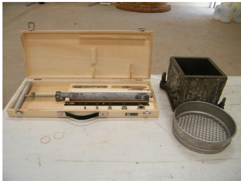
(9) ชุดทดสอบเวลาการก่อตัวของคอนกรีต
