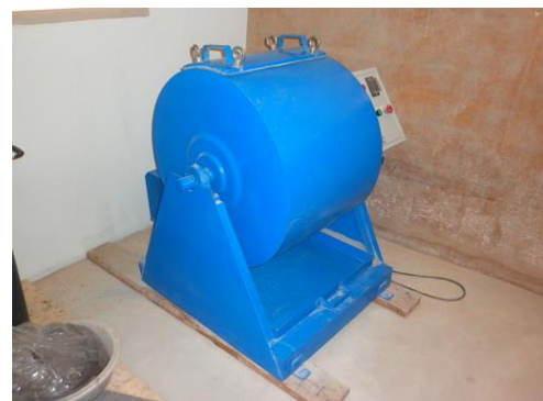
(6) ชุดทดสอบการสึกหรอของวัสดุรวมรวมโดย
