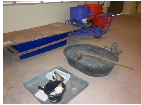
(8) ชุดทดสอบการหาค่าการยุบตัวของคอนกรีต
