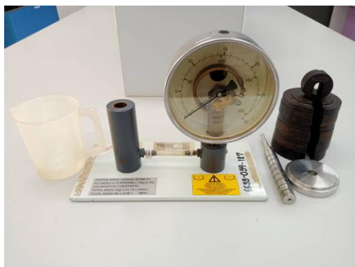
(1) การสอบเทียบเครื่องมือวัดความดัน
