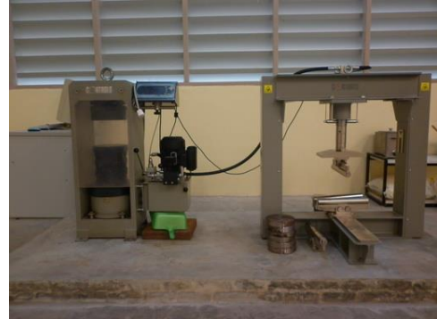
(2) เครื่องทดสอบแรงอัดและแรงดึง 200 ตัน (ใช้ร่วมกับปฏิบัติการทดสอบคอนกรีต)
