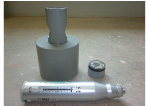
(4) ชุดทดสอบกำลังของคอนกรีตแบบไม่ทำลาย
