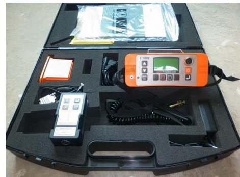
(6) ชุดหาเหล็กเสริมในโครงสร้างคอนกรีต
