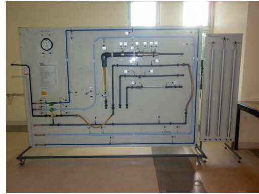
(8) การสูญเสียจากแรงเสียดทานของการไหล ในท่อ
