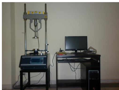
(8) ชุดทดสอบแคลิฟอร์เนีย แบริงเรโซ (CBR)
