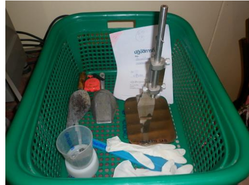
(2) ชุดทดสอบขีดจำกัดความชื้นเหลวปกติของ
