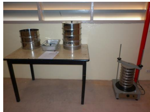
(12) ชุดทดสอบการวิเคราะห์ขนาดของมวลรวมละเอียดและหยาบโดยวิธีร้อนผ่านตะแกรง
