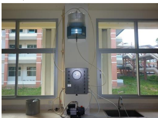
(5) ชุดทดสอบการซึมน้ำของดิน
