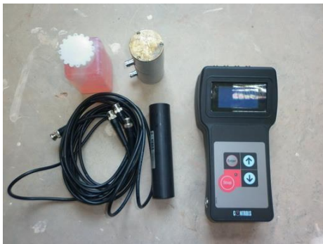
(5) ชุดอัลตราโซนิกสำหรับทดสอบคอนกรีต
