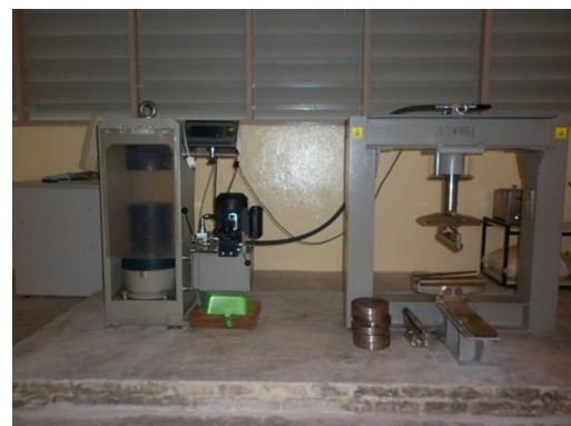
(14) ชุดทดสอบกำลังอัดและดัดของคอนกรีต
