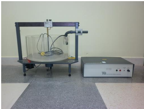
(9) การไหลวนแบบบังคับและอิสระ
