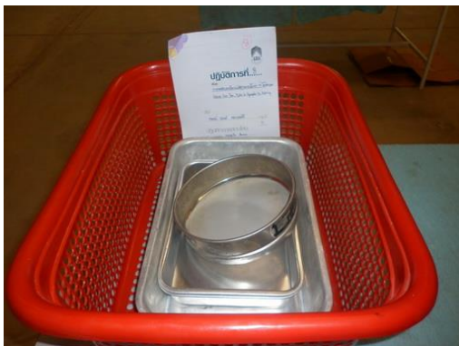
(11) ชุดทดสอบปริมาณวัสดุขนาดเล็กกว่า 75 ไมโครเมตร
