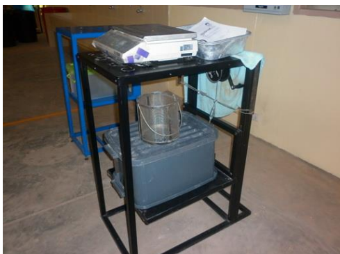
(5) ชุดสอบค่าความถ่วงจำเพาะของวัสดุรวมรวม
