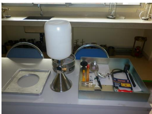
(7) ชุดทดสอบการหาความหนาแน่นของดินในสนาม
