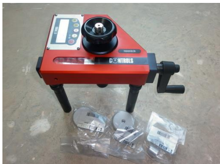
(7) ชุดหาแรงยึดเหนี่ยวของคอนกรีต
