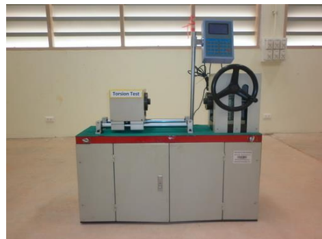
(8) ชุดทดสอบแรงบิด (อาคารปฏิบัติการวิศวกรรมเครื่องกล)
