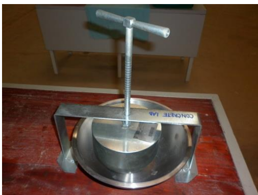
(13) ชุดทดสอบการจมของลูกบอลเคลลี่
