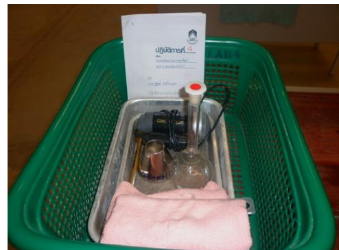
(4) ชุดทดสอบค่าความถ่วงจำเพาะของวัสดุรวม
