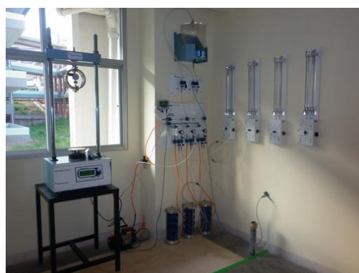
(12) ชุดทดสอบ Triaxial Test
