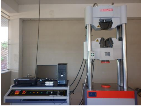
(1) เครื่องทดสอบแรงกดขนาด 100 ตัน (UTM)
