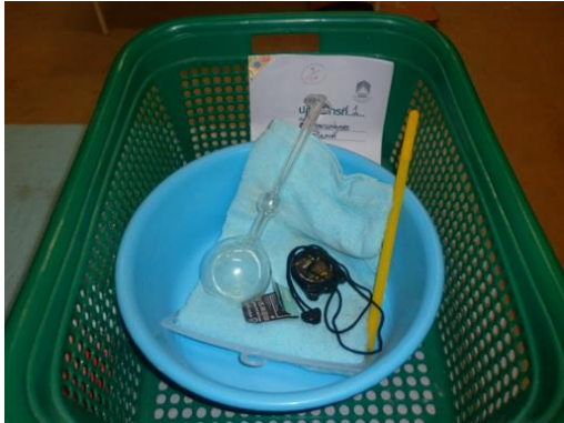
(1) ชุดทดสอบค่าความถ่วงจำเพาะของซีเมนต์
