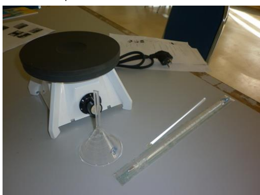
(3) ชุดทดสอบความถ่วงจำเพาะของเม็ดดิน
