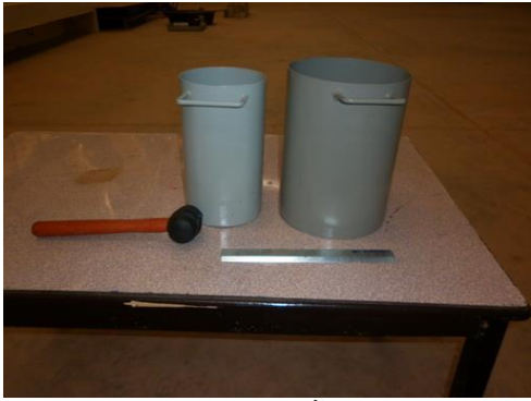
(7) ชุดทดสอบหาค่าหน่วยน้ำหนักของคอนกรีต
