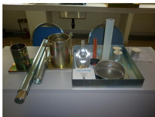
(6) ชุดทดสอบการบดอัดดิน
