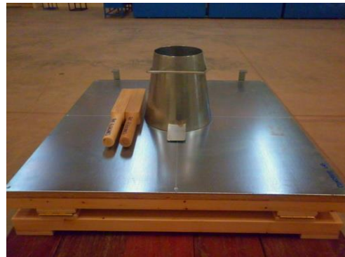
(10) ชุดทดสอบโตะการไหล
