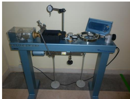
(10) ชุดทดสอบ Direct Shear Test
