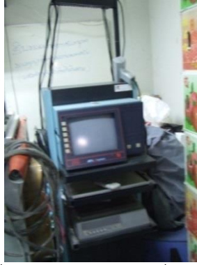
รูปที่ 14 เครื่องวิเคราะห์สภาพเครื่องยนต์แก๊สโซลีน
