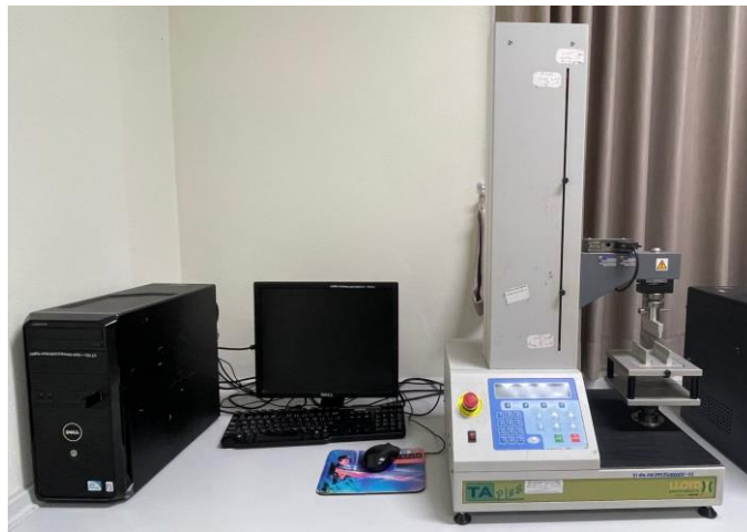
รูปที่ 46 เครื่องทดสอบ Modulus of rupture of Ceramic
